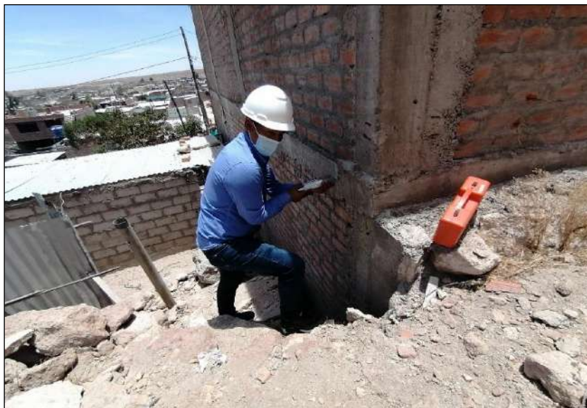
Figura 19. Ensayo del esclerómetro vivienda 5, en la Asociación de APIPA sector XV, distrito de Cerro Colorado.
