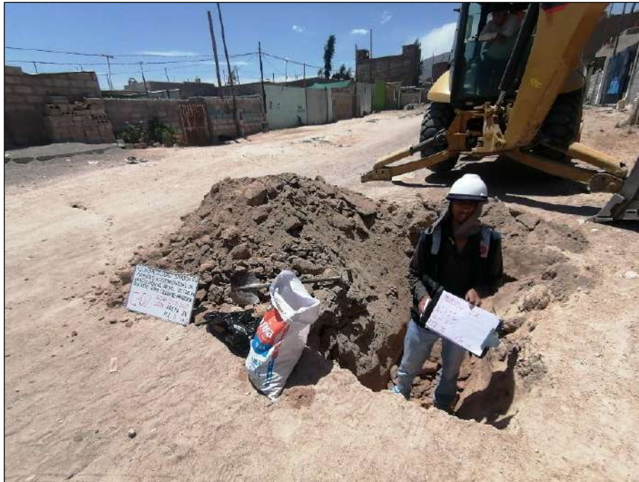
Figura 24. Muestras de la calicata C - 2, en la Asociación de APIPA sector XV, distrito de Cerro Colorado.
