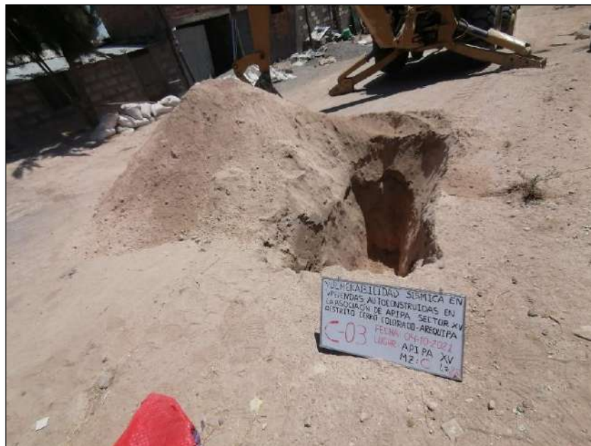
Figura 25. Muestras de la calicata C - 3, en la Asociación de APIPA sector XV, distrito de Cerro Colorado.
