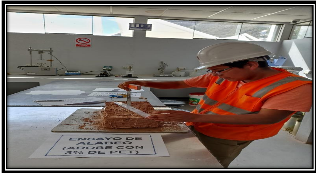
Figura 83. Medición del alabeo del adobe con 3 % de tiras de PET.
