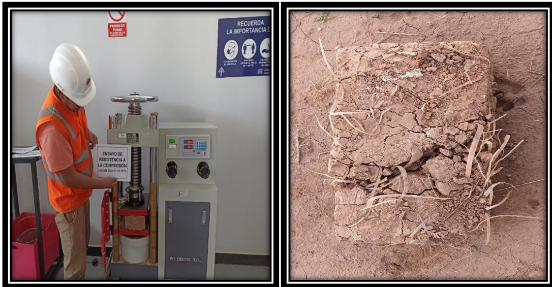
Figura 100. Unidad ensayada de adobe al 3 % de tiras de PET.
