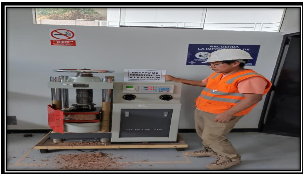
Figura 102. Prueba de resistencia a la flexión del adobe control.
