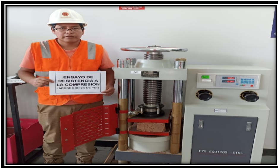
Figura 98. Unidad ensayada de adobe al 1 % de tiras de PET.
