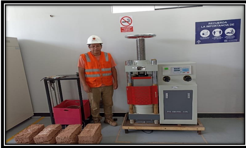
Figura 96. Máquina de compresión y las muestras a ensayar.
