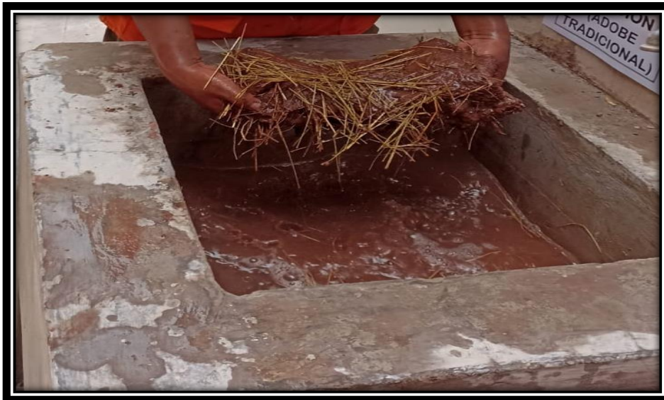
Figura 87. Prueba de absorción, unidad de adobe control y adicionado con tiras de PET se destrozaron completamente antes de 60 minutos.
