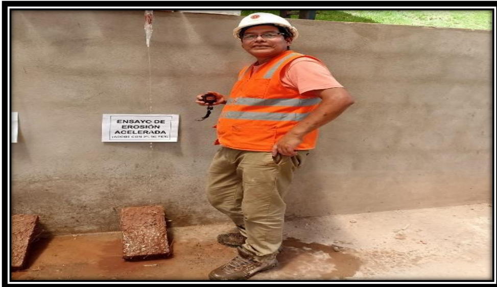
Figura 93. Ensayo de la unidad de adobe al 2 % y 3 % de tiras de PET a un ángulo de 27, en el tiempo de 10 minutos.
