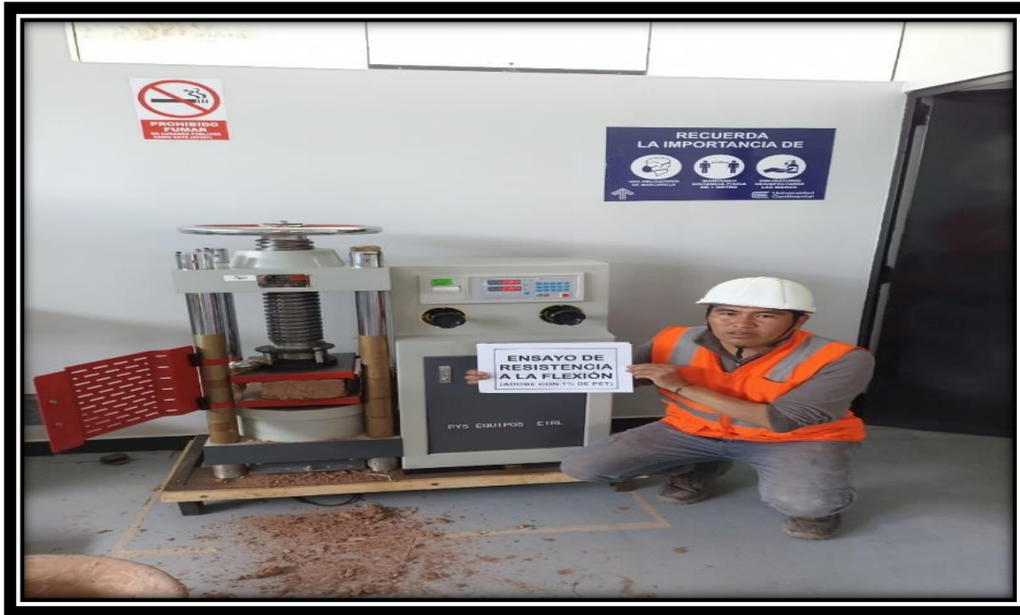
Figura 103. Prueba de la resistencia a la flexión del adobe con el 1 % de tiras de PET.
