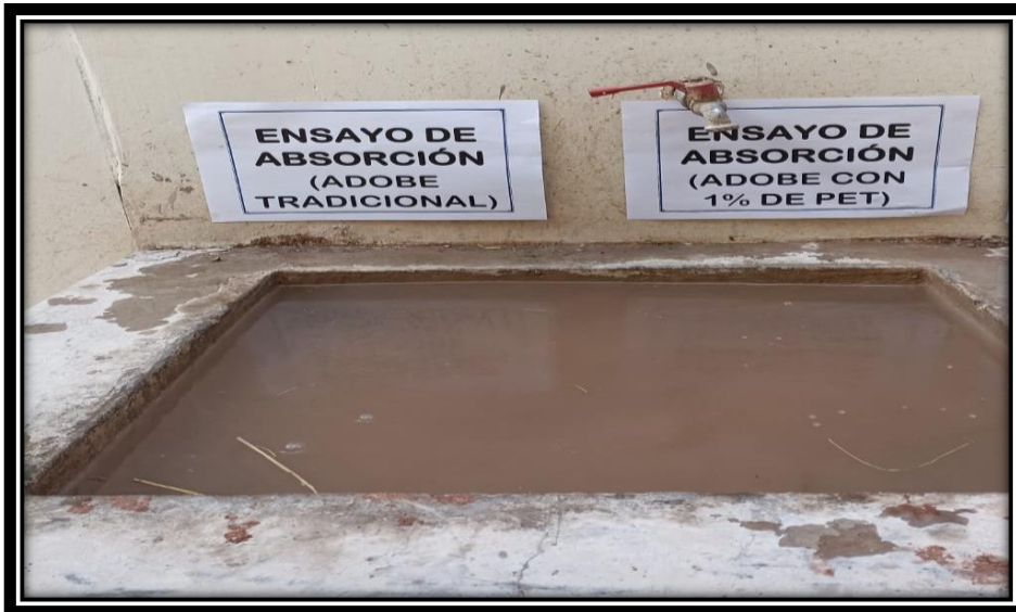
Figura 85. Prueba de absorción de las unidades de adobe control y con 1 % de tiras de PET.
