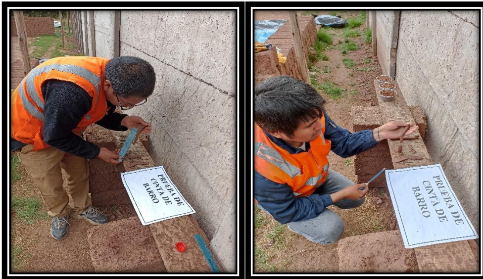
Figura 57. Colgara de la mano, la cinta de barro y se procede a medir.
