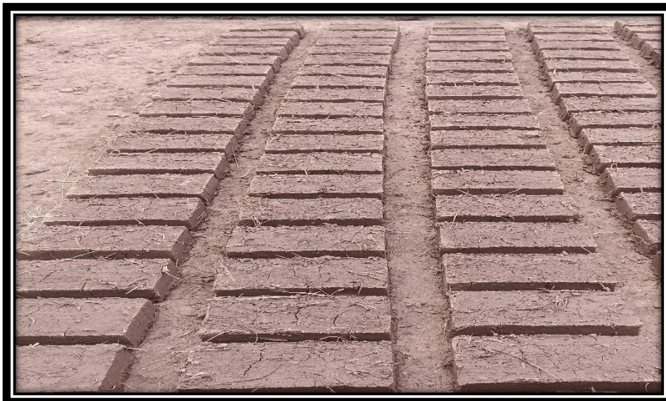
Figura 37. Secado de los adobes con el 1 % de tiras de PET.
