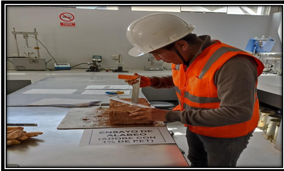
Figura 81. Medición del alabeo del adobe con 1 % de tiras de PET.
