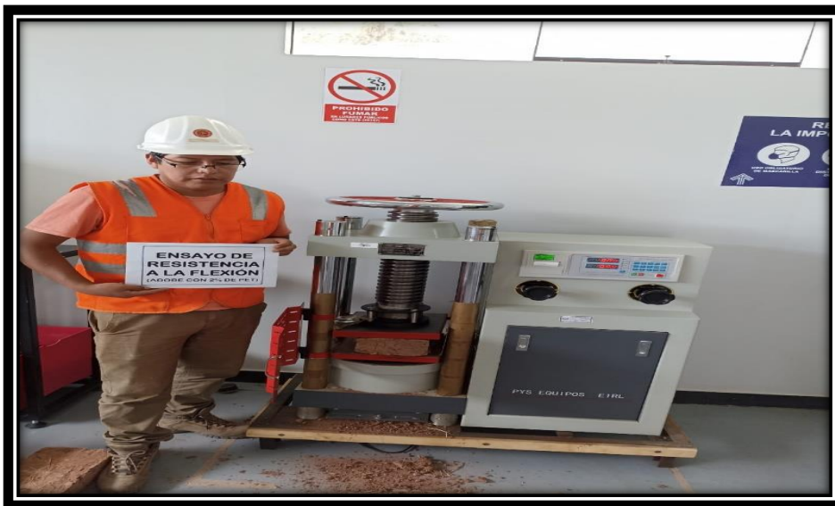
Figura 104. Prueba de resistencia a la flexión del adobe con el 2 % de tiras de PET.
