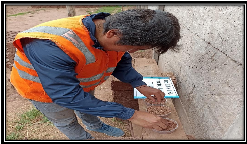
Figura 51. Evaluación de textura de las muestras 1, 2 y 3.
