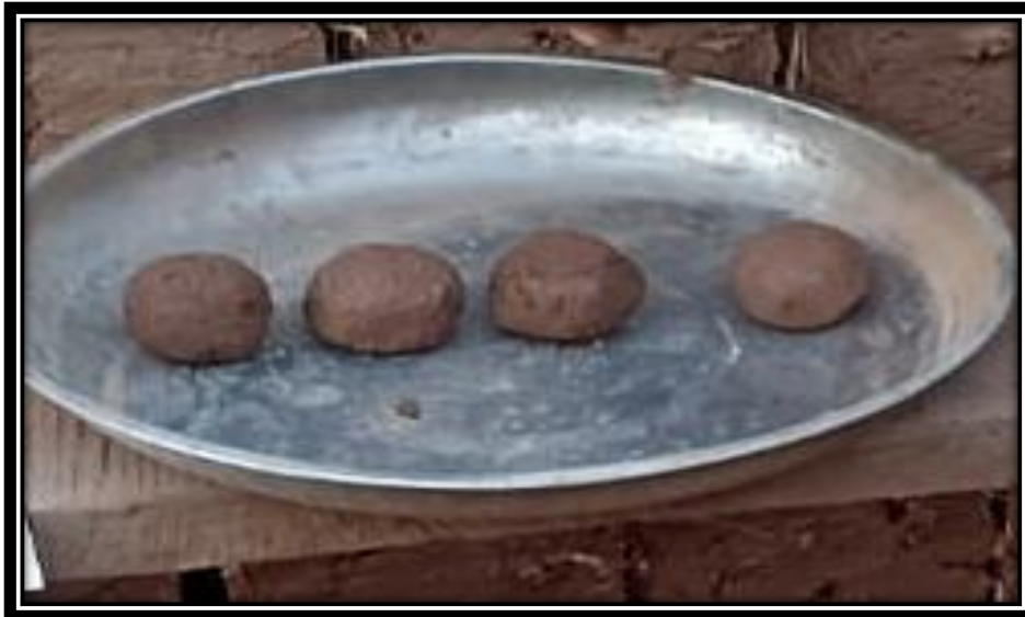
Figura 60. Secado por 48 horas de las 4 bolitas para la prueba.
