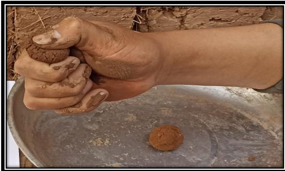
Figura 61. Probando la resistencia de las 4 bolitas.
