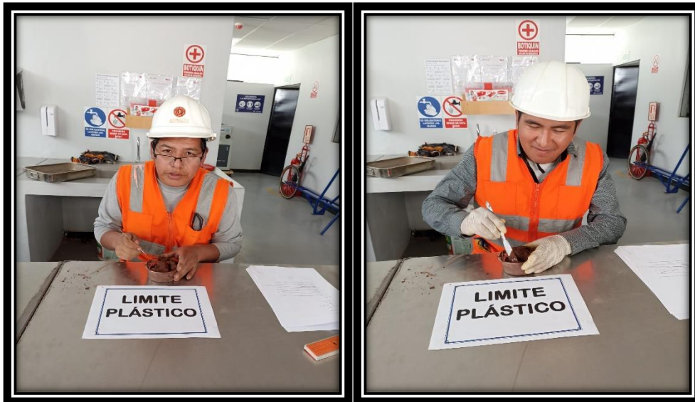
Figura 77. Preparación de la masa.
