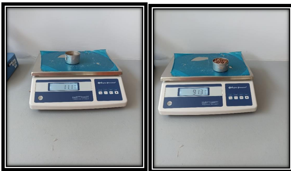
Figura 65. Pesado de la tara vacía y con contenido de la muestra.
