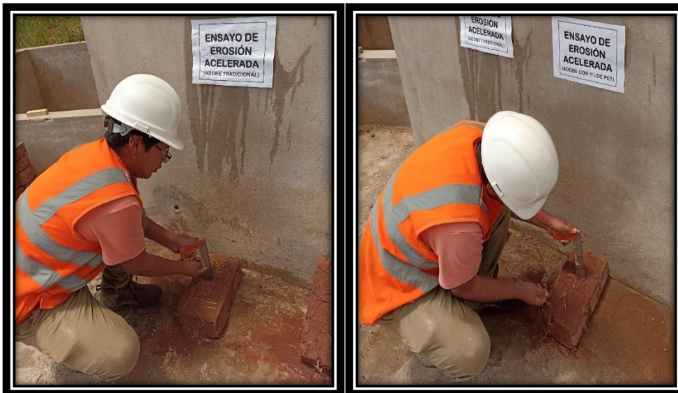
Figura 94. Oquedad del adobe control y 1 % con tiras de PET.
