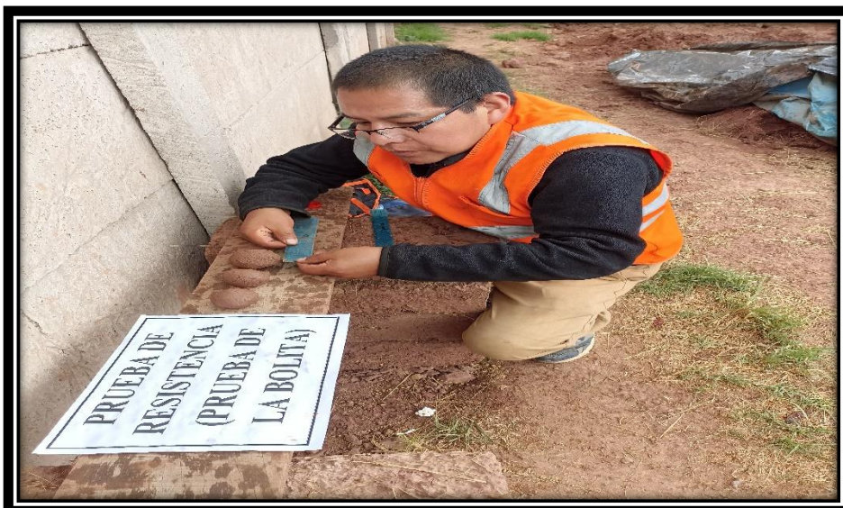
Figura 59. Medir las 4 bolitas de la prueba.
