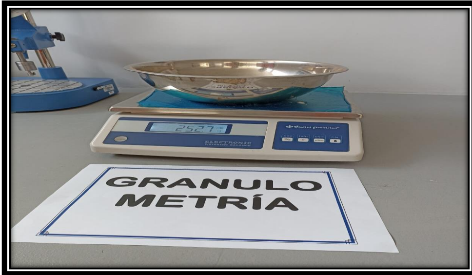
Figura 68. Pesado de la muestra seca sacadas del horno.
