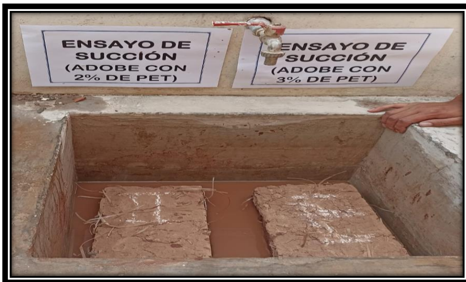
Figura 90. Succión en el adobe con el 2 % y 3 % de tiras de PET sobre las dos cuñas durante 60 segundos.
