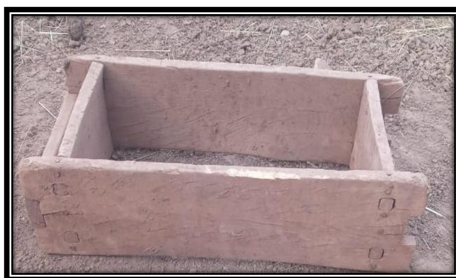
Figura 24. Adobera rectangular a utilizar en el proyecto
