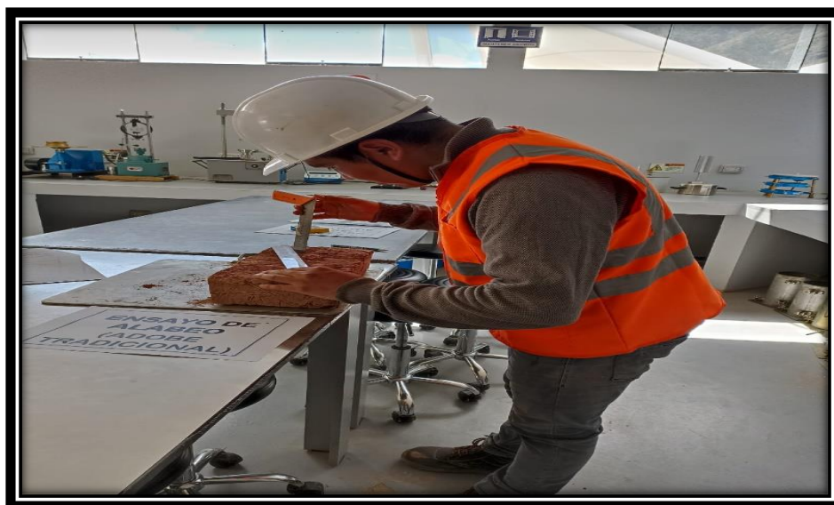
Figura 80. Medición del alabeo del adobe control.
