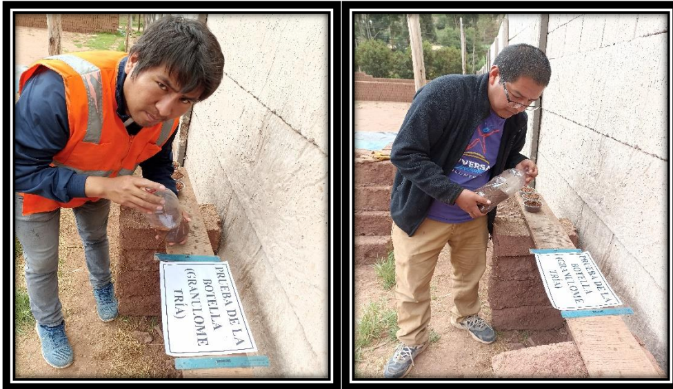
Figura 52. Llenado con tierra, el añadido de agua y finalmente la agitación en la botella descartable.
