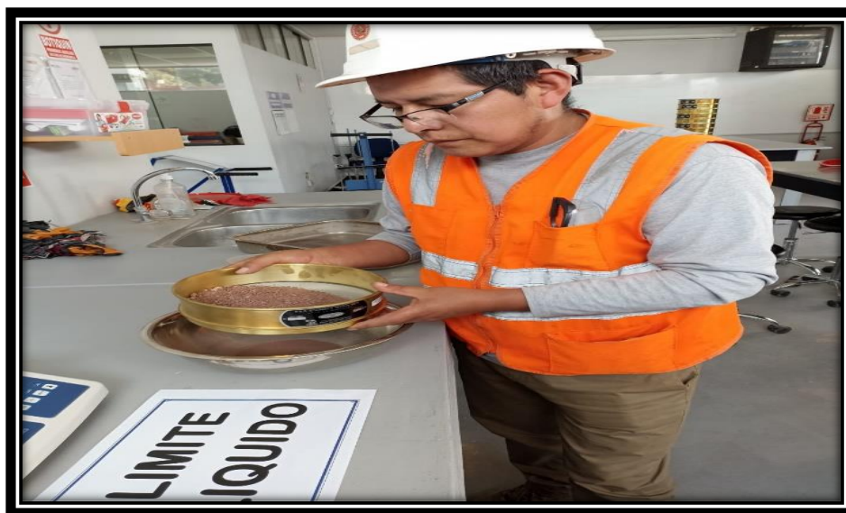
Figura 72. Muestra pasada por el tamiz número 40.
