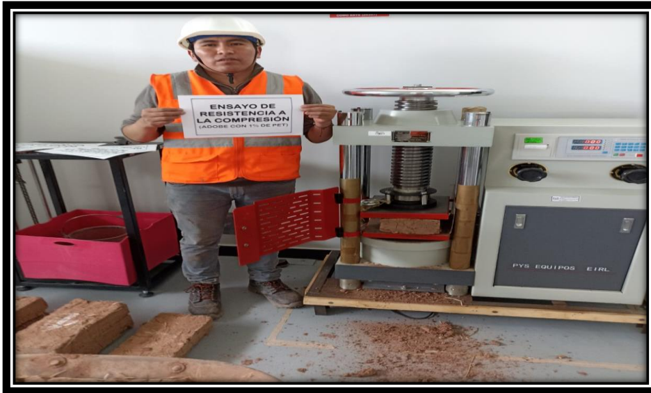
Figura 98. Unidad ensayada de adobe al 1 % de tiras de PET.
