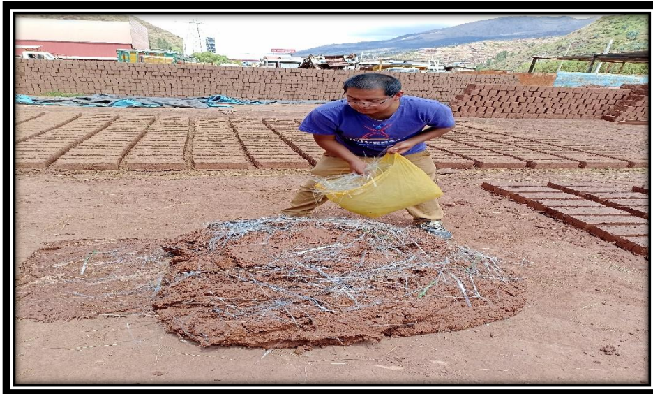
Figura 34. Preparación del adobe con el 1 % de tiras de PET.
