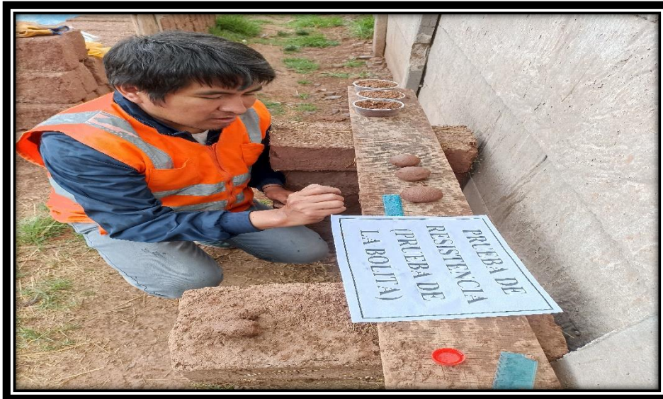
Figura 58. Realizar 4 bolitas para la prueba.
