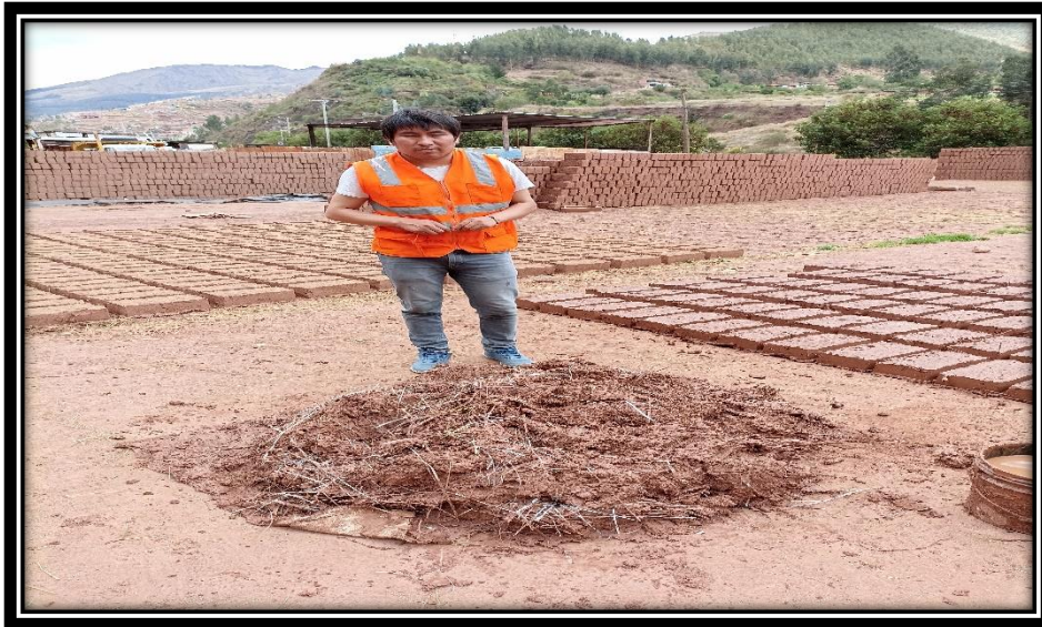
Figura 39. Dosificación del adobe con el 2 % de tiras de PET.
