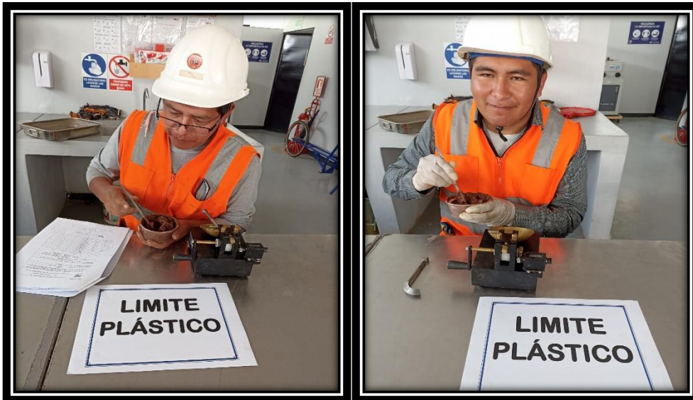
Figura 74. Mezclado del espécimen.
