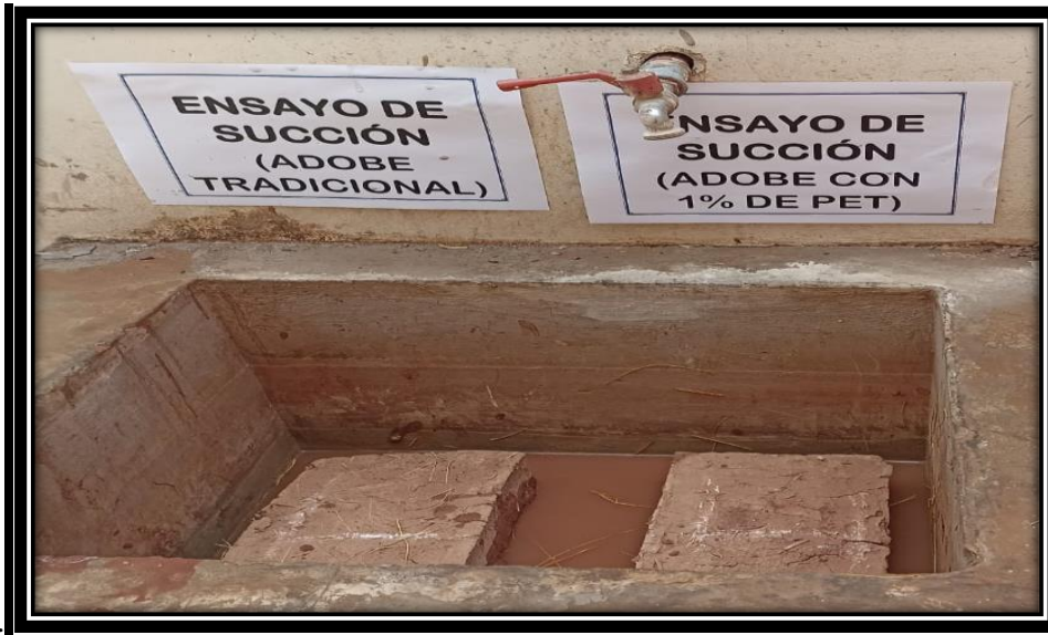
Figura 89. Succión, en el adobe control y el 1 % de tiras de PET sobre las dos cuñas durante 60 segundos.
