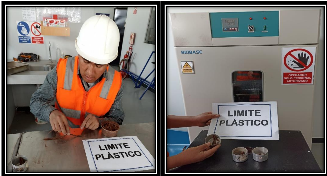
Figura 79. Amasado y colocado al horno.
