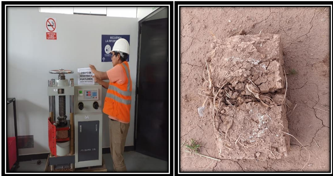
Figura 105. Prueba de la resistencia a la flexión del adobe con el 3 % de tiras de PET.
