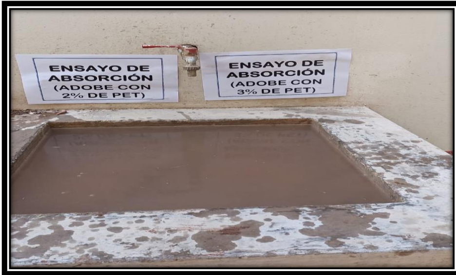
Figura 86. Prueba de absorción de las unidades de adobe con tiras de PET al 2 % y 3 %.
