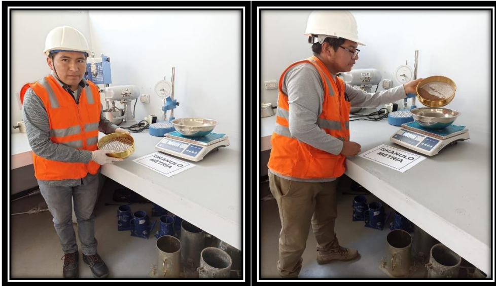
Figura 70. Registro de peso retenida en cada malla.
