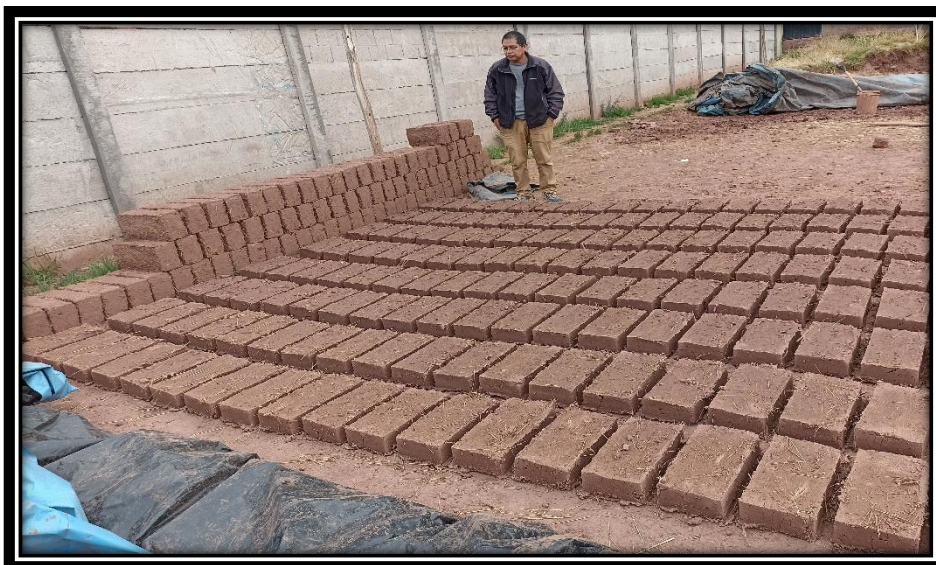
Figura 45. Secado de los adobes con el 3 % de tiras de PET.
