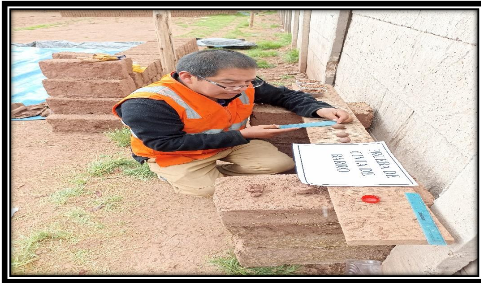
Figura 56. Aplastado de las bolitas hasta llegar a cintas de un diámetro de cuatro milímetros.
