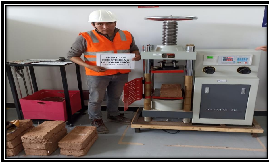
Figura 97. Unidad ensayada de adobe control.
