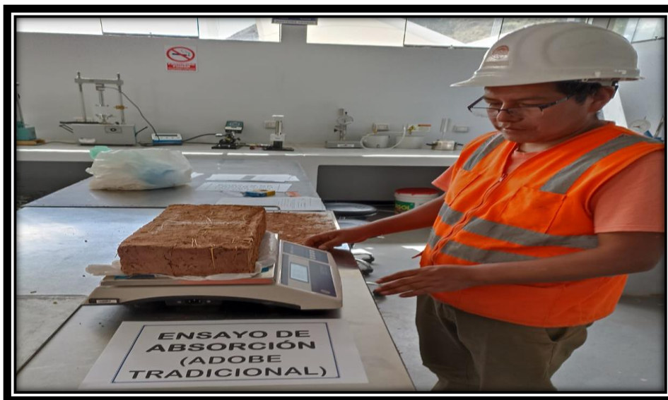
Figura 88. Pesado del adobe control y con tiras de PET en el 1 %, 2 % y 3 %.
