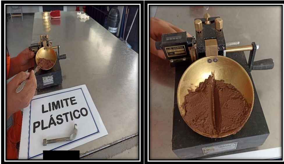
Figura 75. Colocado la muestra y dividiendo con el acanalador en la copa de casa grande.
