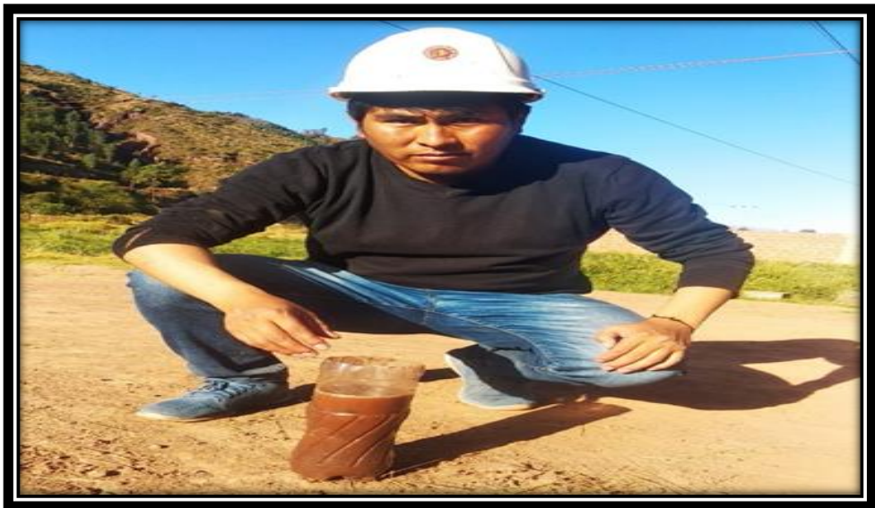
Figura 53. Reposar por un día para medir los estratos.
