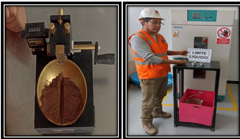
Figura 76. Obtención de las muestras y colocado al horno.
