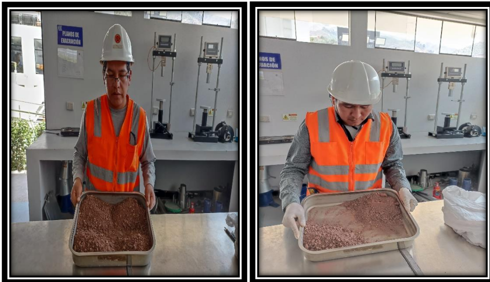
Figura 63. Repartición de la muestra en 4 partes y elegimos 2 muestras representativas.
