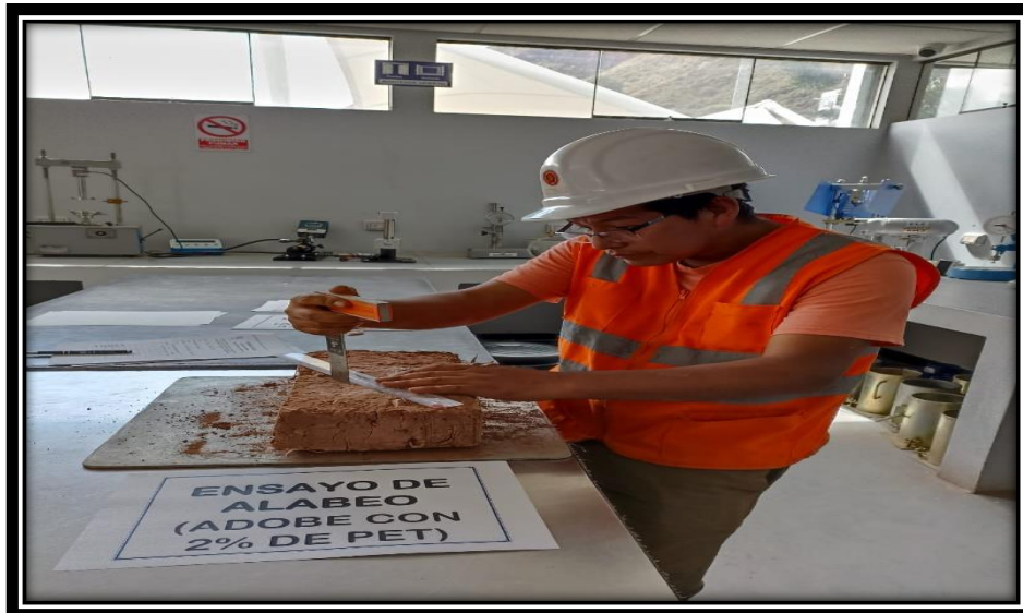
Figura 82. Medición del alabeo del adobe con 2 % de tiras de PET.
