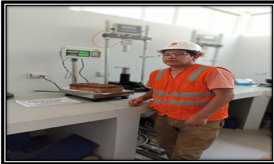
Figura 91. Pesando nuevamente los adobes después de la succión de 60 segundos el adobe control y los con tiras de PET al 1 %, 2 % y 3 %.
