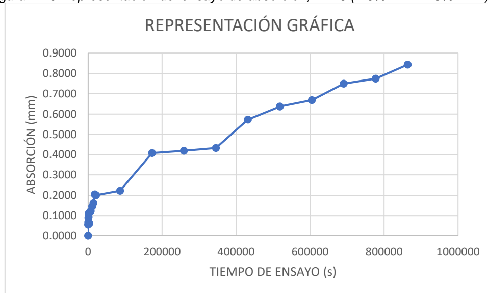
Figura 4.13 Representación del ensayo de absorción, MA-8 (1.5% FP + 7.5% FAR).
