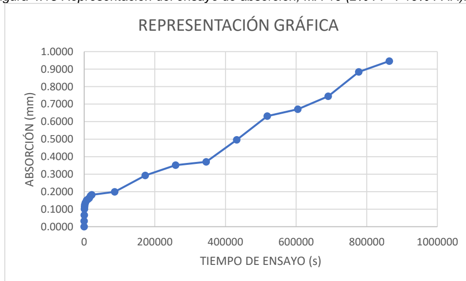
Figura 4.15 Representación del ensayo de absorción, MA-10 (2% FP + 10% FAR).
