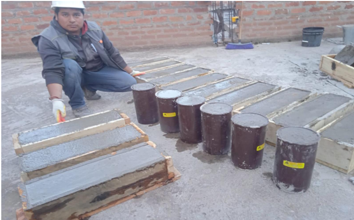
Fotografía N° 19: Vaciado de concreto en moldes
