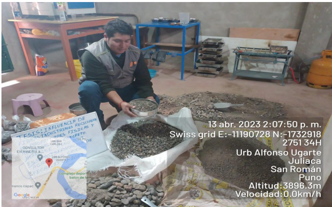
Fotografía N° 08: Separación de los agregados por medio de los tamices
