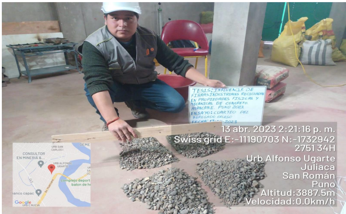
Fotografía N° 06: Cuarteo de los agregados
