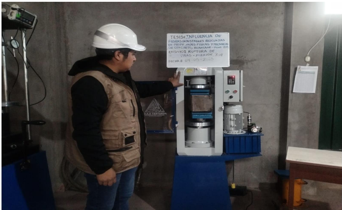
Fotografía N° 21: Ensayo a la resistencia a la flexión
