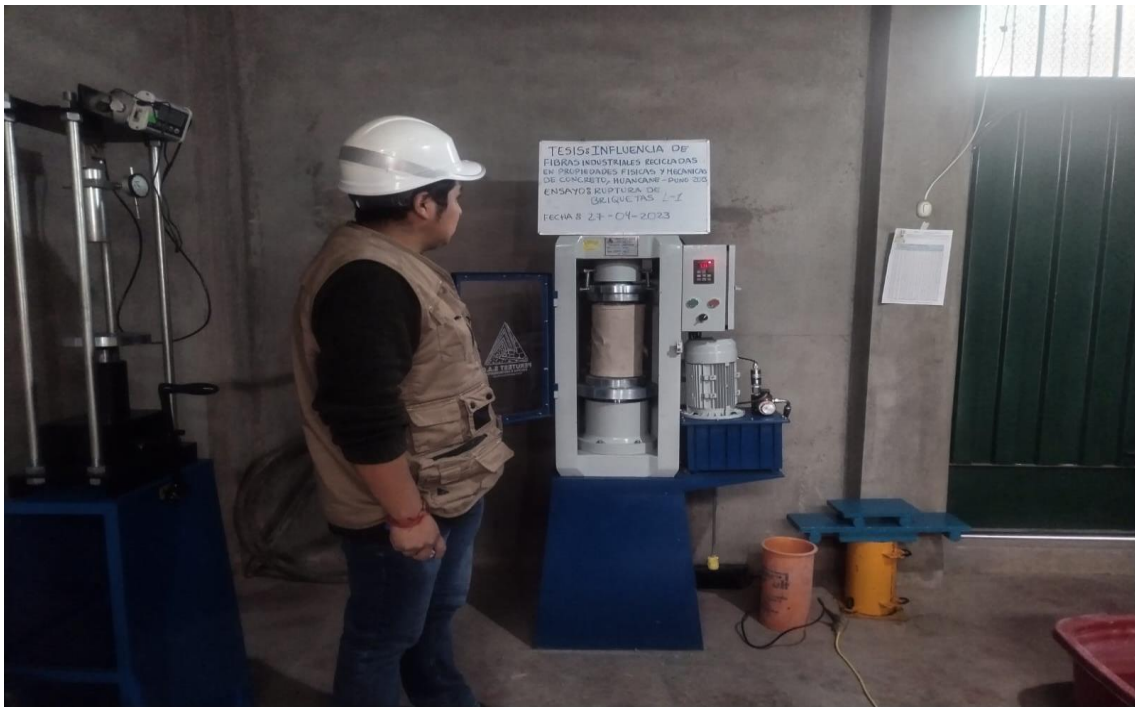
Fotografía N° 21: Ensayo a la resistencia a la flexión
