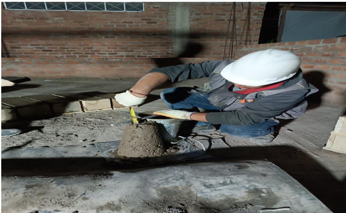
Fotografía N° 18: Ensayo de asentamiento.
