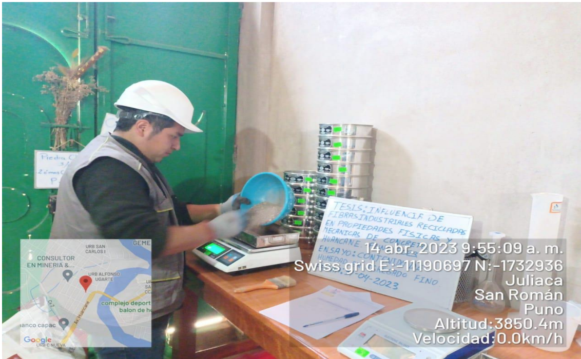
Fotografía N° 12: Contenido de humedad en agregado fino
