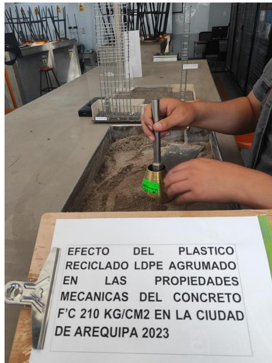
Figura 11: Ensayo de Absorción
