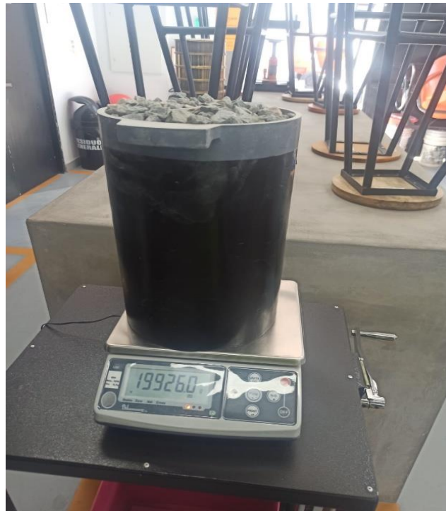
Figura 4: Masa de agregado grueso compactado
