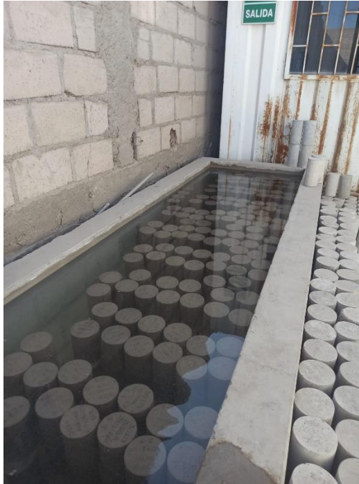
Figura 16: Curado de Probetas
