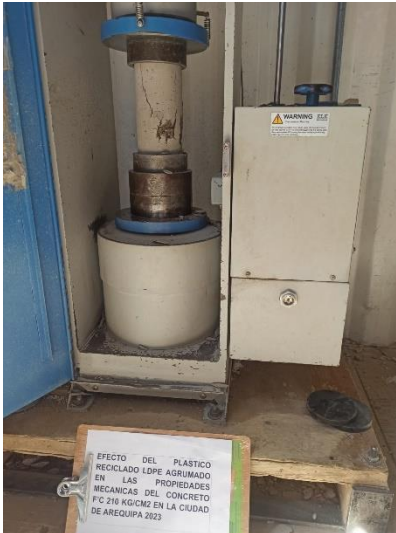
Figura 17: Prueba de compresión
