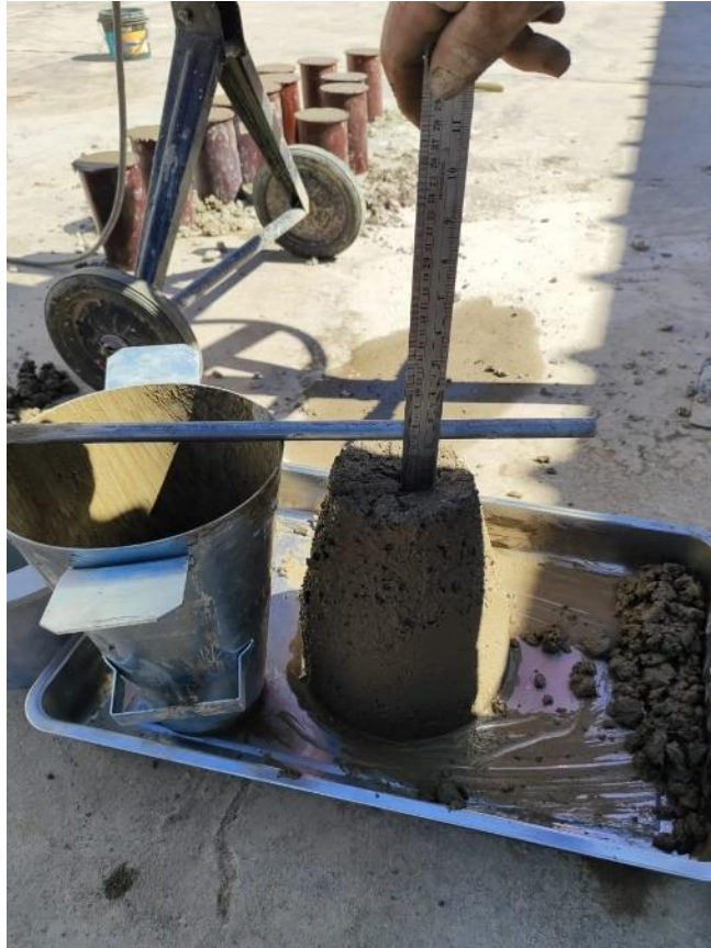
Figura 13: slump del concreto
