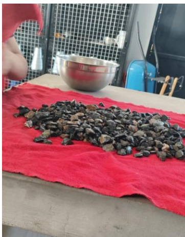
Figura 5: Agregado grueso condición SSS
