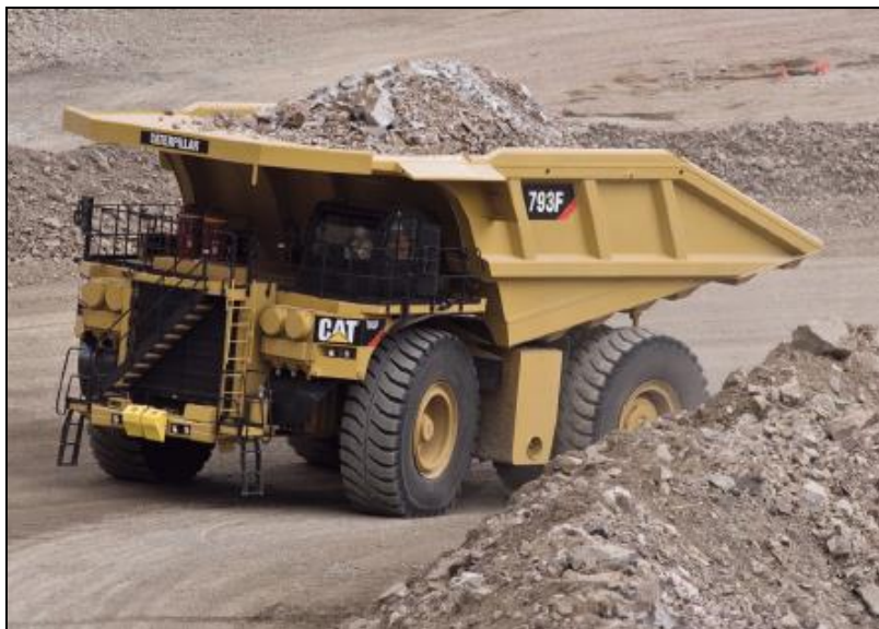
Figura 8. Camión de acarreo Caterpillar 793F Fuente: Caterpillar modelo 739F (22)
