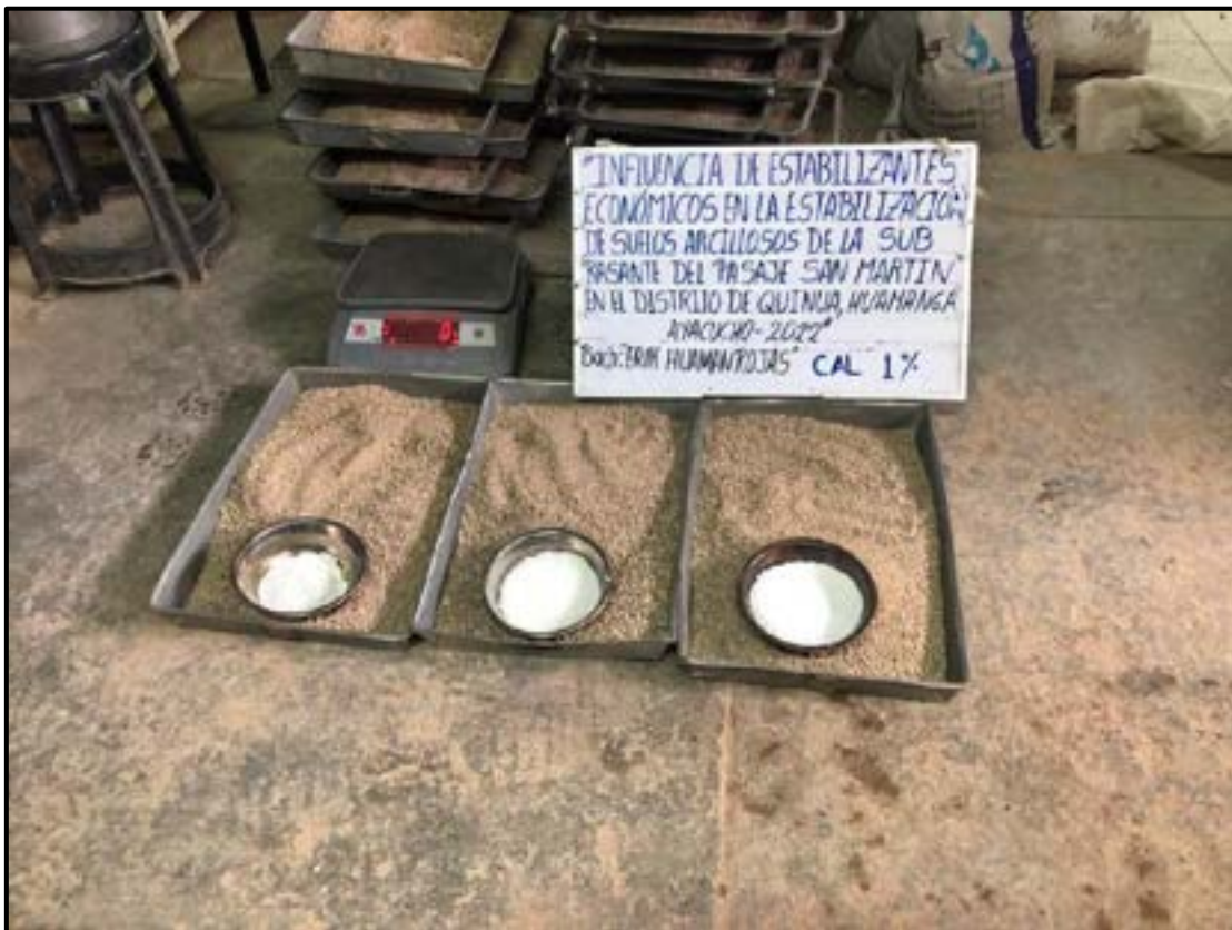
Fotografía N° 17. Se observa la cal al 1%, CBR (CALIFORNIA BEARING RATIO).
