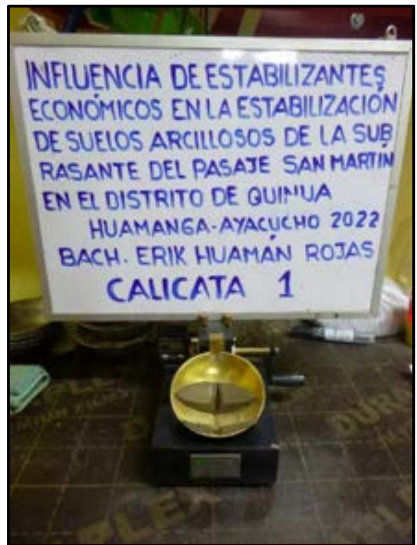
Fotografía N°02 y 03. A la izquierda se observa realizar el método del cuarteo de la muestra C-01, Derecha se observa el procedimiento para obtener la consistencia o de Atterberg.
