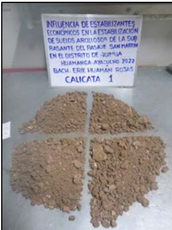
Fotografía N°02 y 03. A la izquierda se observa realizar el método del cuarteo de la muestra C-01, Derecha se observa el procedimiento para obtener la consistencia o de Atterberg.
