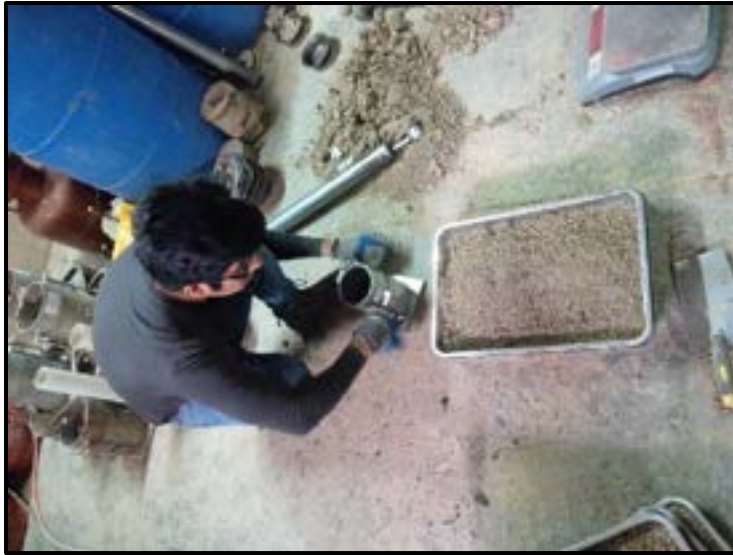
Fotografía N°07 y 08. A la izquierda se observa montaje del molde metálico, Derecha se observa la compactación con el pisón 56 golpes (ENSAYO PROCTOR MODIFICADO).
