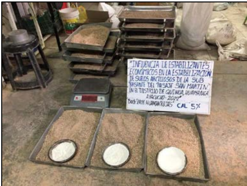
Fotografía N° 19. Se observa la cal al 5%, CBR (CALIFORNIA BEARING RATIO).
