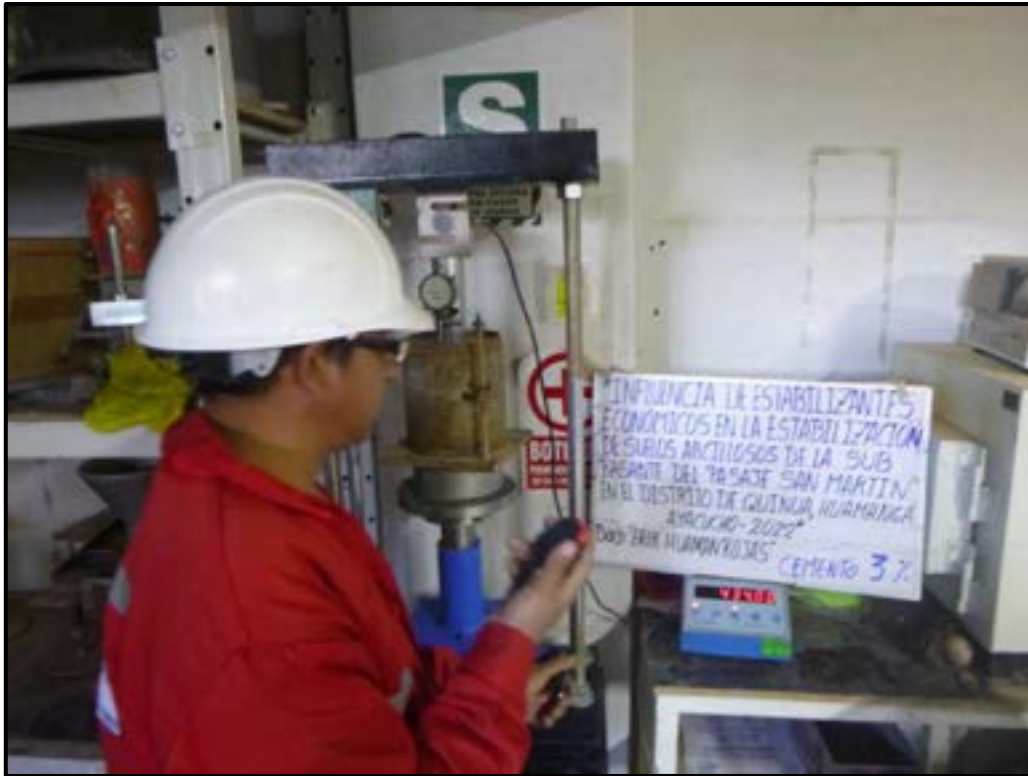
Fotografía N° 14. Se observa el cemento portland tipo I al 3%, CBR (CALIFORNIA BEARING RATIO).
