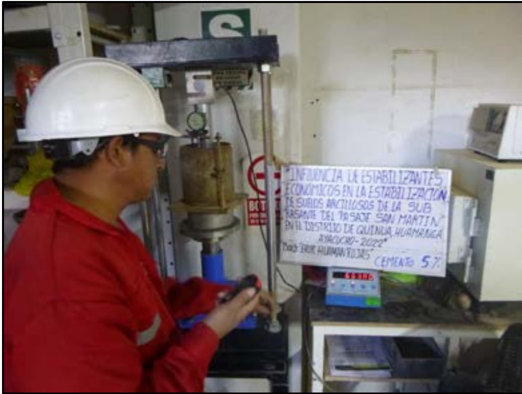
Fotografía N° 16. Se observa el cemento portland tipo I al 5%, CBR (CALIFORNIA BEARING RATIO).
