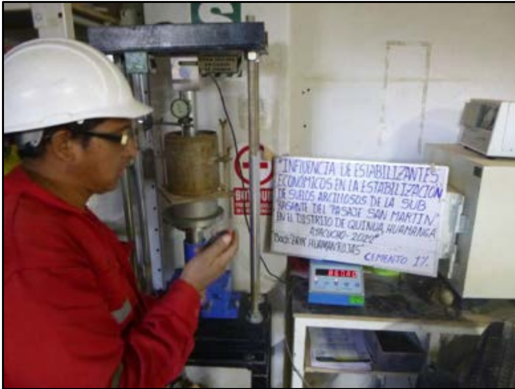
Fotografía N° 12. Se observa el cemento portland tipo I al 1%, CBR (CALIFORNIA BEARING RATIO).
