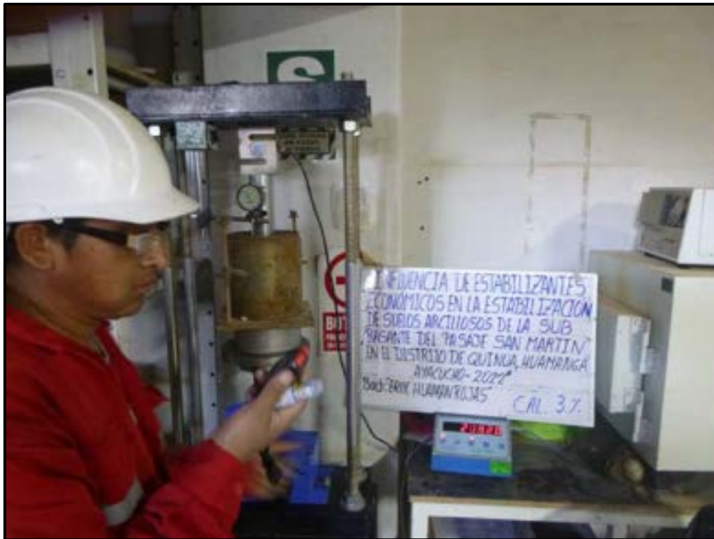
Fotografía N° 18. Se observa la cal al 3%, CBR (CALIFORNIA BEARING RATIO).
