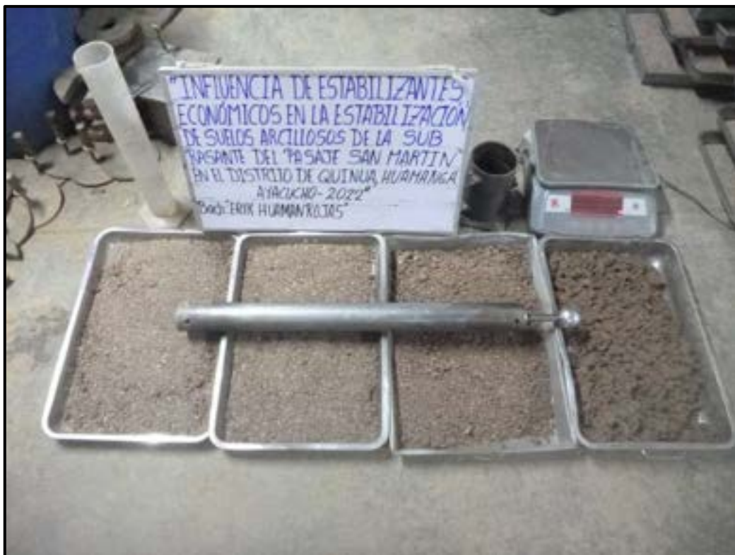
Fotografía N°06. Se muestra equipos que se utilizarán para realizar el ENSAYO PROCTOR MODIFICADO.
