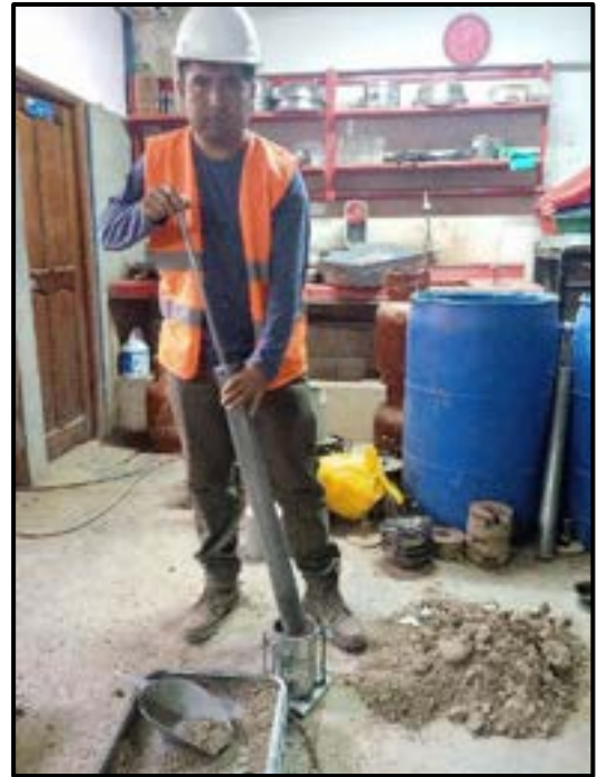
Fotografía N°07 y 08. A la izquierda se observa montaje del molde metálico, Derecha se observa la compactación con el pisón 56 golpes (ENSAYO PROCTOR MODIFICADO).
