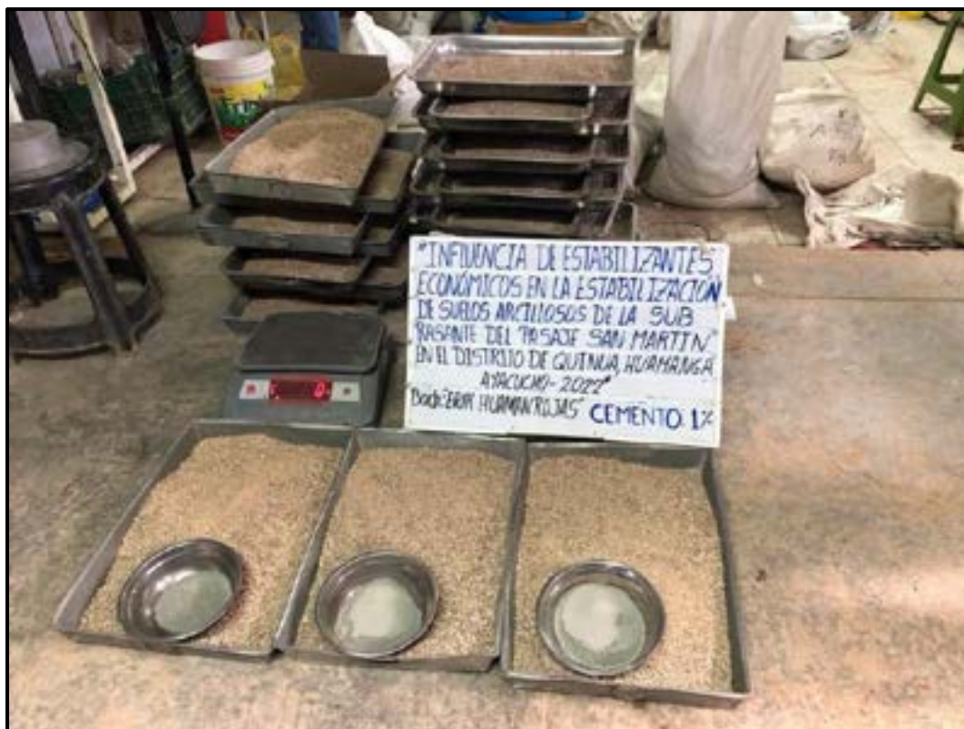
Fotografía N° 11. Se observa el cemento portland tipo I al 1%, CBR (CALIFORNIA BEARING RATIO).
