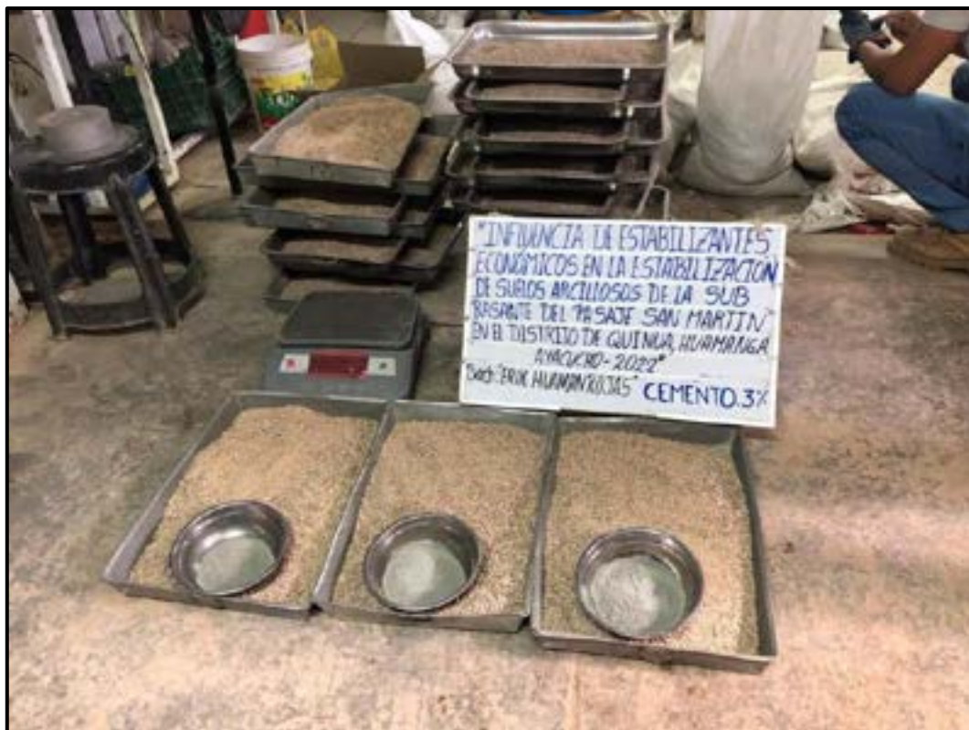
Fotografía N° 13. Se observa el cemento portland tipo I al 3%, CBR (CALIFORNIA BEARING RATIO).
