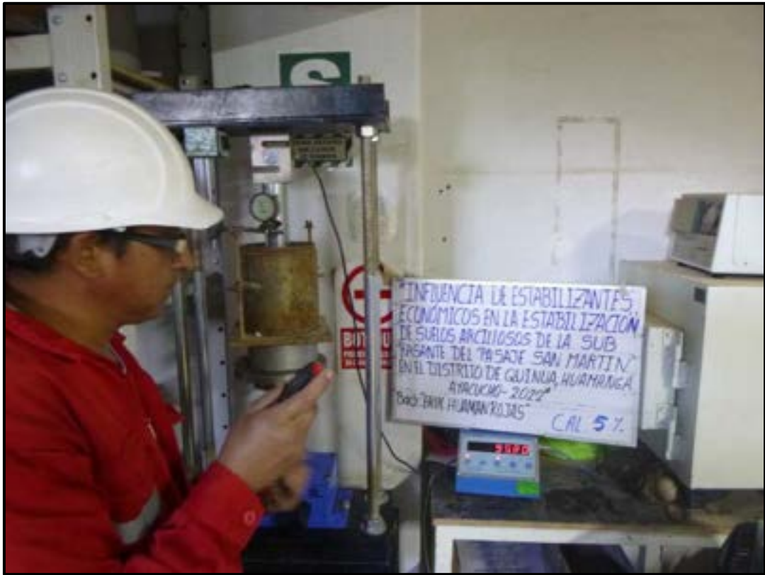
Fotografía N° 20. Se observa la cal al 5%, CBR (CALIFORNIA BEARING RATIO).
