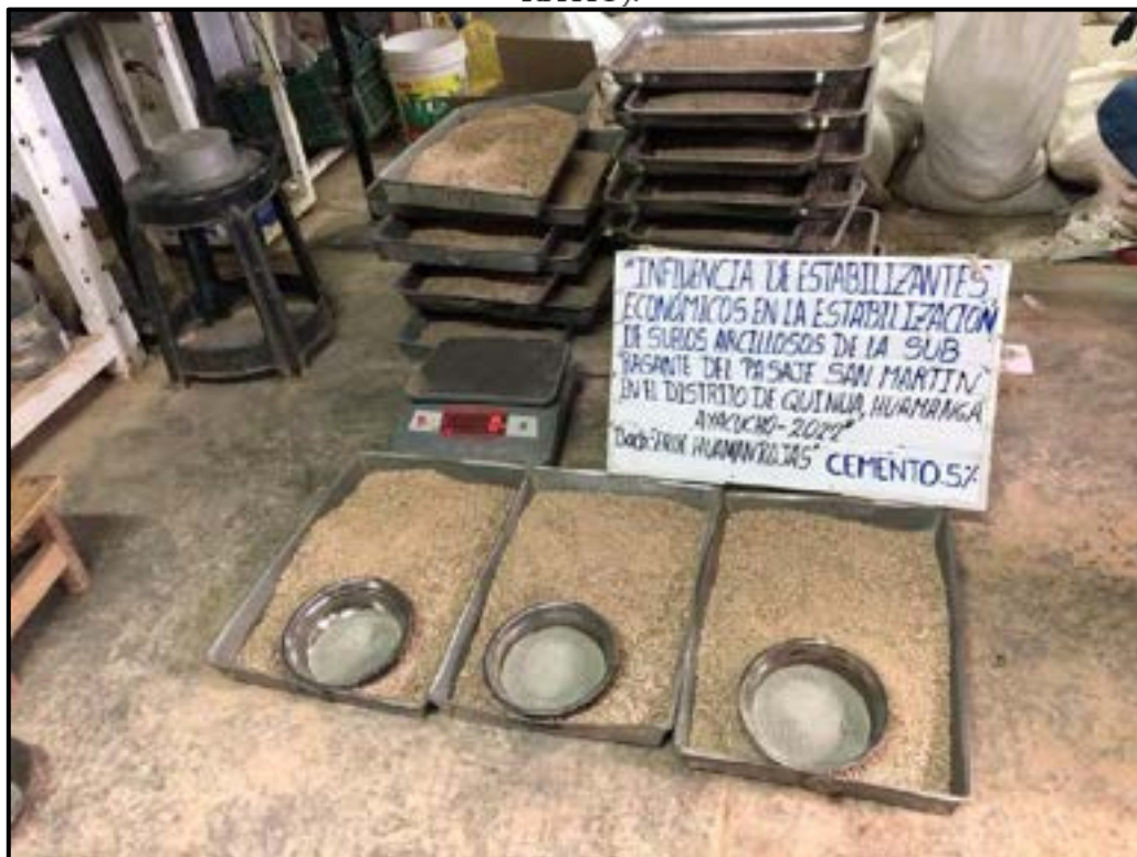
Fotografía N° 14. Se observa el cemento portland tipo I al 3%, CBR (CALIFORNIA BEARING RATIO).
