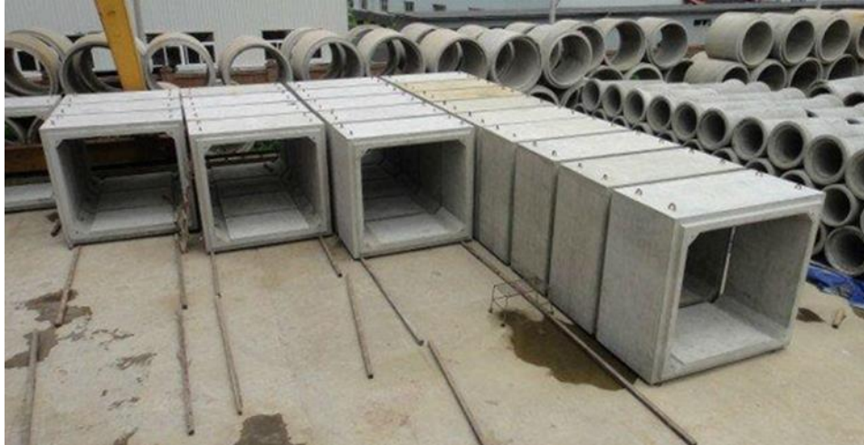
Figura 4. Alcantarillas de concreto. Nota: Elaboración propia.
