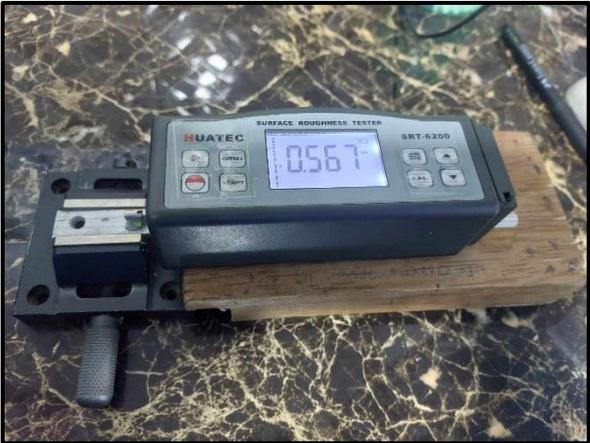
**Figura 33.** Rugosímetro digital SRT6200 en el laboratorio “High Technology”
