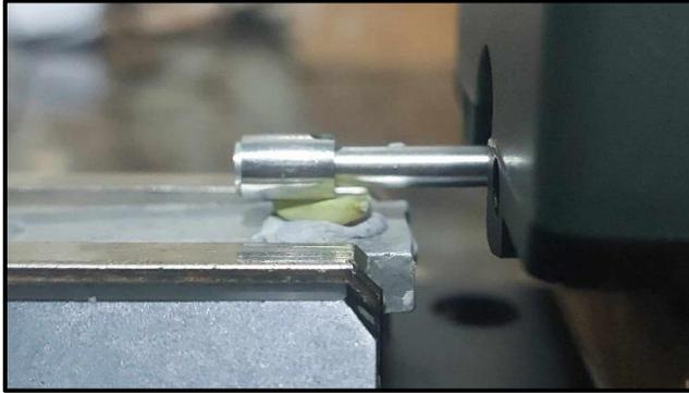
**Figura 35.** Medición superficial de las muestras con el rugosímetro
