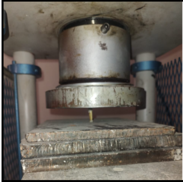
Medición de la resistencia a la compresión
