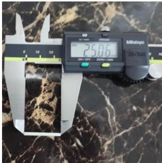
Figura 13. Medición del largo, alto y ancho de la barra de resina con Calibrador Vernier Digital
