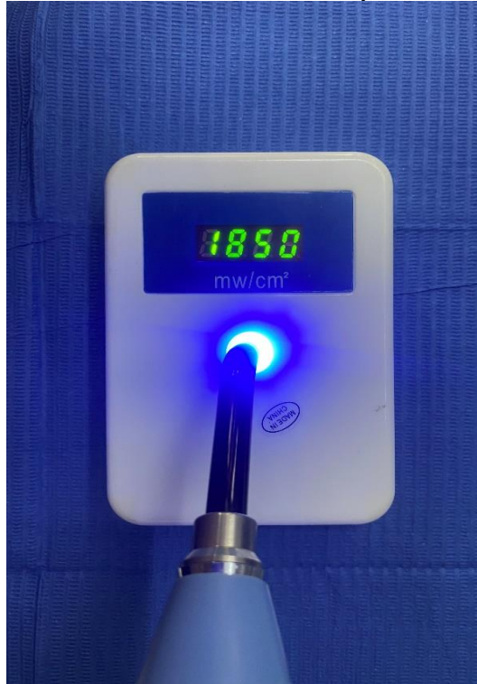
Figura 3. Medición de intensidad de la luz de la lámpara led D Woodpecker
