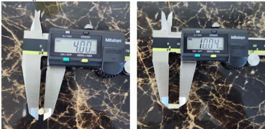
Figura 12. Medición del diámetro y altura del cilindro de resina con Calibrador Vernier Digital
