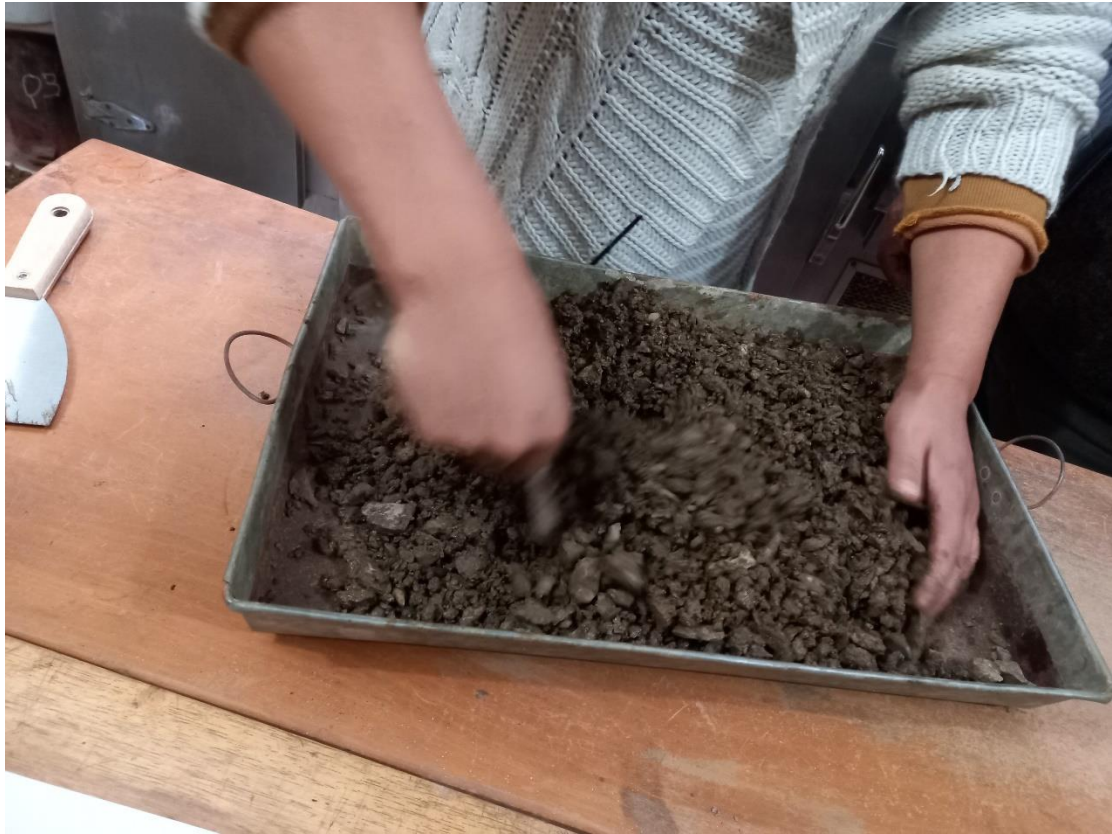
Fotografía N°17: Preparado de la muestra para ensayo de Relación de Soporte de California (CBR)
