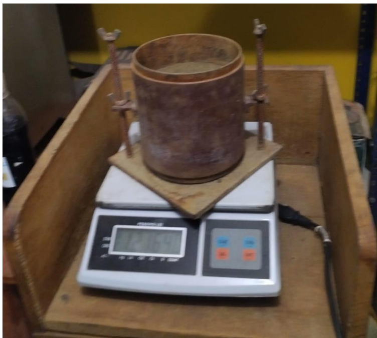
Fotografía N°20: Pesado de la muestra de ensayo de Relación de Soporte de California (CBR)
