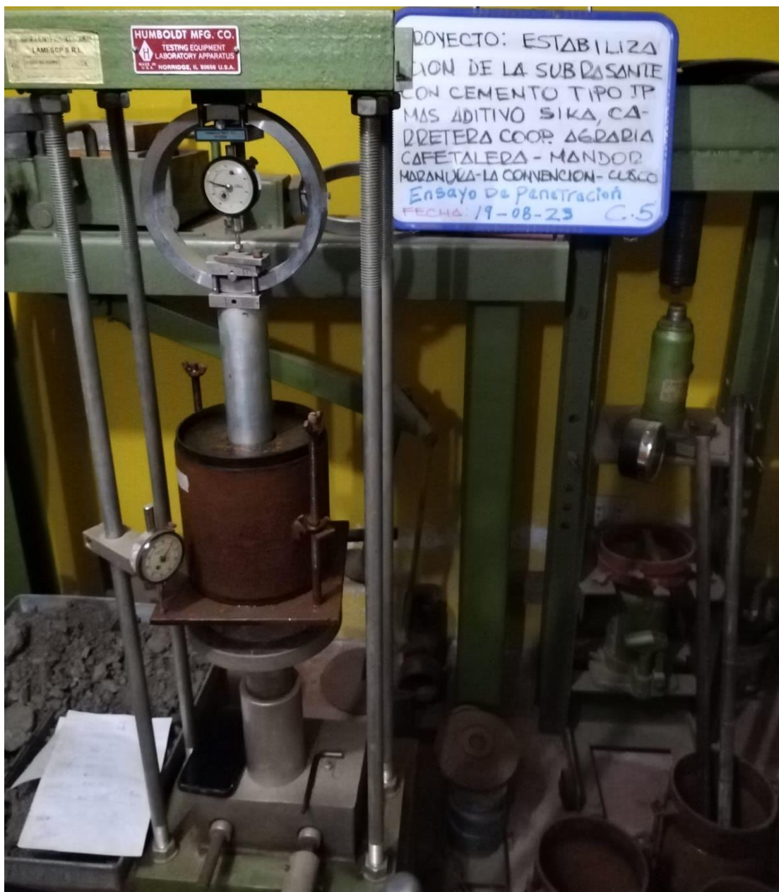
Fotografía N°28: Penetración de la muestra de ensayo de Relación de Soporte de California (CBR)
