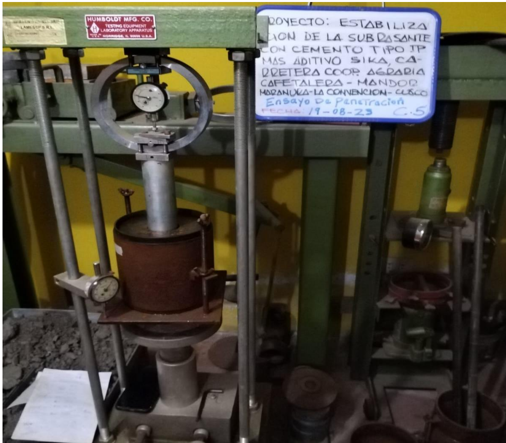
Fotografía N°23: Penetración de muestra de ensayo de Relación de Soporte de California (CBR)
