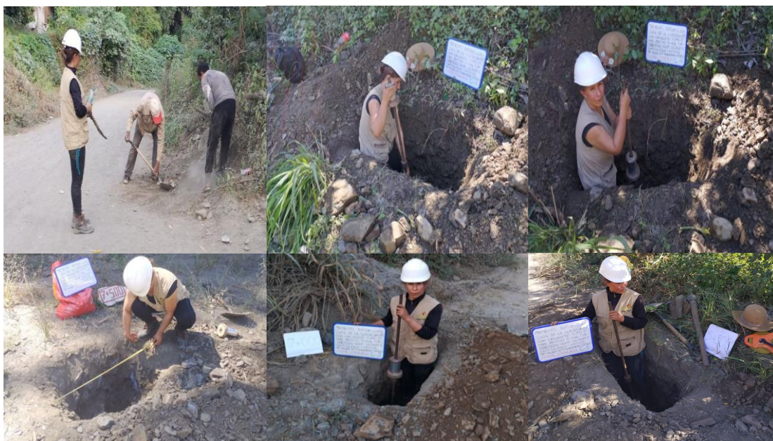
Figura 9. Extracción de muestras de las calicatas
