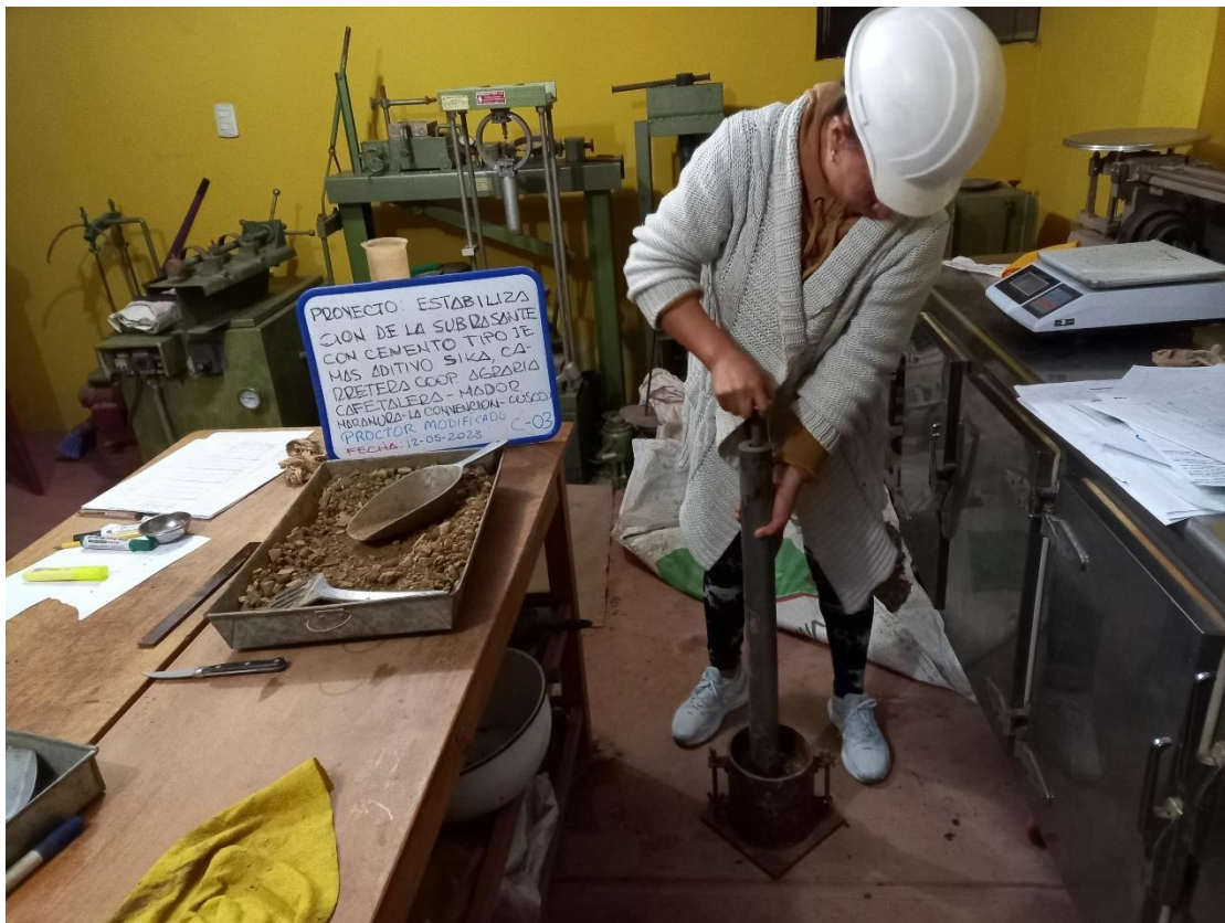
Fotografía N°13: Compactado de la muestra de ensayo de Proctor modificado
