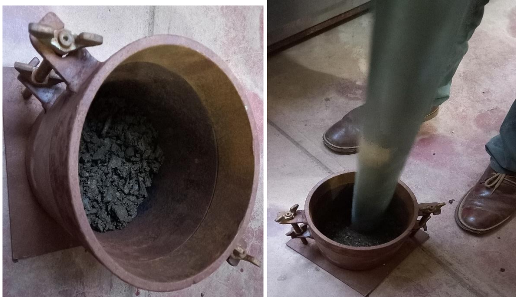
Fotografía N°18: Colocación y compactado de la muestra de ensayo de Relación de Soporte de California (CBR)
