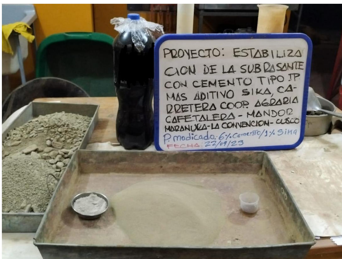
Fotografía N°25: Colocación de aditivos Sika y cemento para ensayo de Proctor modificado
