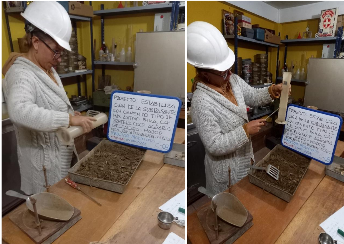
Fotografía N°12: Preparado de la muestra de ensayo de Proctor modificado
