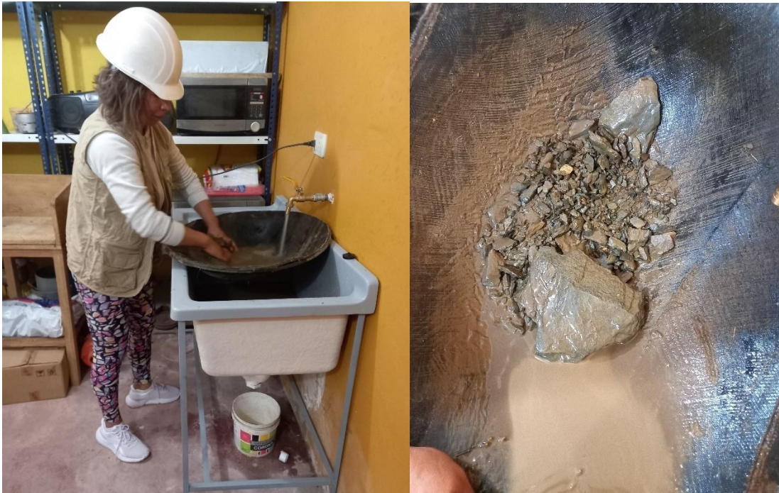
Fotografía N°2: Lavado de la muestra para ensayo granulométrico
