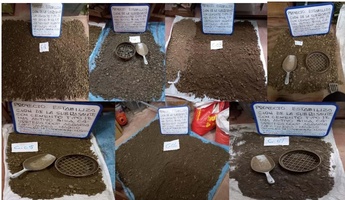
Figura 18. Ensayo de Laboratorio Proctor modificado
