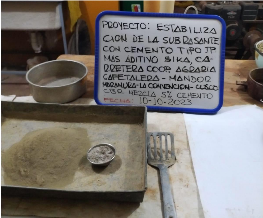
Fotografía N°26: Colocación de aditivos Sika y cemento para ensayo de Relación de Soporte de California (CBR)
