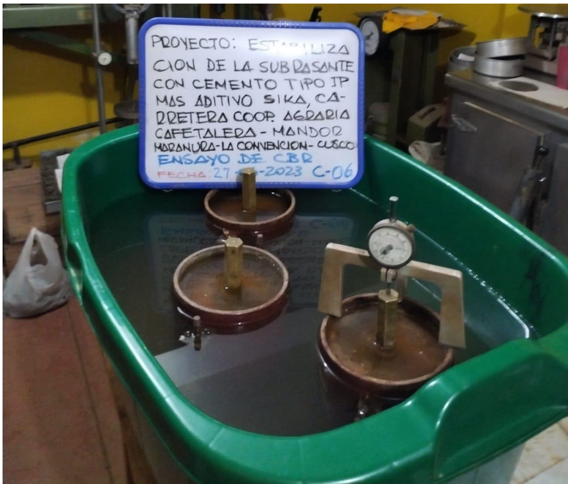
Fotografía N°22: Saturación de la muestra de ensayo de Relación de Soporte de California (CBR)
