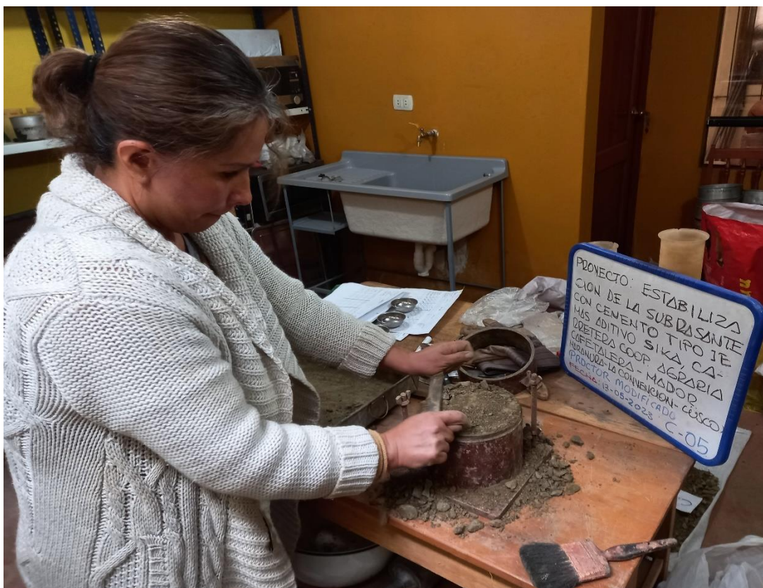
Fotografía N°14: Enrasado de la muestra de ensayo de Proctor modificado
