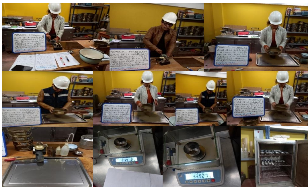
Figura 10. Ensayo de Límite líquido de las 7 calicatas
