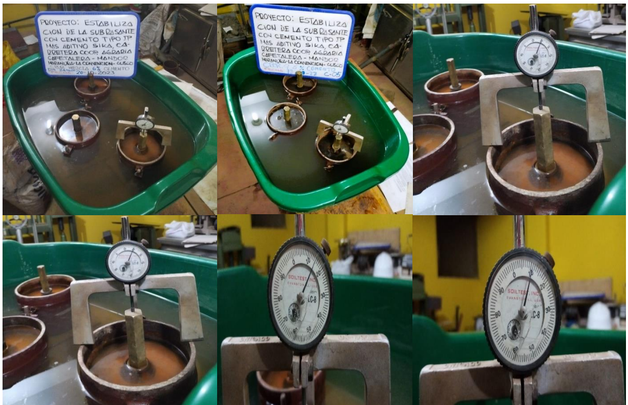
Figura 25. Ensayo de laboratorio de CBR – Ensayo de Penetración
