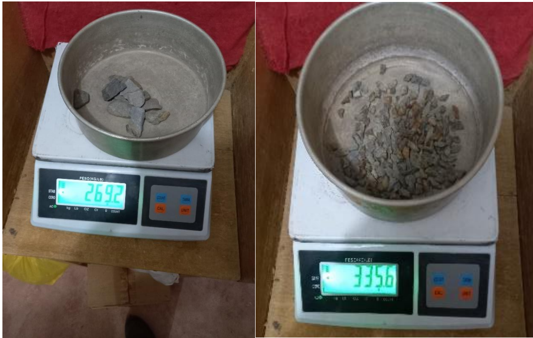
Fotografía N°4: Pesado de la muestra de ensayo granulométrico
