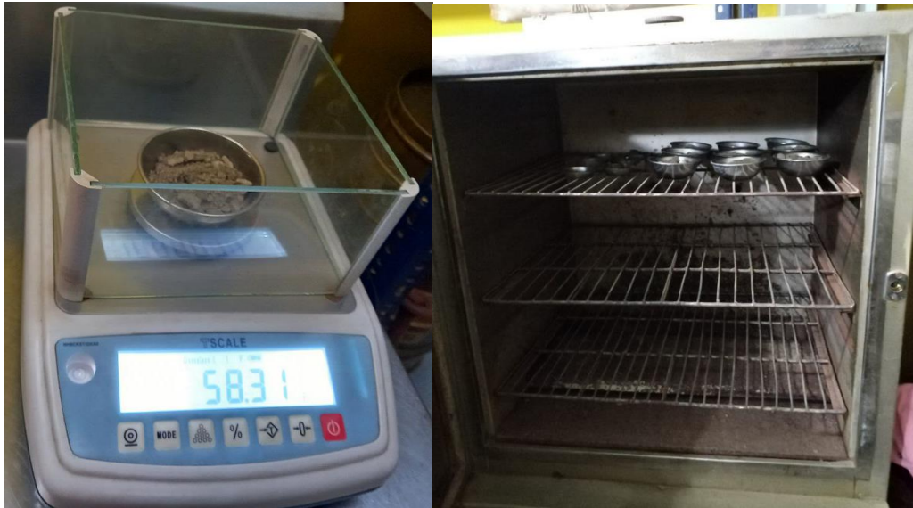
Fotografía N°21: Pesado y secado de la muestra de ensayo de Relación de Soporte de California (CBR)
