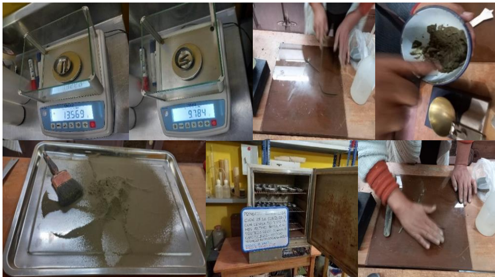
Figura 11. Ensayo sobre límite plástico
