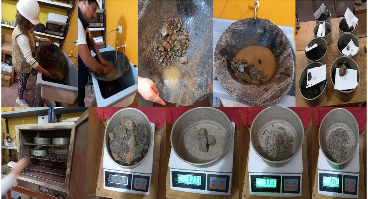
Figura 12. Ensayo de Laboratorio Análisis Granulométrico por Tamizado
