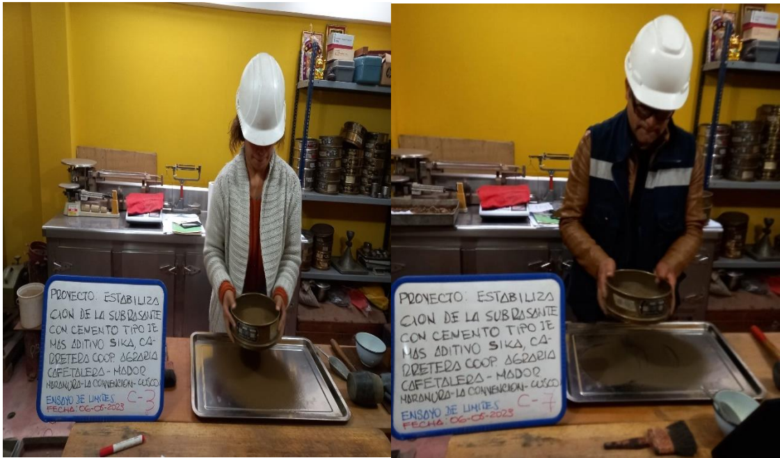
Fotografía N°6: Tamizado de la muestra de ensayo de límites de consistencia
