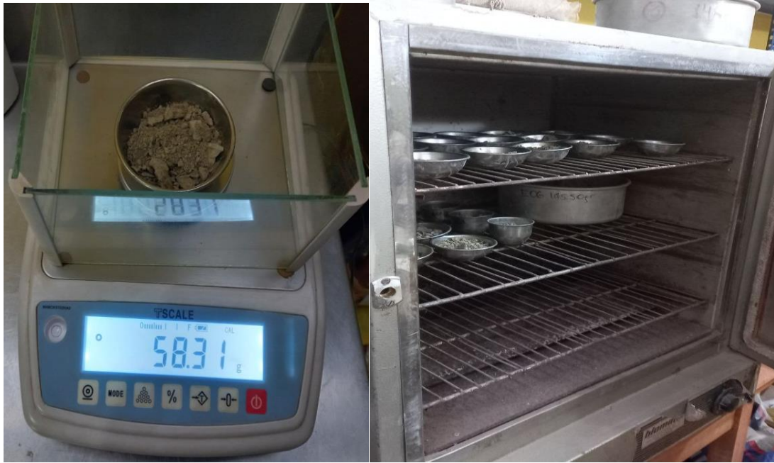
Fotografía N°16: Pesado y horneado de la muestra de ensayo de Proctor modificado
