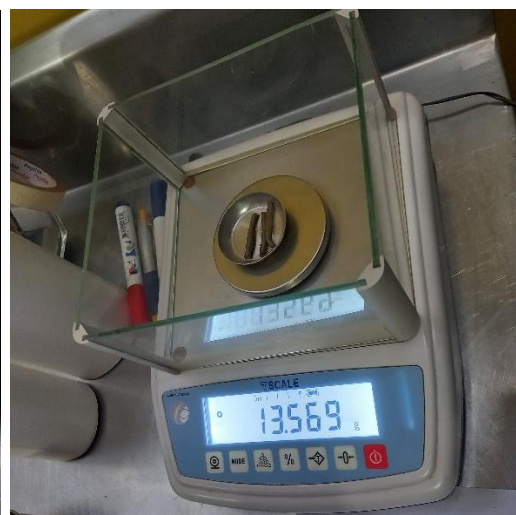
Fotografía N°9: Pesado de la muestra de ensayo de límites de consistencia
