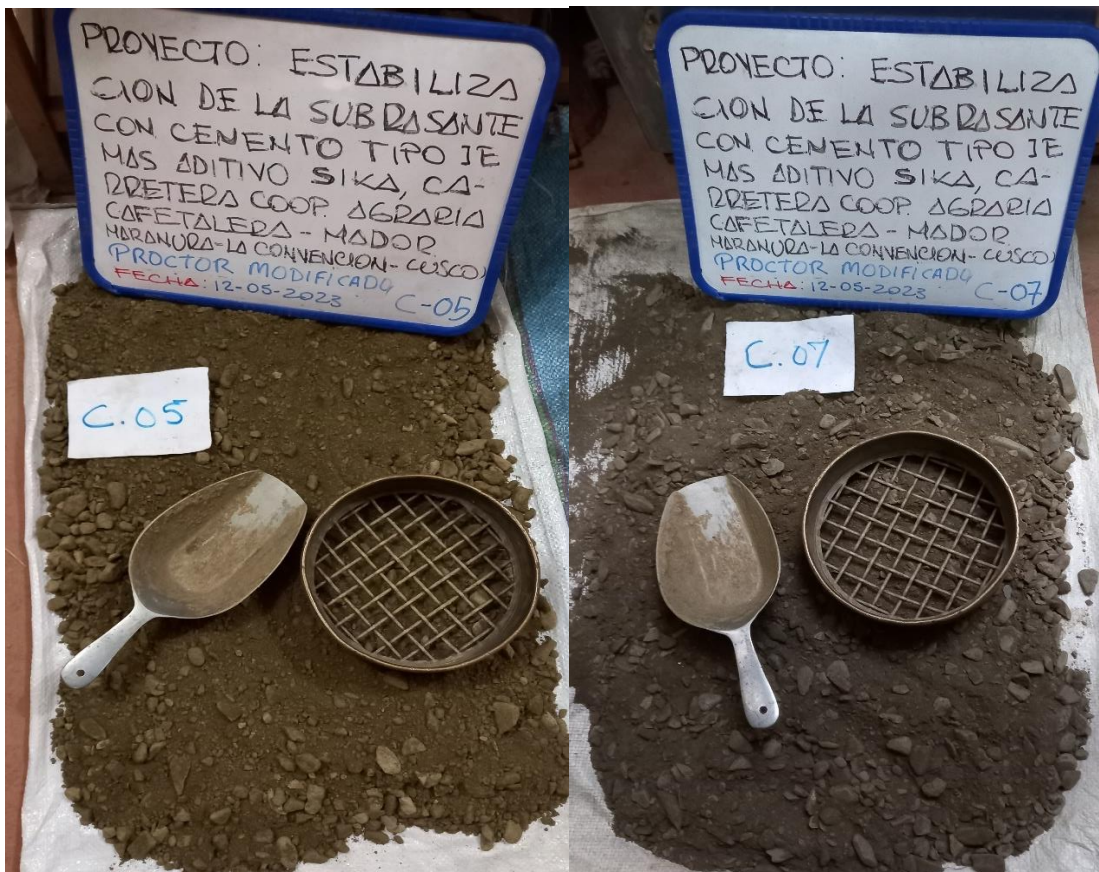
Fotografía N°11: Tamizado ¾" de la muestra de ensayo de Proctor modificado
