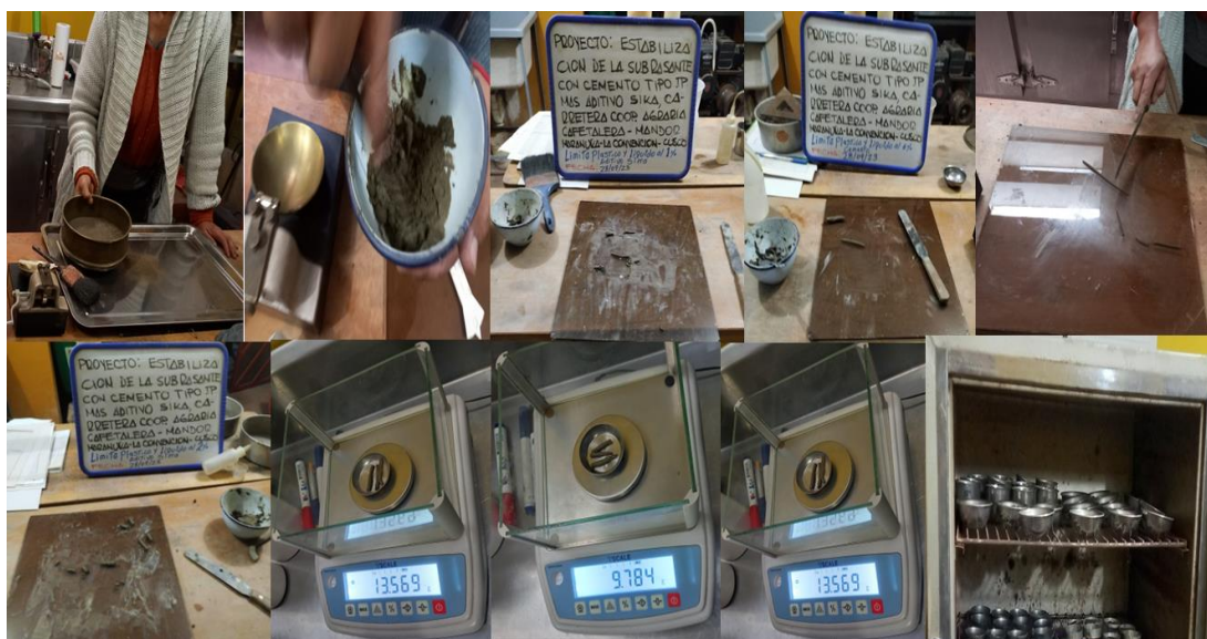
Figura 21. Ensayo de Límite plástico más los aditivos
