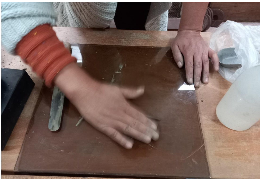
Fotografía N°8: Formación de bastones con las yemas de dedos de la muestra de ensayo de límites de consistencia
