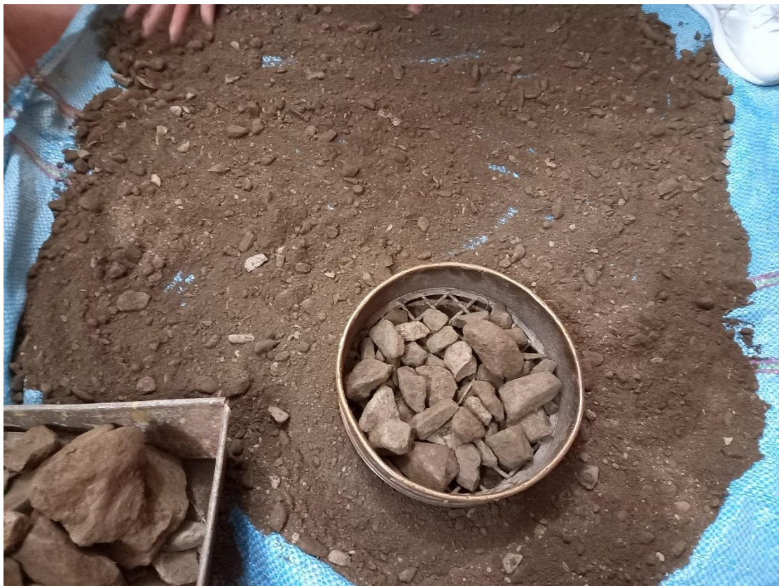
Fotografía N°17: Tamizado \frac{3}{4} " de la muestra para ensayo de Relación de Soporte de California (CBR)
