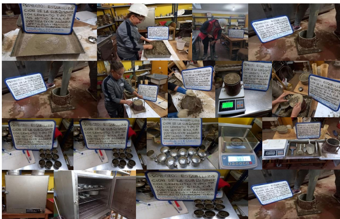
Figura 22. Ensayo de Laboratorio Proctor modificado más los aditivos
