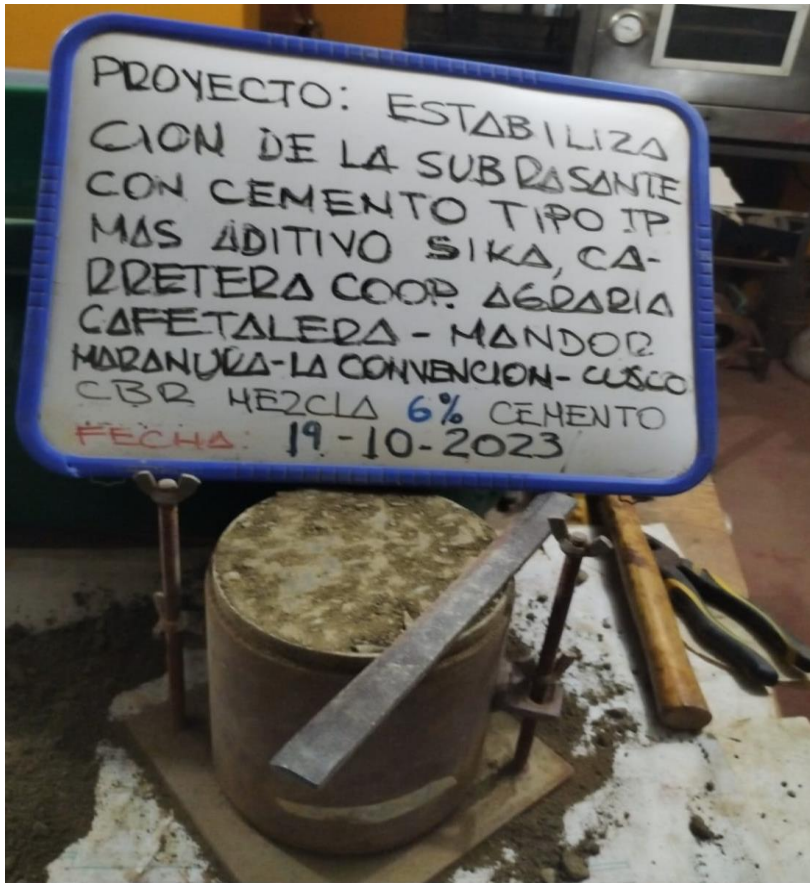
Fotografía N°19: Enrasado de la muestra de ensayo de Relación de Soporte de California (CBR)
