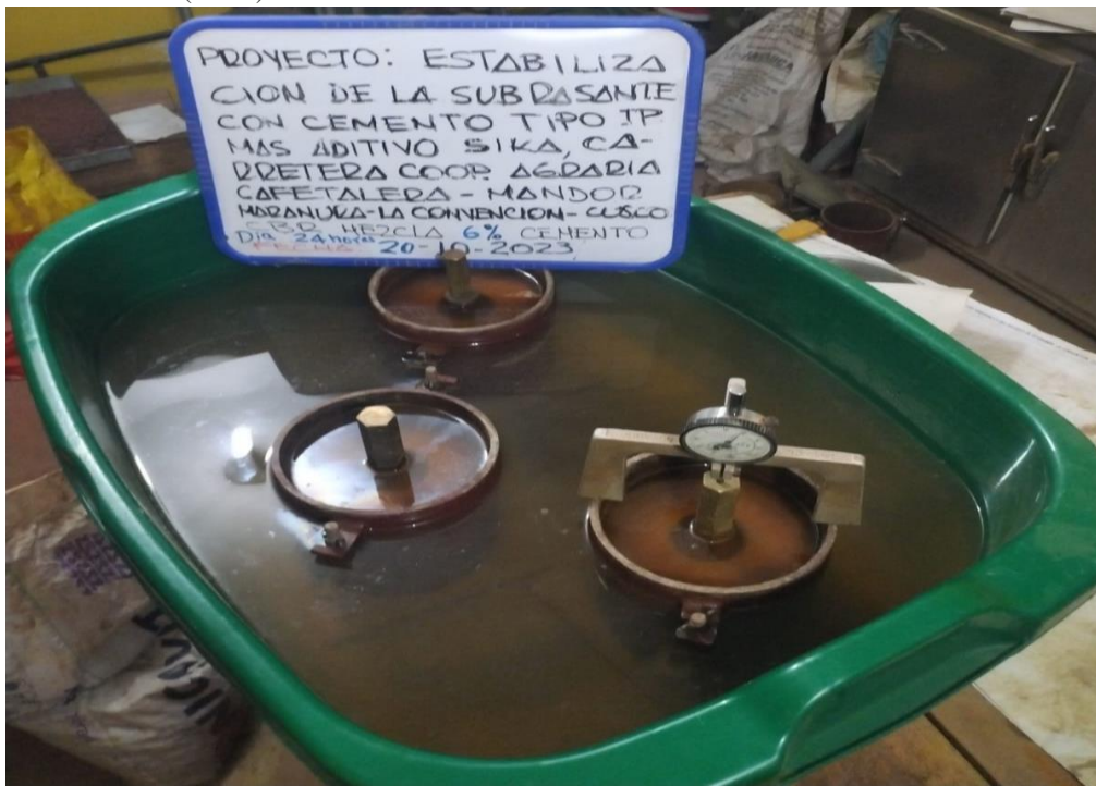
Fotografía N°27: Saturación de la muestra de ensayo de Relación de Soporte de California (CBR)
