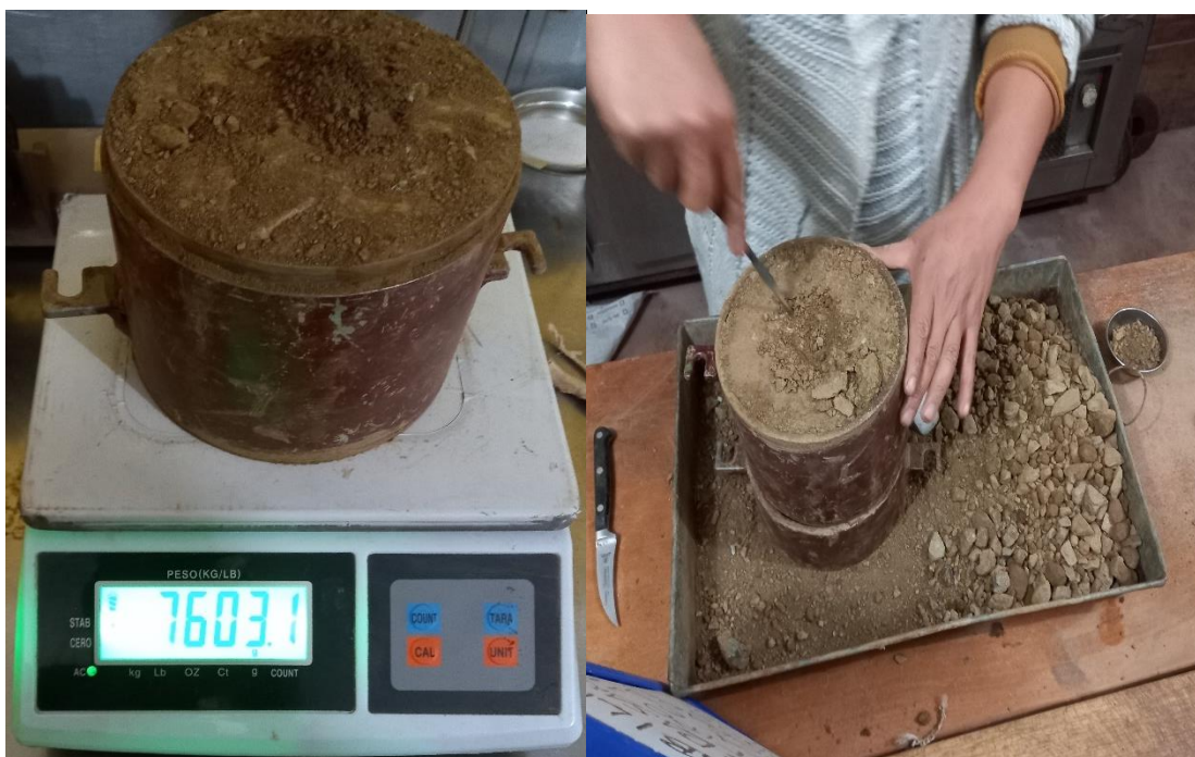
Fotografía N°15: Pesado de la muestra de ensayo de Proctor modificado
