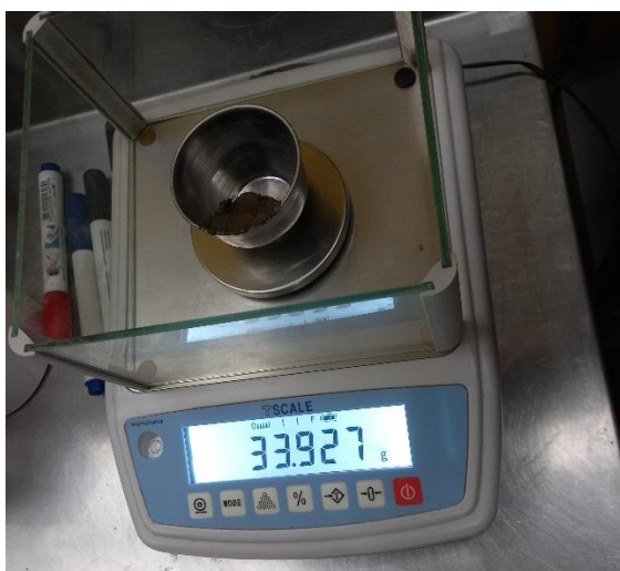
Fotografía N°9: Pesado de la muestra de ensayo de límites de consistencia
