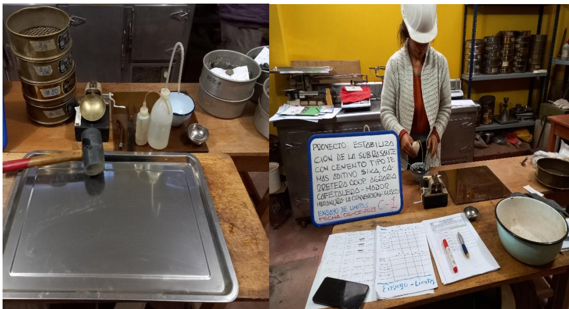
Fotografía N°7: Preparación de la muestra de ensayo de límites de consistencia
