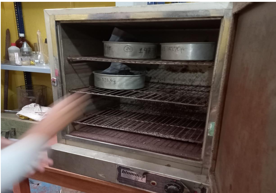
Fotografía N°3: secado de la muestra para ensayo granulométrico
