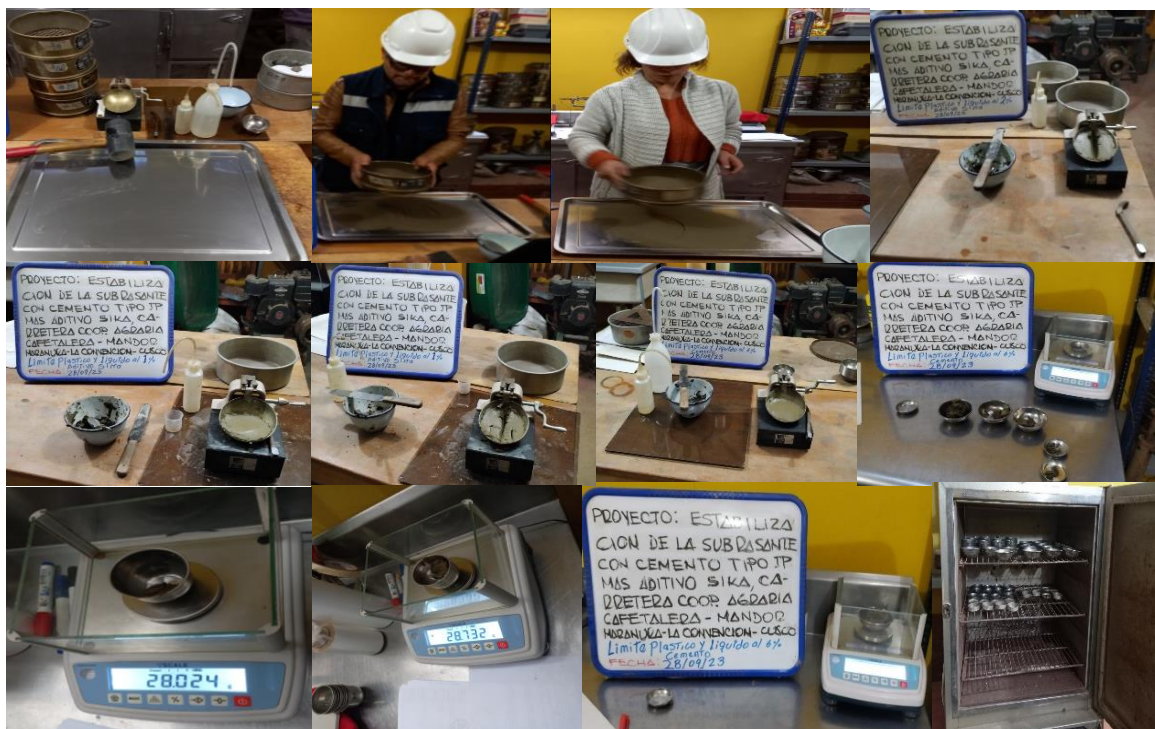
Figura 20. Ensayo de Límite líquido más los aditivos
