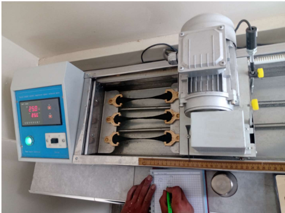
Figura 35. Muestras de rotura por elongación ensayo del ductilímetro
