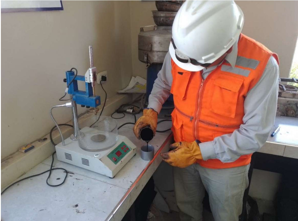
Figura 27. Vertido de asfalto en molde para ensayo de penetración del cemento asfáltico
