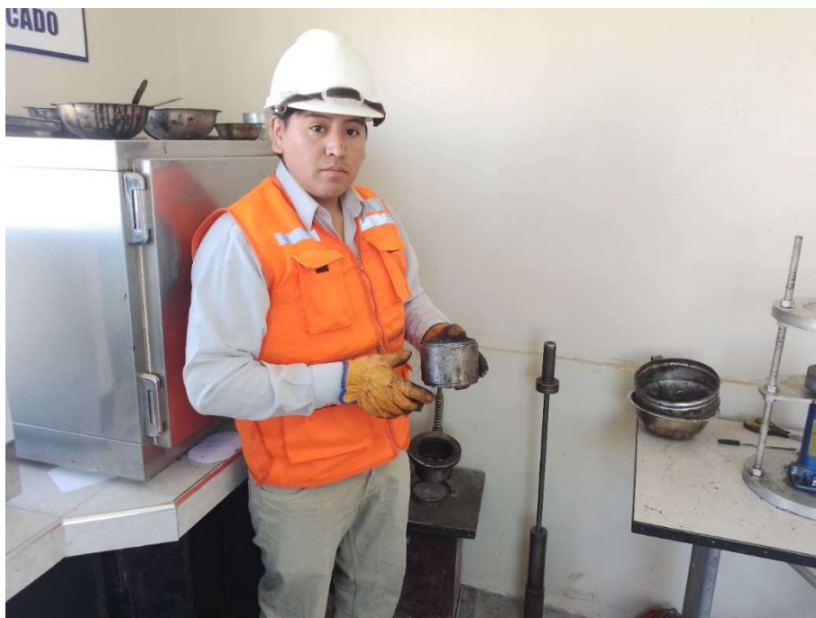
Anexo 8: El espécimen se deberá desmoldarse después de enfriarse
