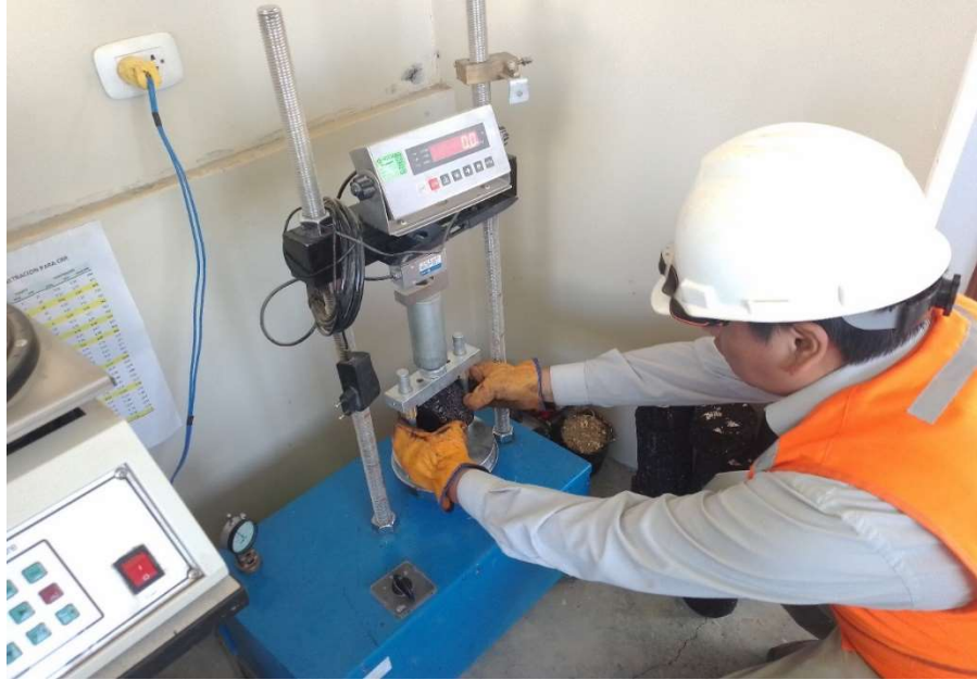
Figura 25. Colocación de especímenes en aparato Marshall con mordaza Lottman para ensayo de tracción indirecta
