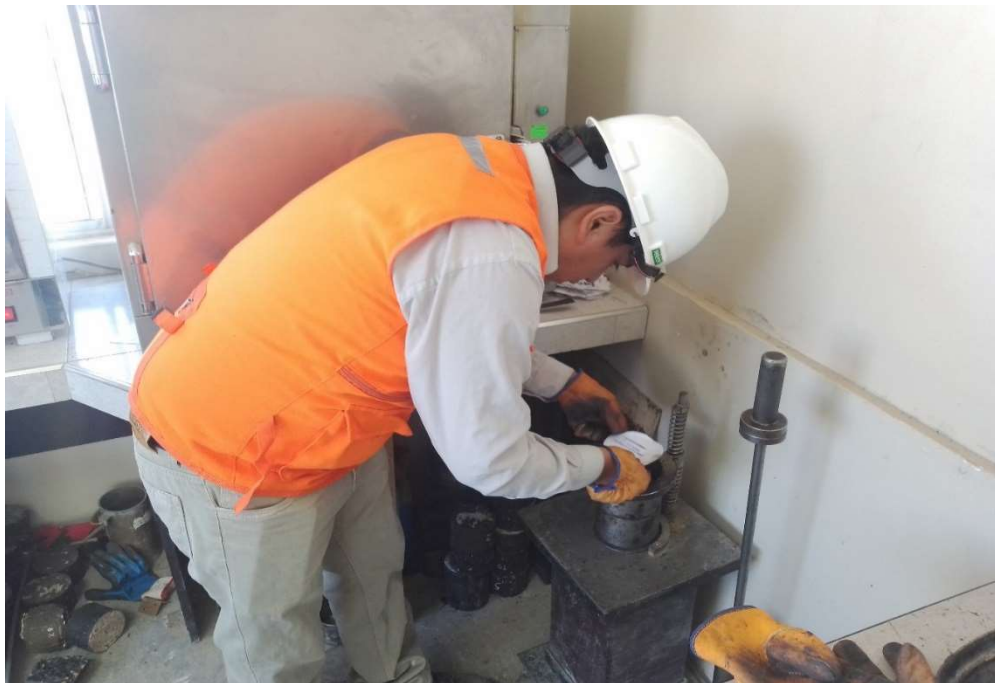
Anexo 4: Instalación del molde en el pedestal para compactado de especimen
