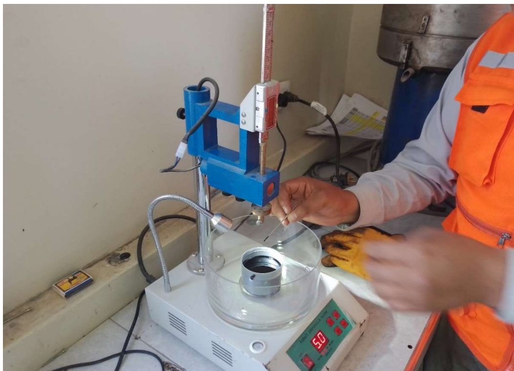
Figura 30 Retiro de aguja de penetración para nuevo ensayo
