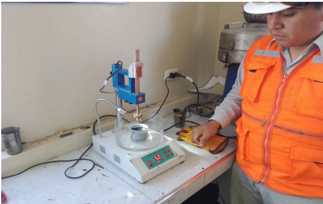
Figura 28. Ensayo de penetración del cemento asfáltico
