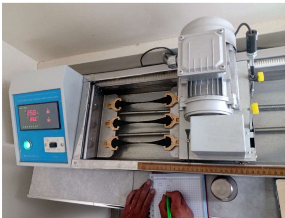
Anexo 30: Ensayo de ductilidad en desarrollo evidenciando la elongación del asfalto
