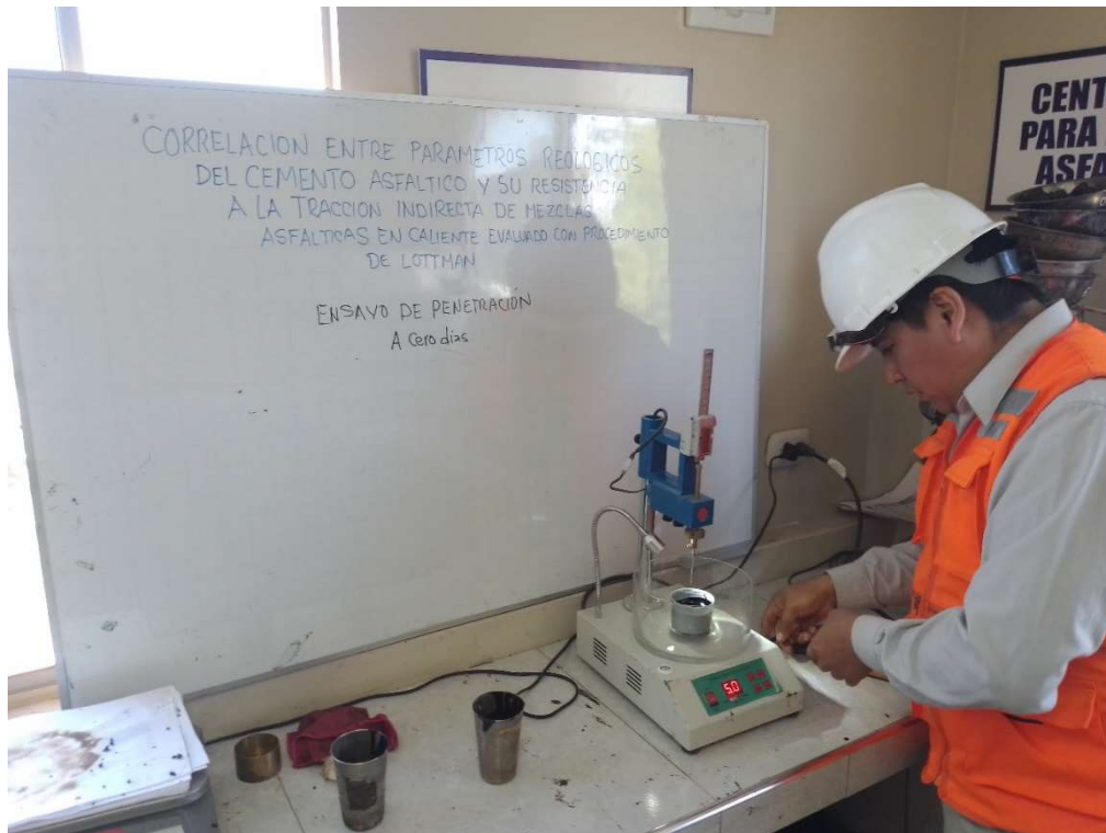
Figura 29 Registro de valores de penetración del cemento asfáltico
