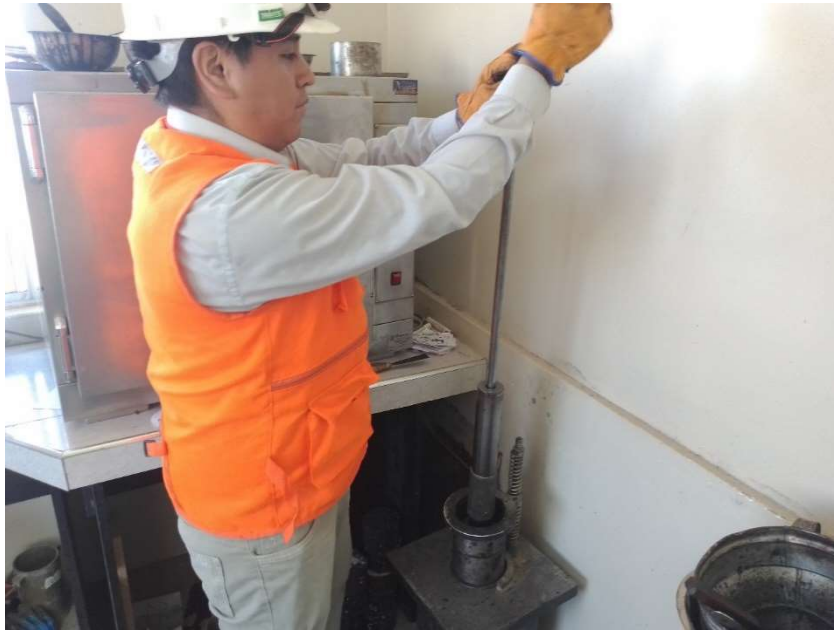
Figura 11. Compactado de espécimen mediante el martillo Marshall
