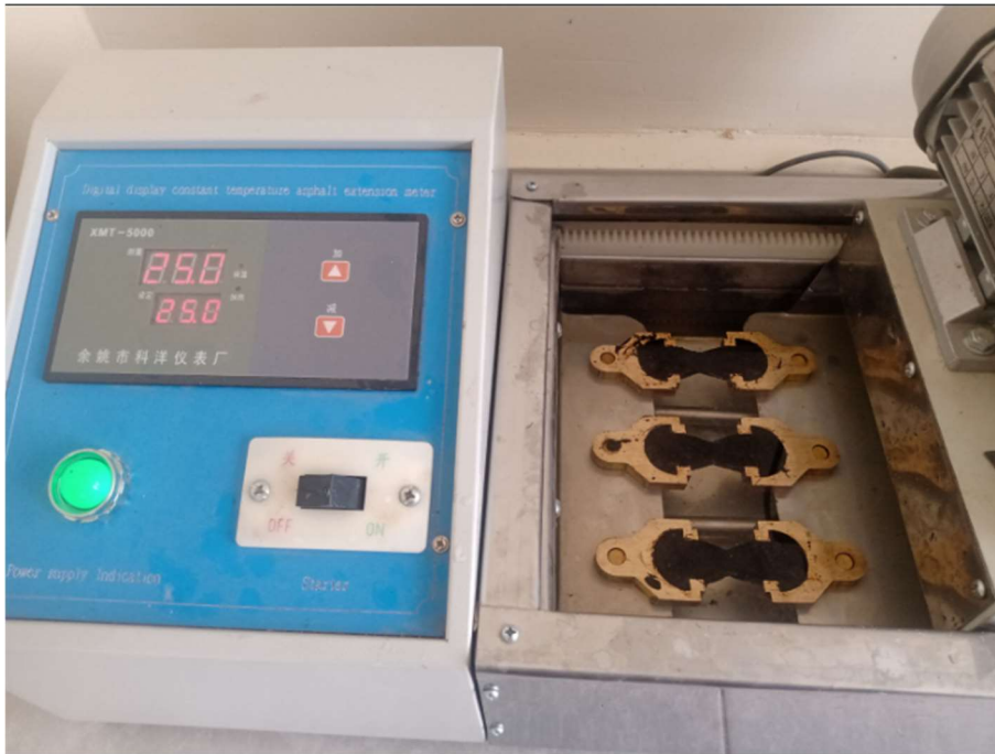
Figura 34. Moldes de ensayo instalados para ensayo de ductilidad del cemento asfáltico
