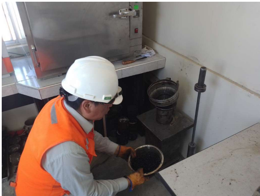
Anexo 5: Vertido de la mezcla asfáltica al molde de compactación
