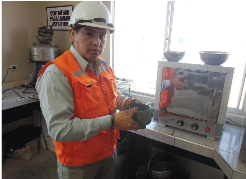
Anexo 3: Retiro del horno de los moldes para la compactación de los especímenes
