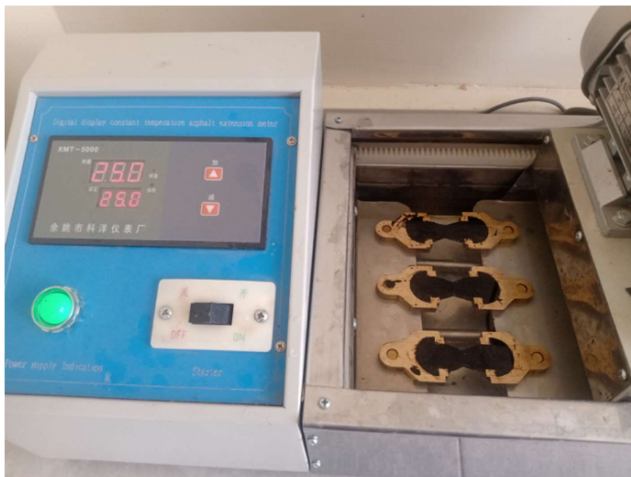
Anexo 30: Ensayo de ductilidad en desarrollo evidenciando la elongación del asfalto
