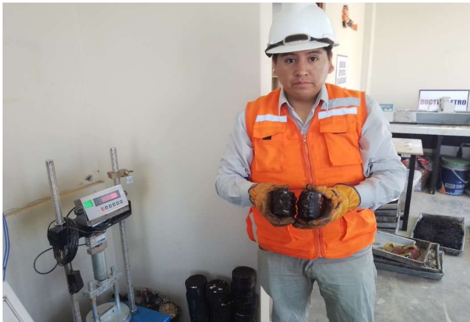
Figura 26. Rotura diametral del espécimen, se registra el valor de carga de rotura tracción indirecta Lottman
