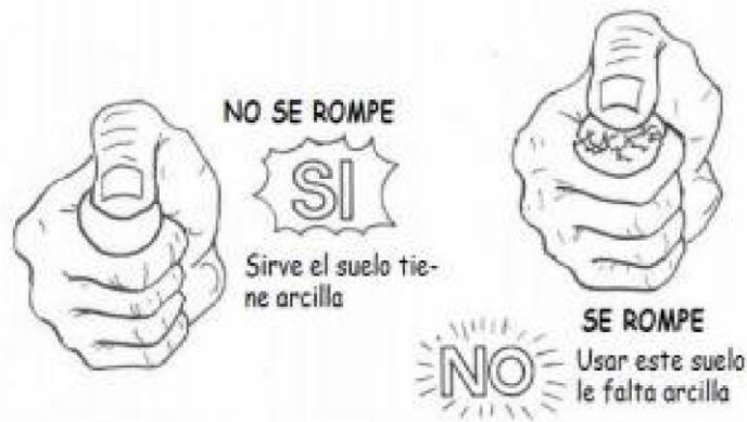
Figura. 1: Ensayo de Resistencia Seca. Fuente: Blondet y García, 2003.
