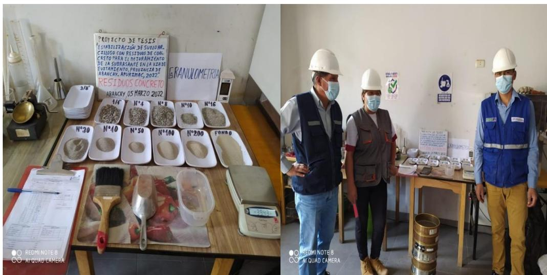
**Figura 32. Análisis granulométrico de residuos de concreto, según ASTM D-422, MTC E 107**
