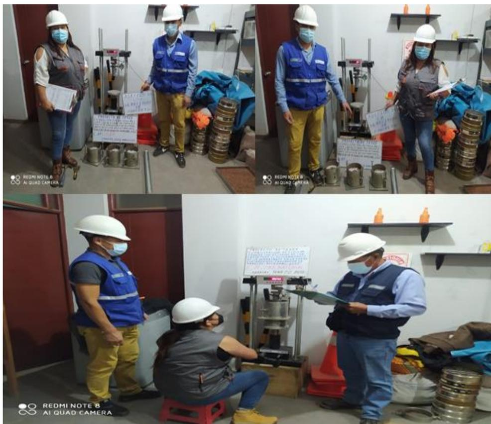
**Figura 37. Análisis de CBR de suelos naturales con adición de 5%, 10% y 15% de RC, según ASTM D-1883, MTC E 132 y NTP 339.145**
