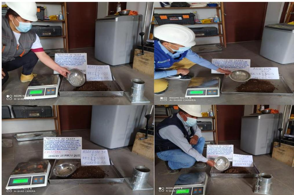
**Figura 36. Proceso de compactación de suelo natural con adición de 0%, 5%, 10% y 15% de RC, según ASTM D-1557, MTC E 115, AASTHO T180 y NTP 339.141**
