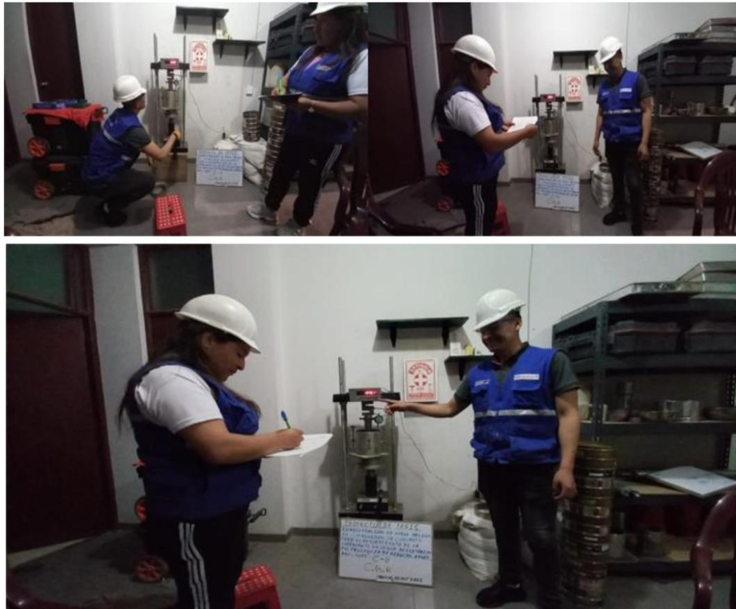
**Figura 38. Proceso de ensayo CBR, en estado natural y con porcentaje de RC (0%, 5%, 10%, 15 %), según ASTM D-1883, MTC E 132 y NTP 339.145**
