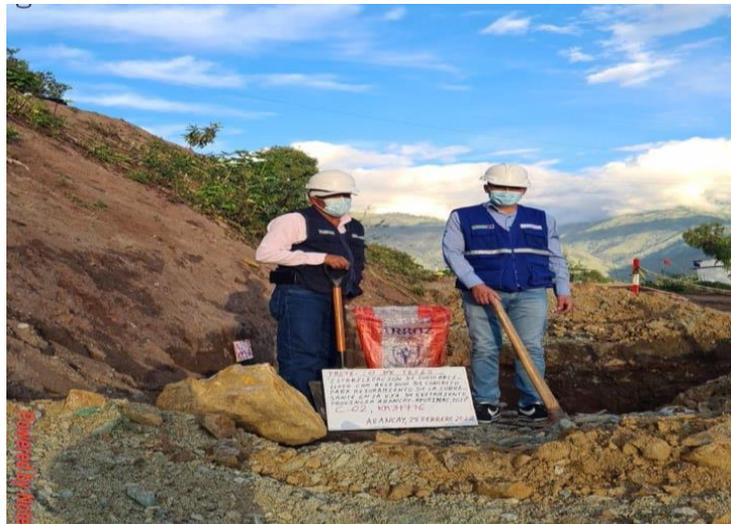
**Figura 27: Calicata C2, km 3+776, según ASTM D 420 y MTC E 101 (UTM - 13.632530593541418 norte, -72.90300279340312 este)**
