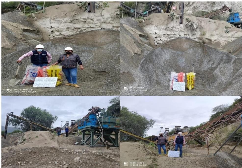
**Figura 25. Trituración de residuos de concreto en la cantera La sorpresa (UTM - 13.647897024569449 norte, -72.9149840837727 este)**
