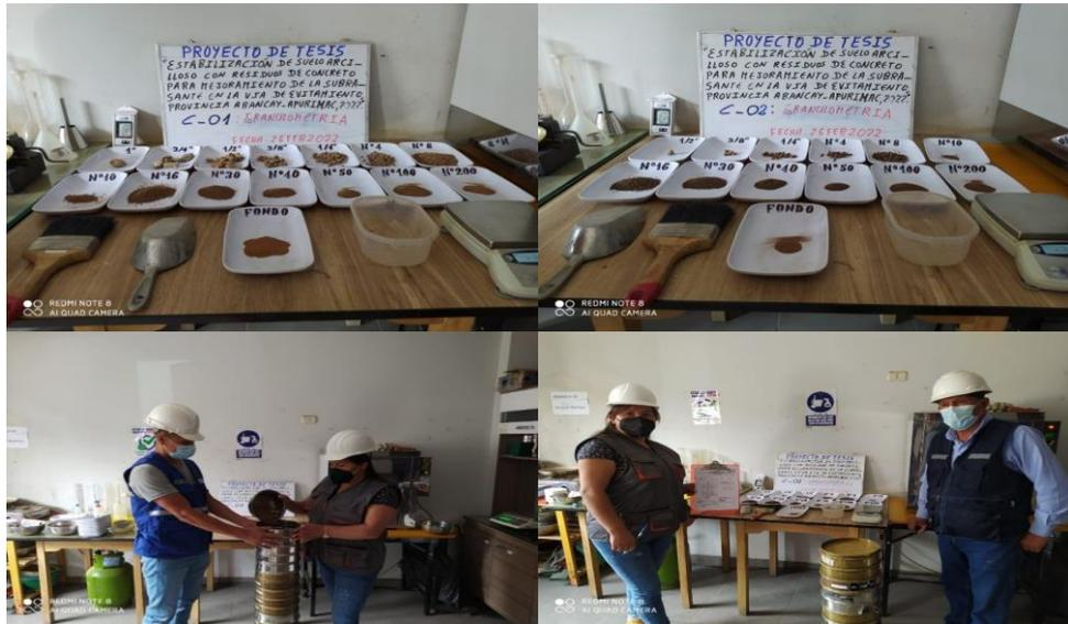
**Figura 31. Análisis granulométricos de las calicatas C1, C2, C3, C4, C5, C6, C7, C8 y C9 de muestra patrón, según ASTM D-422 y MTC E 107.**
