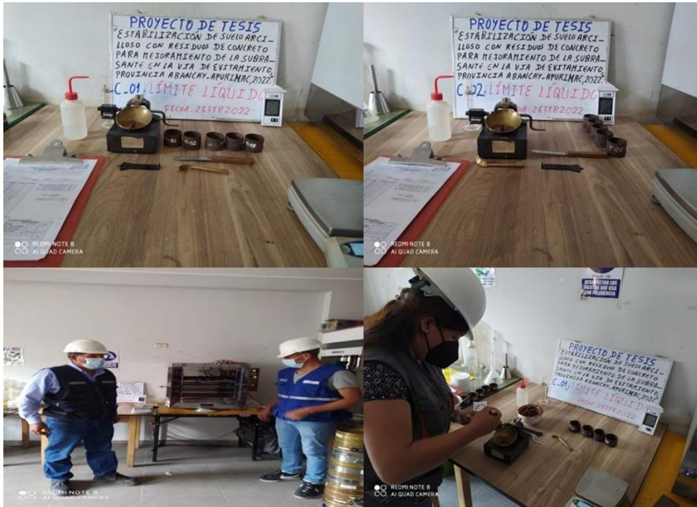
**Figura 33. Análisis de Límite Líquido natural de las calicatas (C1, C2, C3, C4, C4, C5, C6, C7, C8 y C9), según ASTM D-4318, MTC E 110 y NTP 339.129**
