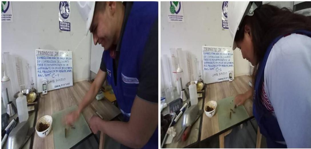
**Figura 34. Análisis de límite plasticidad del suelo natural con la adición de 0%, 5%, 10% y 15% de RC, según ASTM D 4318, MTC E 111 y NTP 339.129**
