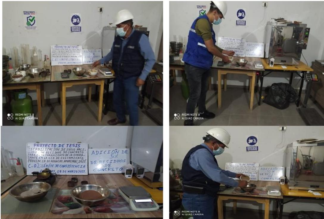
**Figura 35. Análisis de límites de consistencia del suelo natural con adición de 0%, 5%, 10% y 15% de RC, según ASTM D-4318, MTC E 110, MTC E 111 y NTP 339.129**
