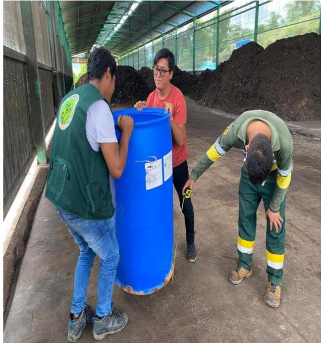
Pesaje para la obtención de datos para determinar la densidad
