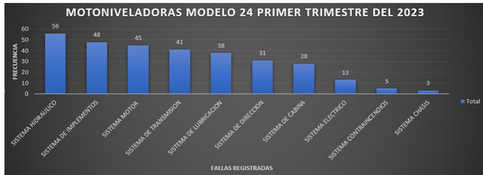
Figura 30. Fallas registradas y su frecuencia en el primer trimestre del año 2023 como referencia a la operatividad de los equipos
