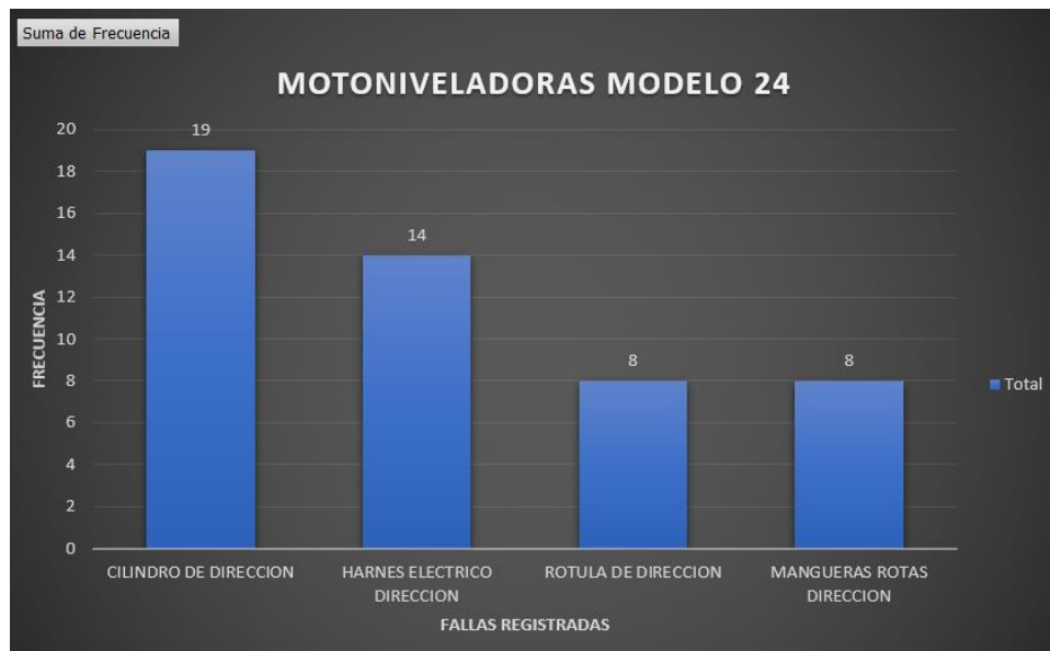
Figura 18. Se presenta las fallas registradas y su frecuencia en las motoniveladoras modelo 24.
