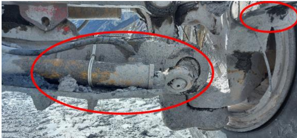
Figura 16. Cilindro de dirección descolgado tras la caída de la rótula de dirección
