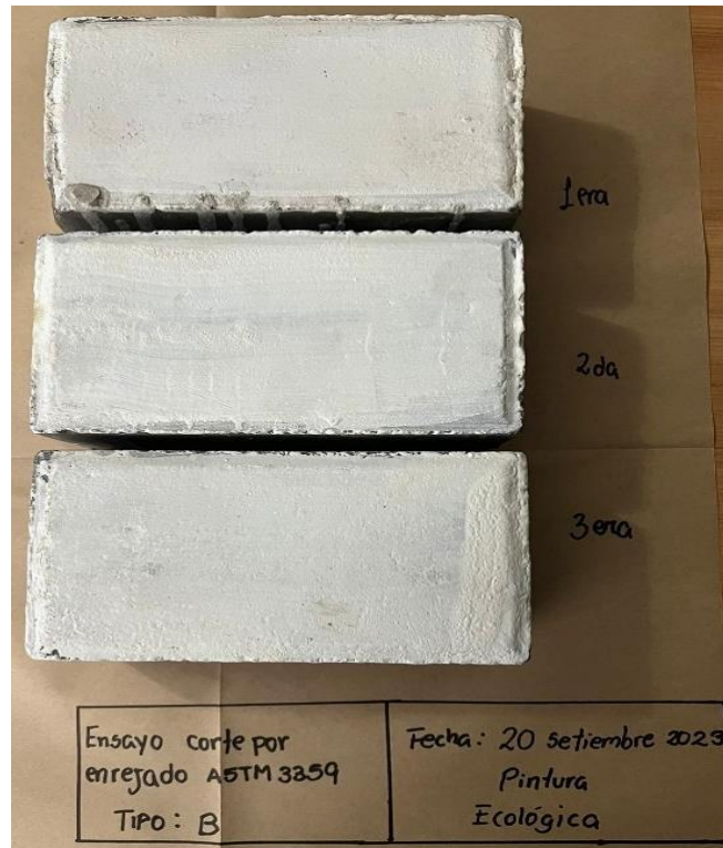
Figura 16. Verificación de ensayo de corte por enrejado
