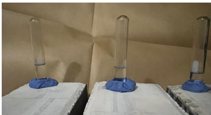
Figura 27. Prueba de permeabilidad con tubos de ensayo
