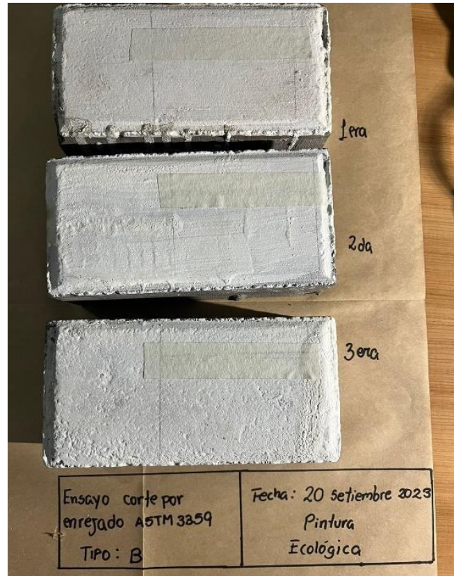
Figura 15. Ensayo de corte por enrejado ASTM 3359 (30 segundos)
