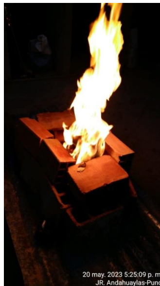
Figura 14 Proceso de Quema para el Cartón Reciclado temperatura que oscila entre 400° y 1100°C
