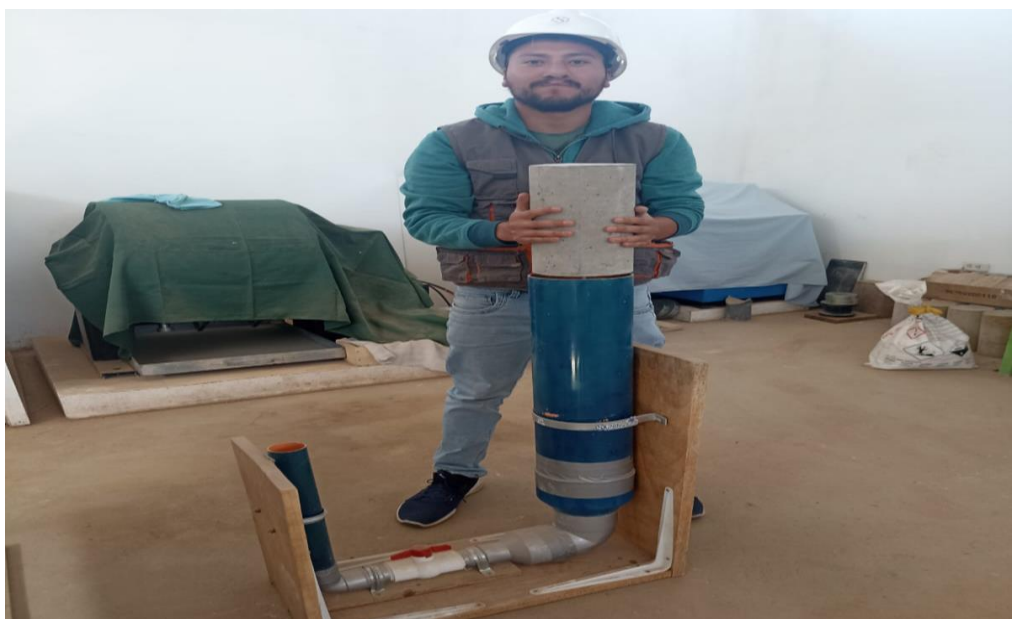
FOTOGRAFÍA 06. ENSAYO DE PERMEABILIDAD “MÉTODO DEL PERMEÁMETRO DE CABEZA DESCENDIENTE”
