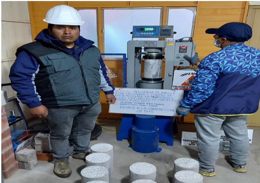
FOTOGRAFÍA 05. ROTURA DE MUESTRAS POR COMPRESIÓN
