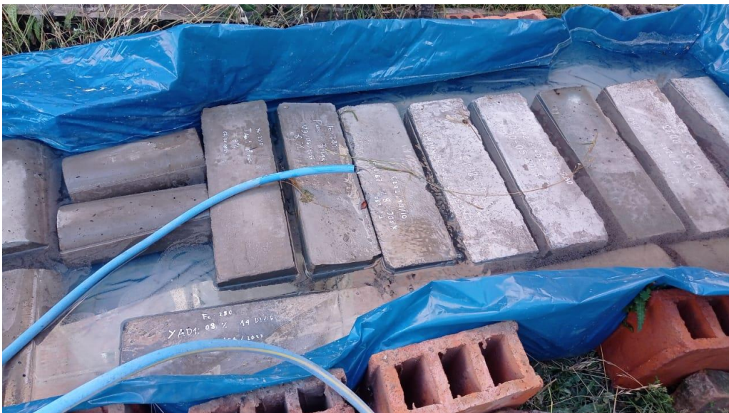
FOTOGRAFÍA 04. CURADO DE MUESTRAS PARA PRUEBAS DE COMPRESIÓN Y FLEXIÓN
