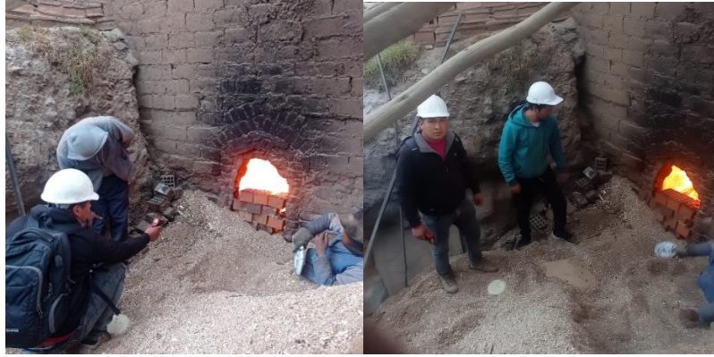
Figura 13 Horno Artesanal midiendo la temperatura donde oscila entre 800 y 1300°C
