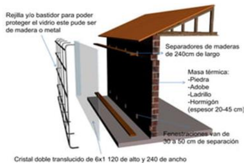
Figura 168. Muro trombe – sistema de instalación Fuente: https://es.slideshare.net/cfloresd/muro-trombe-3694723
