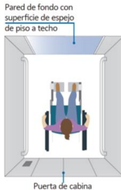
Figura 16. Ubicación de espejo en cabina de ascensor Fuente: Norma técnica A. 120, RNE (72)
