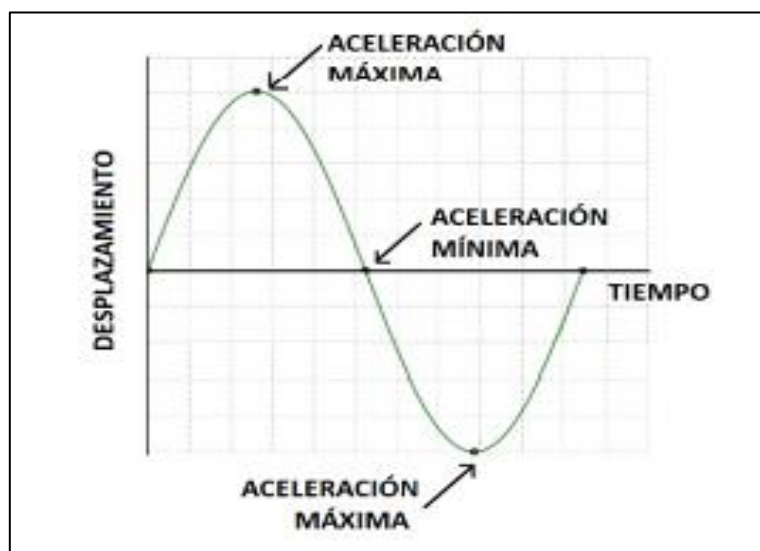
Figura 6. Representación visual número 6 que ilustra la aceleración de un objeto en vibración. Tomada de «Introducción al Análisis de Vibraciones», por White (1).
