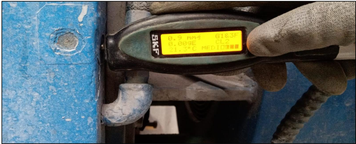
Figura 9. Recolección de datos: vibraciones y mediciones eléctricas de las maquinarias. Usando el medidor de vibraciones tipo pluma CMAS 100 SKF
