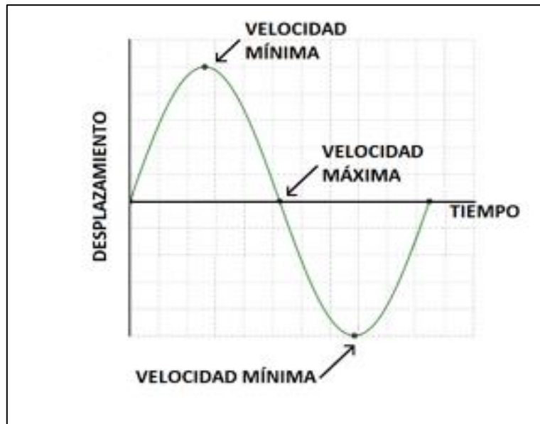
Figura 5. Representación visual de la velocidad de un objeto en vibración. Tomada de «Introducción al Análisis de Vibraciones», por White (1).
