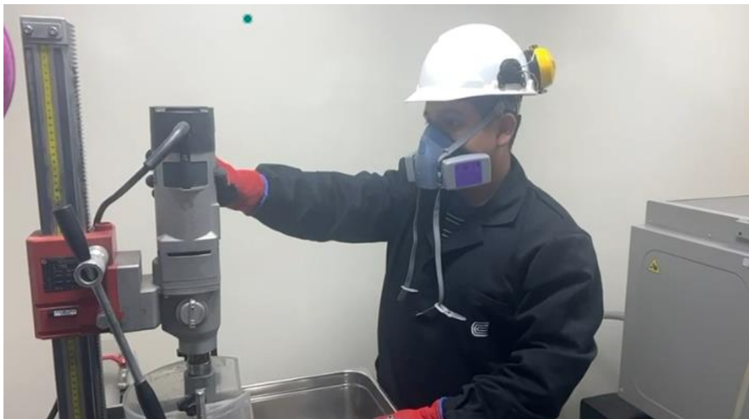
Extracción de testigos
