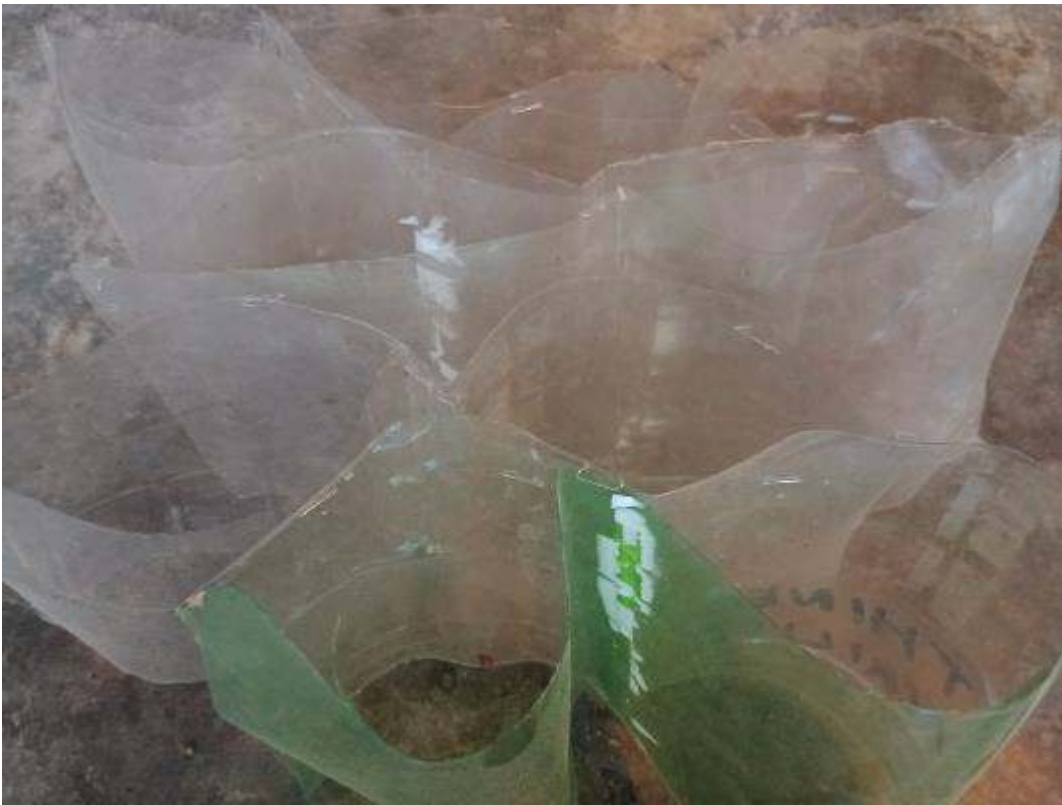
Anexo 7 Armado de geoceldas de botellas PET diámetro de 10cm y altura 15cm
