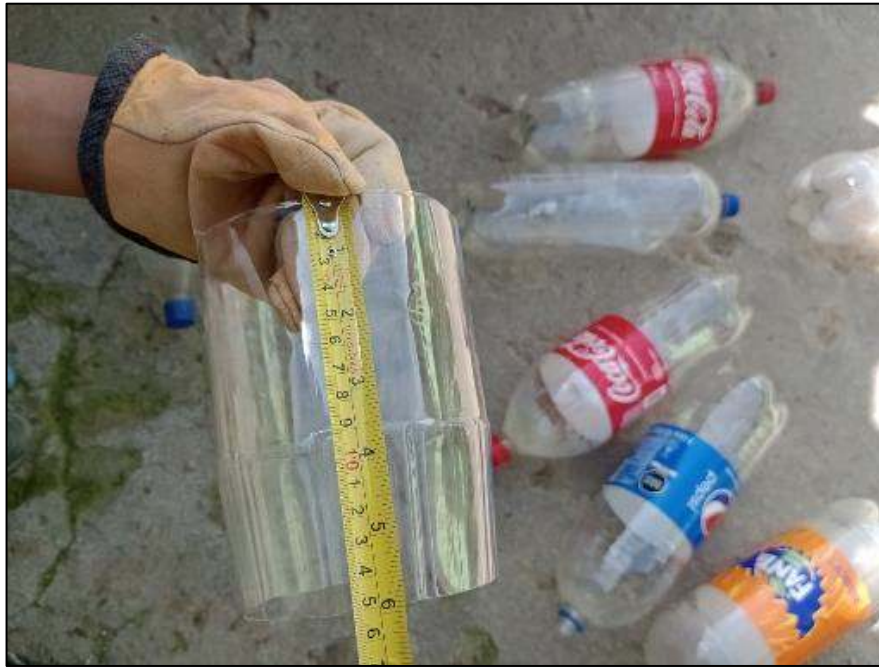
Figura 12 Medición y corte de las botellas PETS de 5, 10 y 15 cm para armar las geoceldas.
