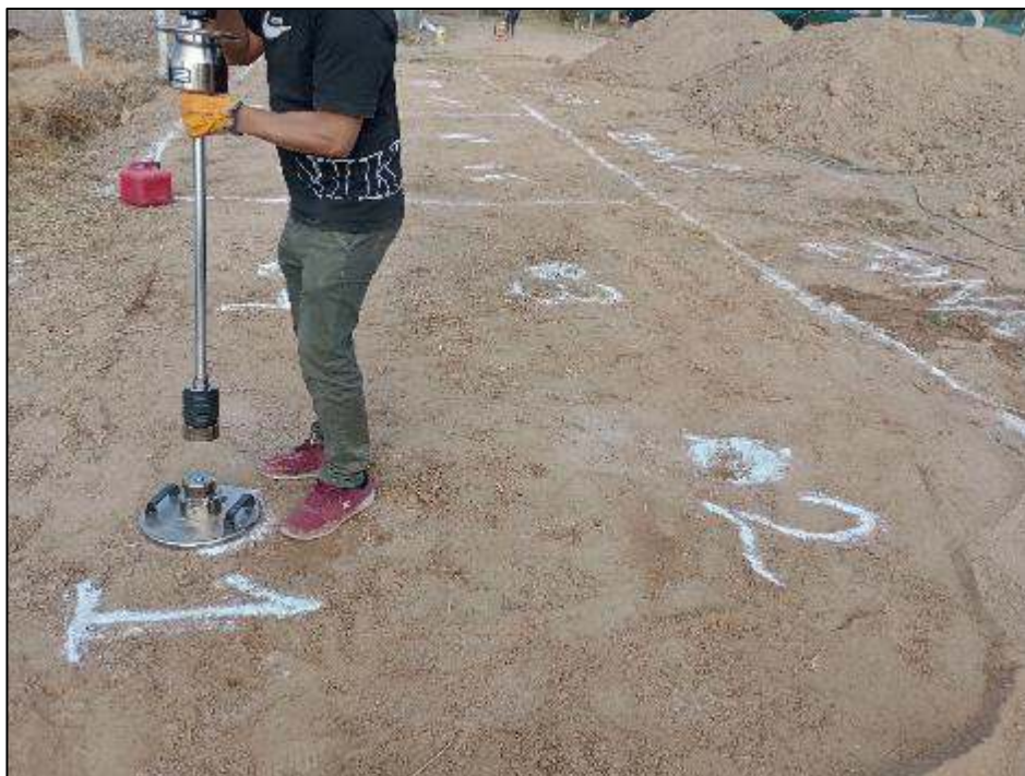
Figura 11 Medición de los puntos con el deflectómetro de impacto dentro de los tramos marcados.
