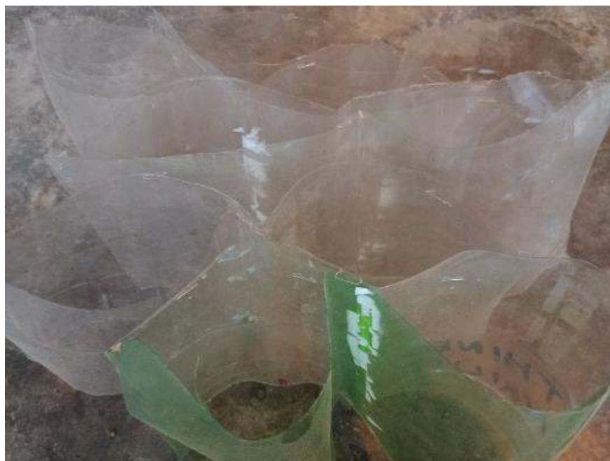
Figura 13 Vista de la geocelda armada tipo panal de botellas de plástico.
