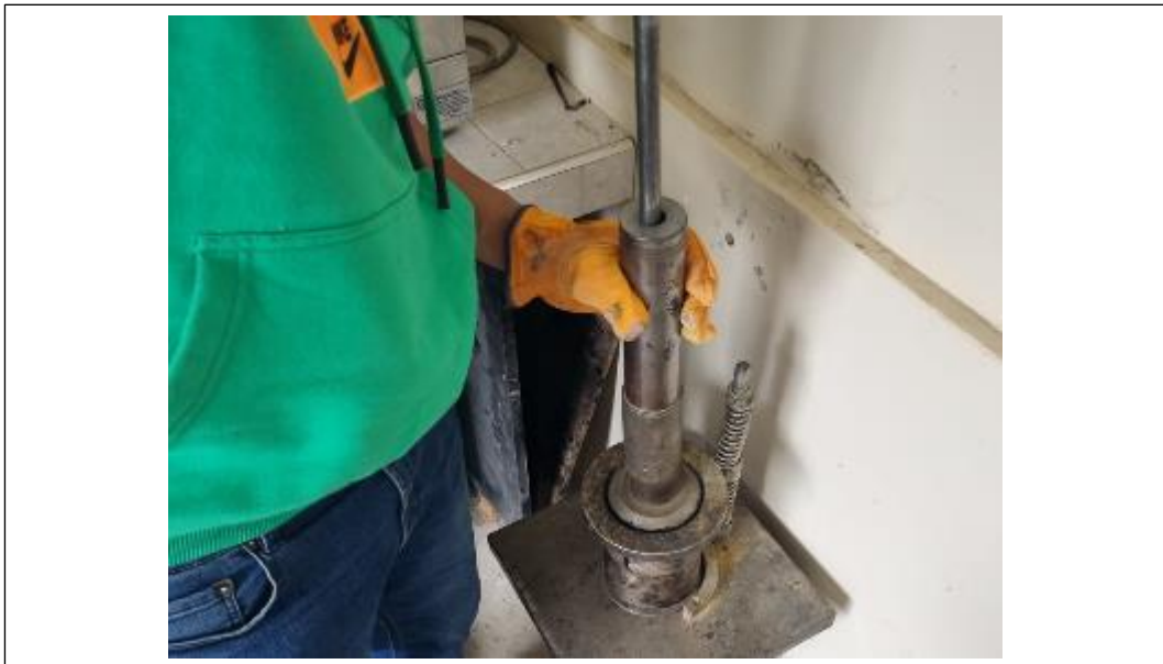
Anexo 9: Se compacta la mezcla a 75 golpes cada cara
