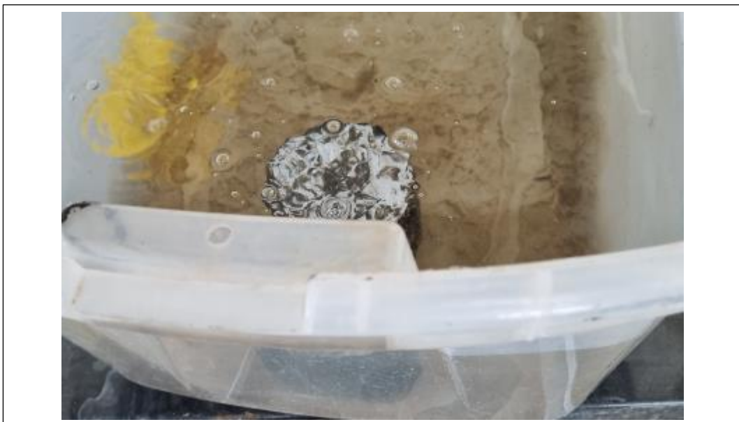
Anexo 14: Se coloca cada briqueta en el recipiente con agua por media hora, se seca superficialmente y se registra el peso superficialmente seco
