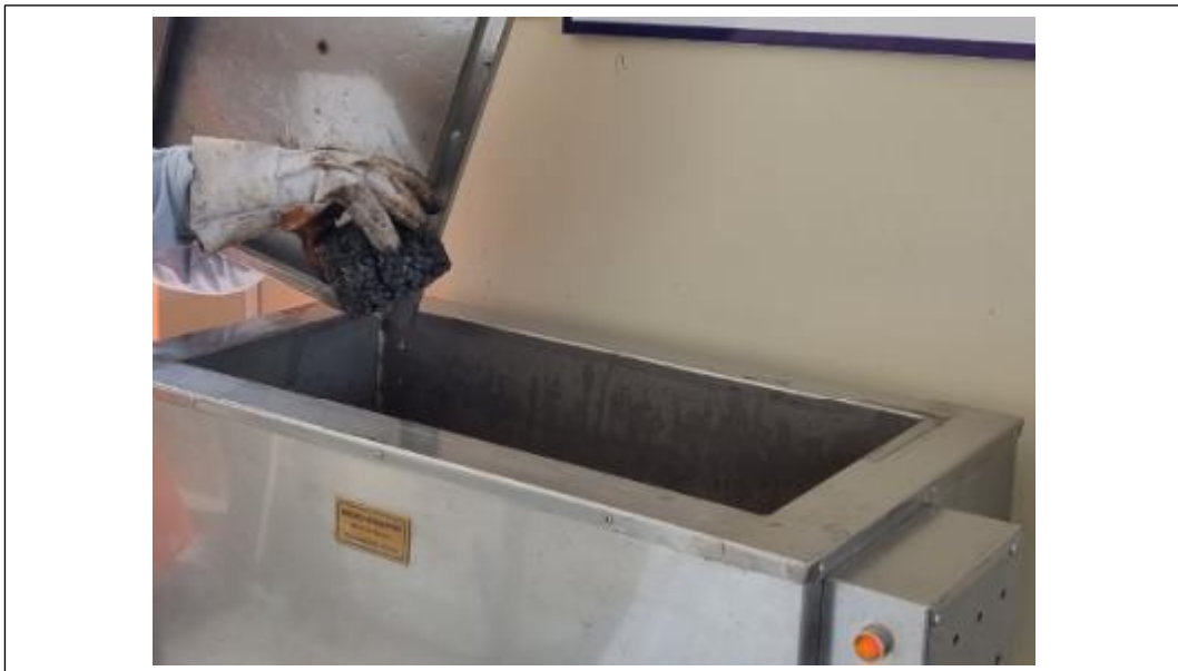
Anexo 16: Se acondicionan las briquetas en baño María a una temperatura de 60°C
