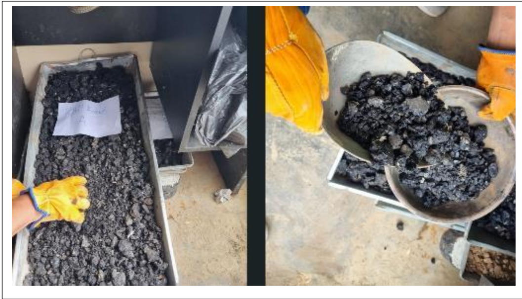
Anexo 19: Para el ensayo de lavado asfáltico, se obtiene una muestra de 1000 gr de material reciclado del pavimento de 15 años de edad (RAP edad "A")
