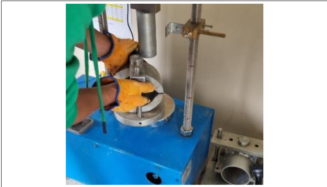
Anexo 35: Se coloca la briqueta en la mordaza para el ensayo de TSR y se roturan las muestras para registrar las cargas máximas
