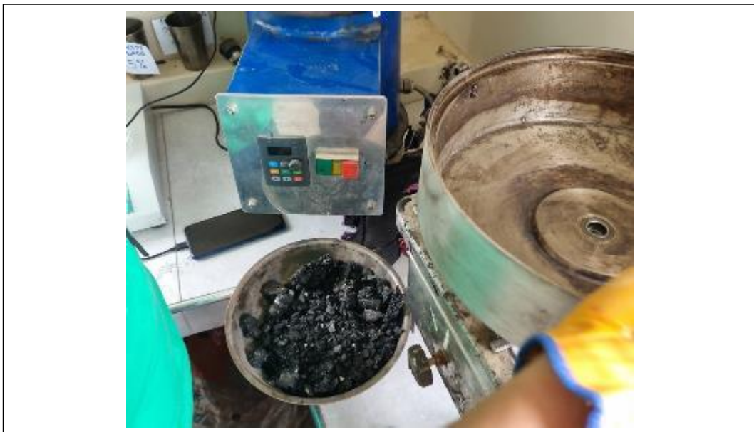
Anexo 24: Se prepara la muestra de 1000 gr para colocarla en la máquina de centrifugado
