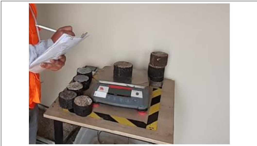
Anexo 12: Se pesa cada briqueta y se registran los pesos como peso seco
