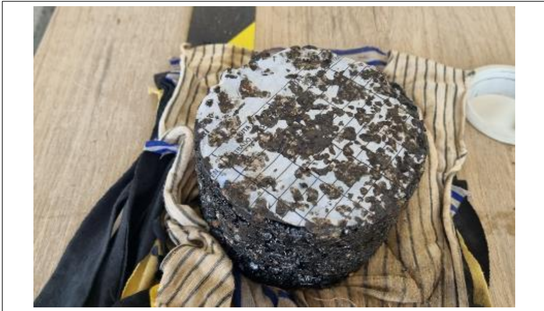
Anexo 15: Cada briqueta se seca superficialmente y se registra el peso superficialmente seco
