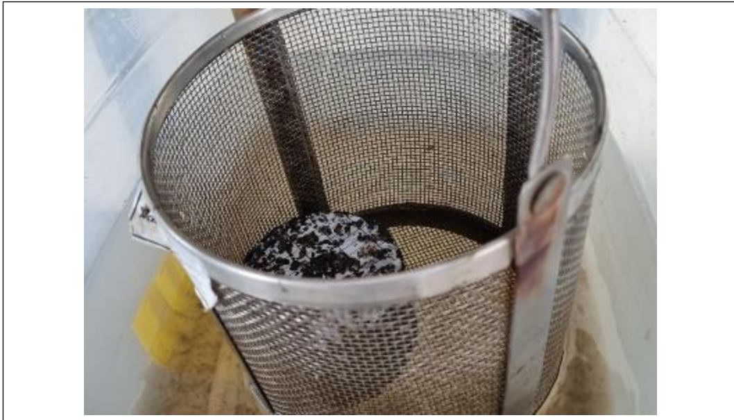
Anexo 13: Se coloca cada briqueta en una canastilla dentro de un recipiente con agua y se registra el peso sumergido
