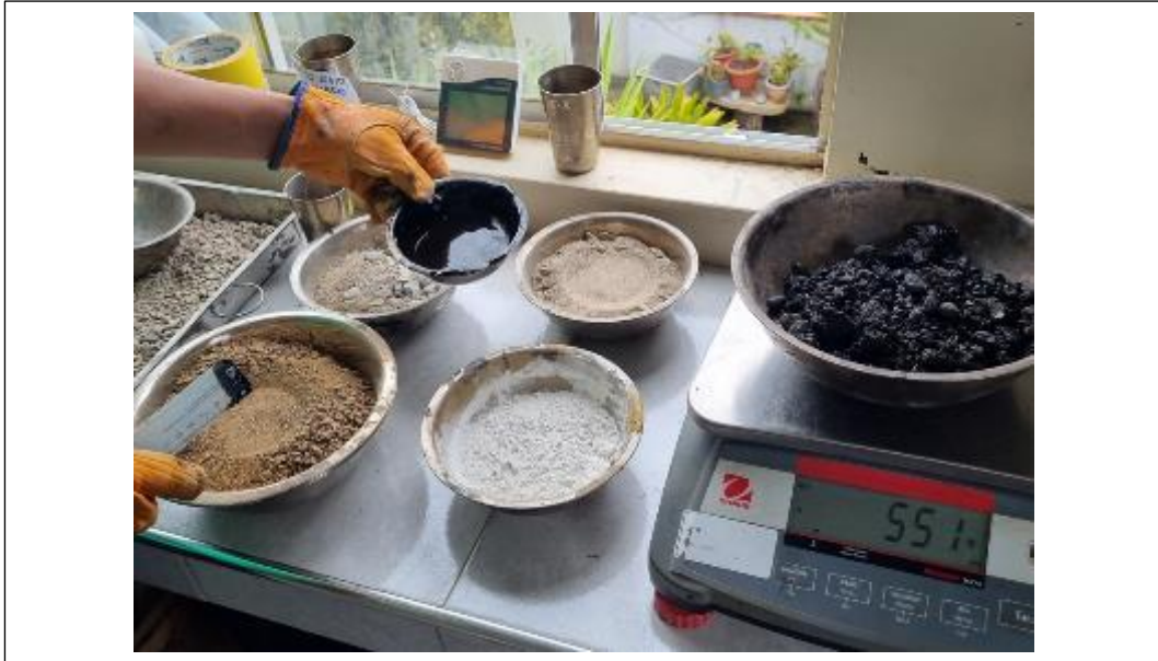
Anexo 27: Se procede a elaborar un nuevo grupo de briquetas al incorporar a la mezcla asfáltica el 0%, 10%, 20% y 30% de RAP
