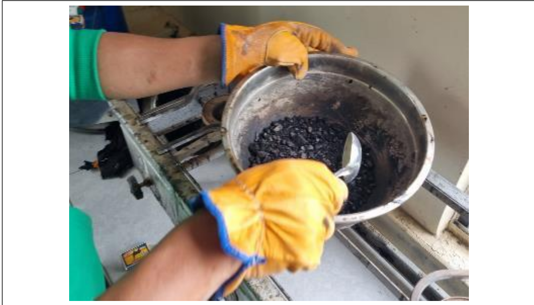
Anexo 7: Se coloca la mezcla de agregados en un recipiente y se calienta a 150°C para la mezcla con el cemento asfáltico en distintos porcentajes del peso total
