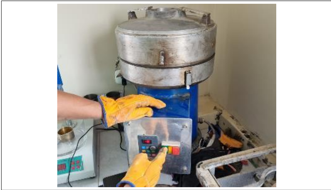
Anexo 23: Máquina de centrifugado para el lavado asfáltico
