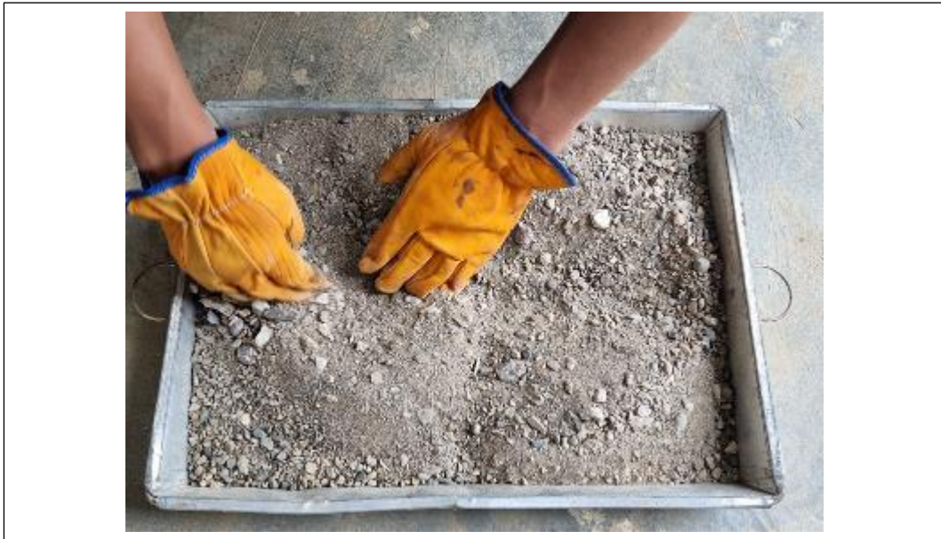
Anexo 1: Muestra de agregado fino, arena natural y arena chancada obtenida de la cantera de Sicaya
