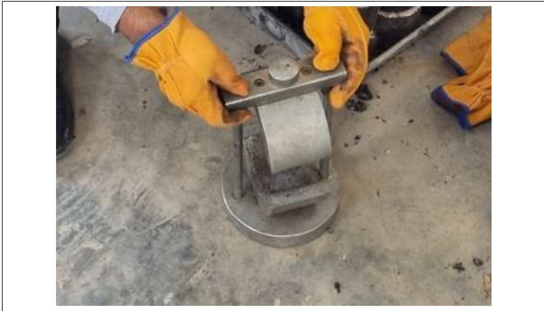
Anexo 17: Se coloca cada briqueta en una mordaza para el ensayo de Marshall según las especificaciones de la norma MTC E 504
