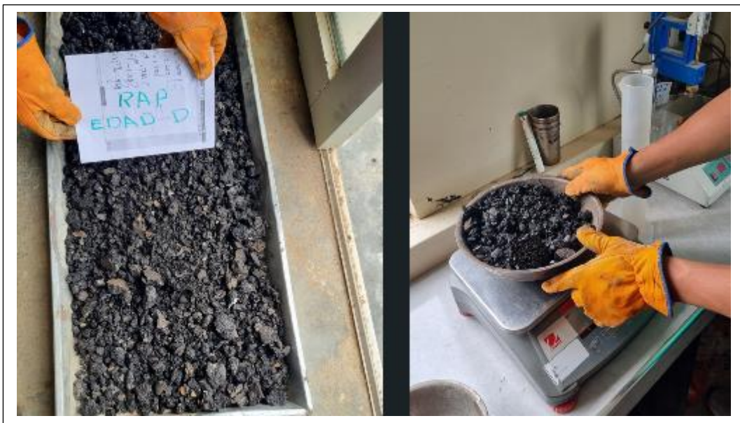
Anexo 22: Para el ensayo de lavado asfáltico, se obtiene una muestra de 1000 gr de material reciclado del pavimento de 30 años de edad (RAP edad "D")
