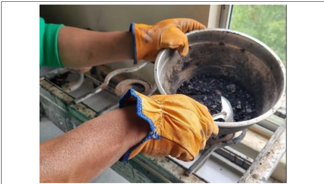
Anexo 28: Se procede con elaborar la mezcla asfáltica en caliente al incorporar distintos porcentajes de RAP
