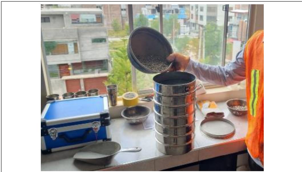
Anexo 4: Se coloca la muestra en la serie de tamices para el ensayo de análisis granulométrico y se procede a tamizar la muestra manualmente
