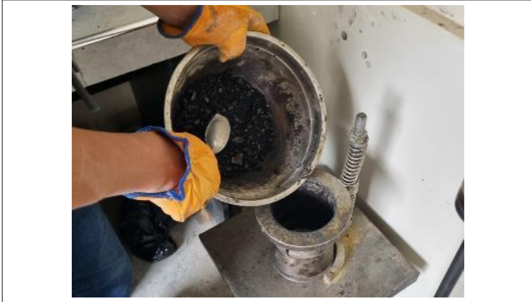
Anexo 8: La mezcla asfáltica resultante se coloca en el molde para la elaboración de las briquetas, habiendo colocado previamente un papel filtro
