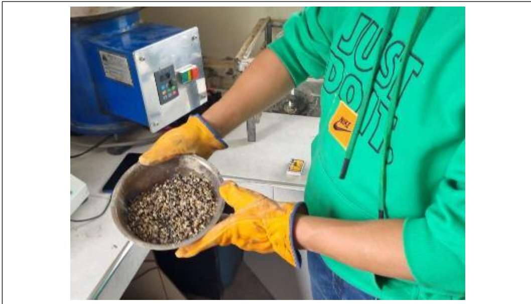
Anexo 25: Tras realizar el lavado asfáltico, se presenta el agregado de RAP resultante para cada material de diferentes edades
