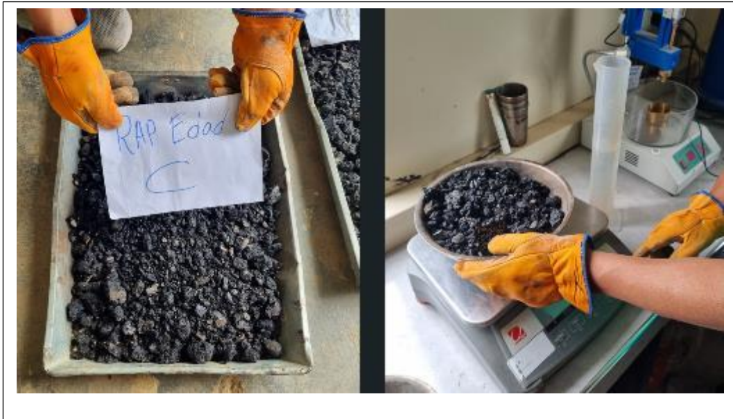
Anexo 21: Para el ensayo de lavado asfáltico, se obtiene una muestra de 1000 gr de material reciclado del pavimento de 25 años de edad (RAP edad "C")
