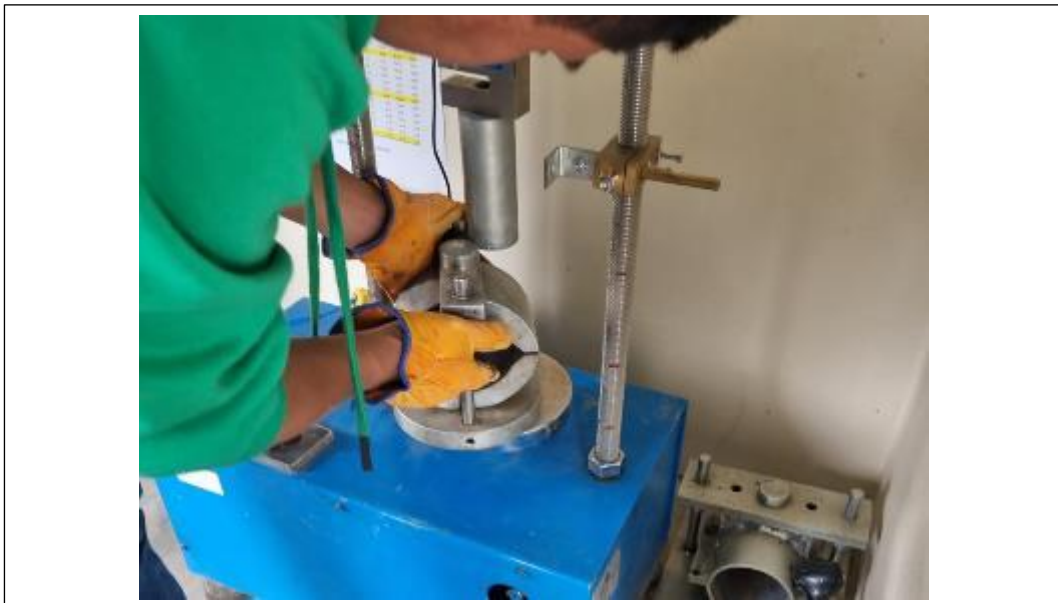
Anexo 18: Se coloca la mordaza en la prensa de Marshall y se procede a lecturar los diales de deformación y de carga
