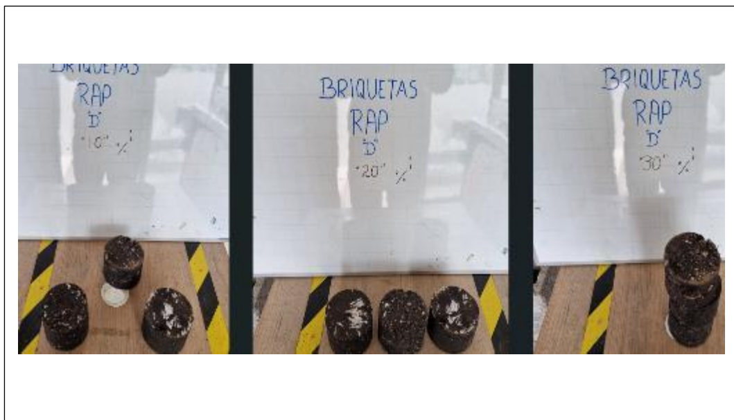
Anexo 32: Briquetas resultantes al incorporar RAP "A" en distintos porcentajes de 10%, 20% y 30%
