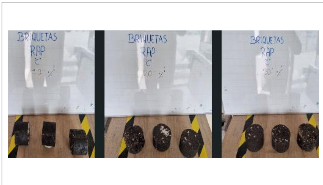
Anexo 31: Briquetas resultantes al incorporar RAP "C" en distintos porcentajes de 10%, 20% y 30%
