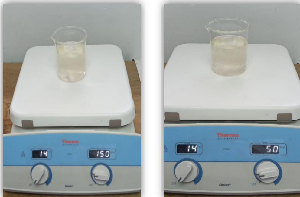
Figura 18 Velocidad rápida a 150 RPM y velocidad lenta a 50 RPM.
