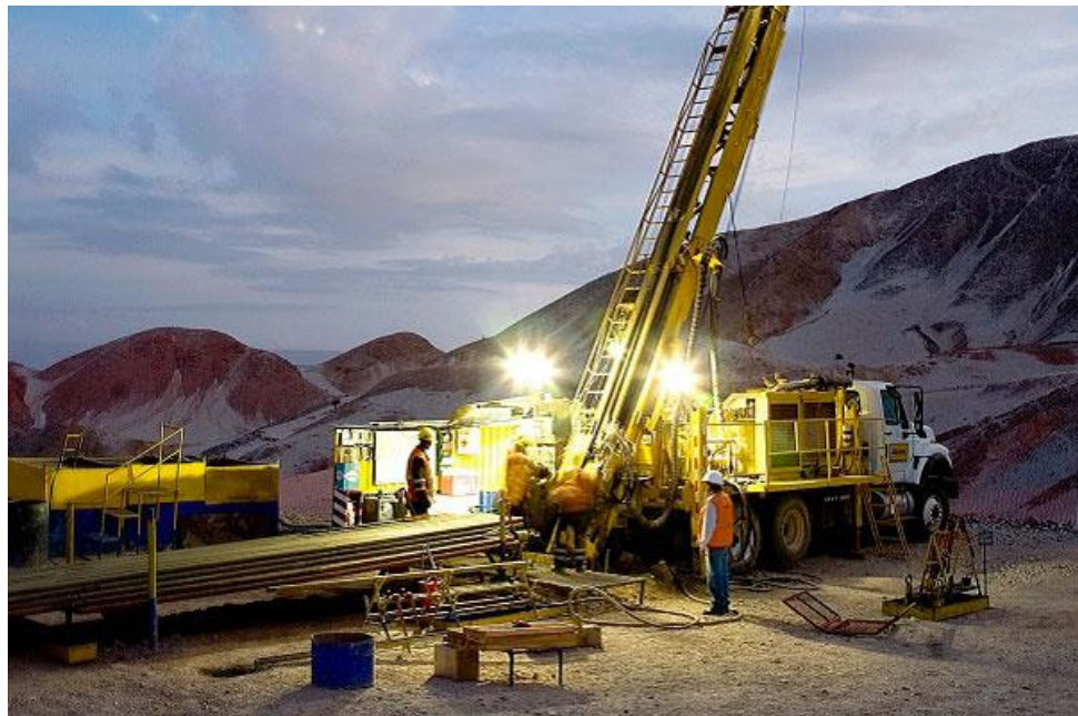
Figura 3. Máquina perforadora de diamantina. Tomada de «Perforación diamantina del proyecto Berenguela: Presentan resultados finales», por Tiempo Minero J.V. 2022.
