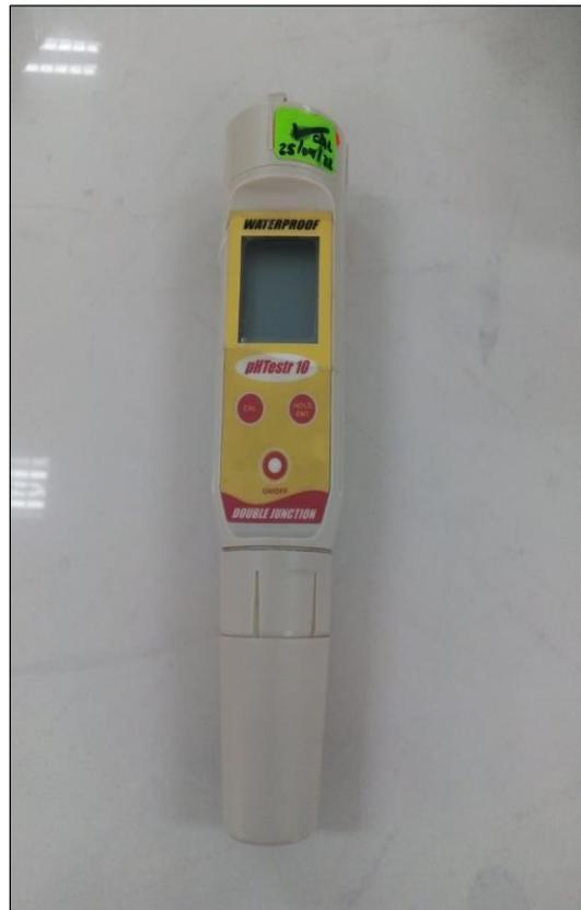
pHTestr usado para medir el pH de las muestras de agua residual sometido a tratamiento
