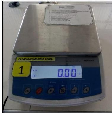
*Figura 25. Balanza electrónica para el pesado de las pencas y hojas de sábila*
