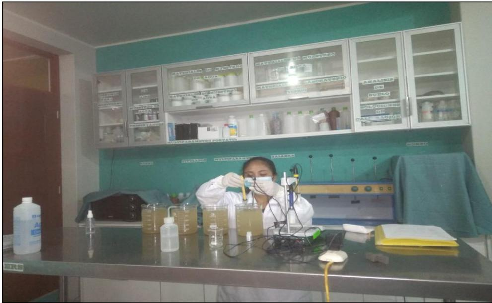
Medición de sólidos disueltos totales para determinar la dosis óptima de los coagulantes naturales
