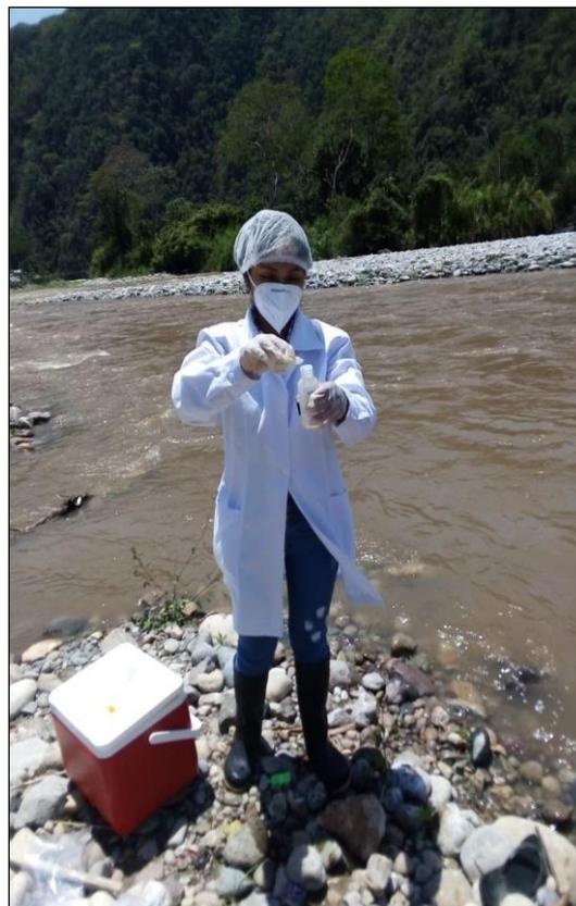
Aplicación del preservante ácido sulfúrico para el parámetro DQO
