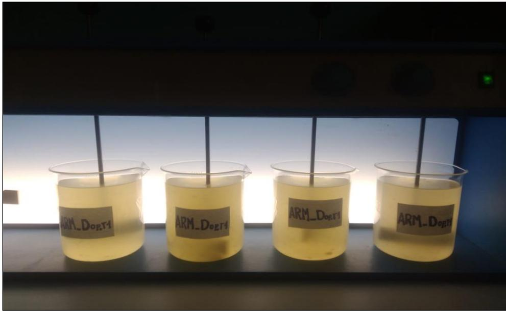
Segunda prueba preliminar de determinación de la dosis optima de los coagulantes naturales en el equipo Jar-Test
