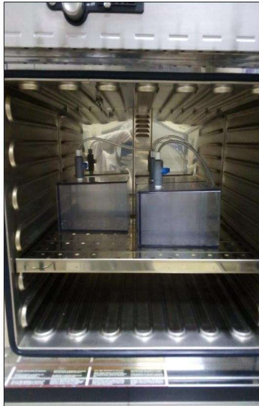
Esterilización de los vasos de precipitación del equipo Jar-Test
