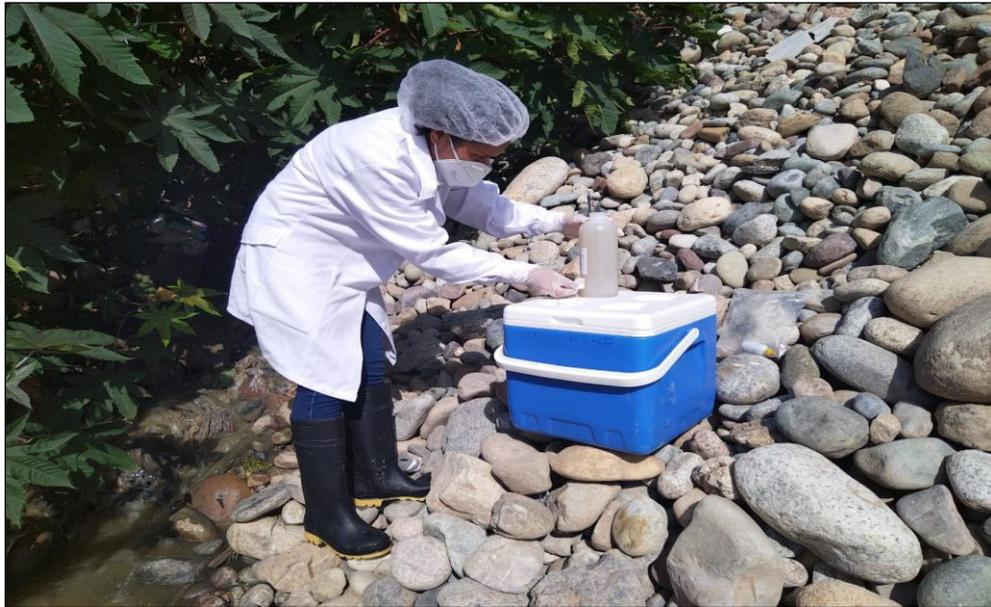
Toma de muestras de concentraciones iniciales de los parámetros coliformes termotolerantes, DBO<sub>5</sub>, DQO y turbiedad
