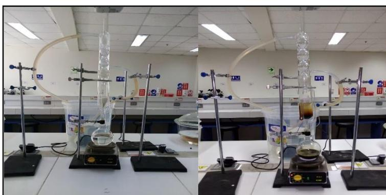
*Figura 33. Extracción de pigmentos de coagulante Aloe vera en el equipo Soxhlet*
