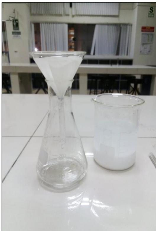
Preparación de solución de bicarbonato de sodio, para incrementar el pH del agua residual municipal a 8.5
