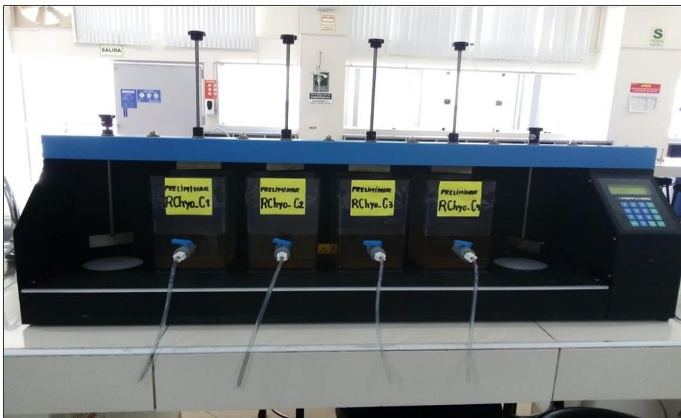
Primera prueba preliminar de determinación de la dosis óptima de los coagulantes naturales en el equipo Jar-Test
