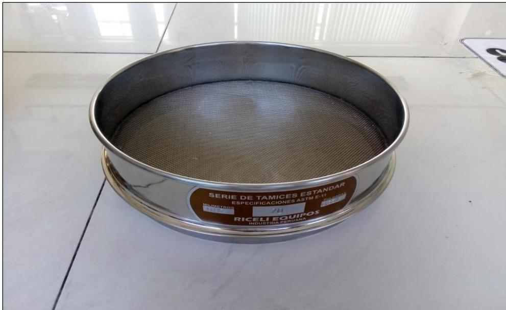
Tamizado del coagulante en polvo haciendo uso de un tamiz de 0.3mm
