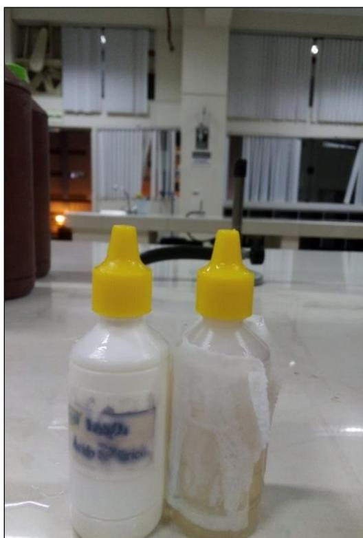
Uso de ácido sulfúrico para reducir el pH de la muestra de agua residual a 6
