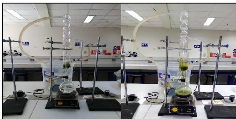
*Figura 32. Extracción de pigmentos del coagulante Opuntia ficus-indica en el equipo Soxhlet*
