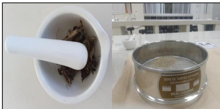
*Figura 31. Triturado y tamizado de las pulpas secas de tuna y sábila*
