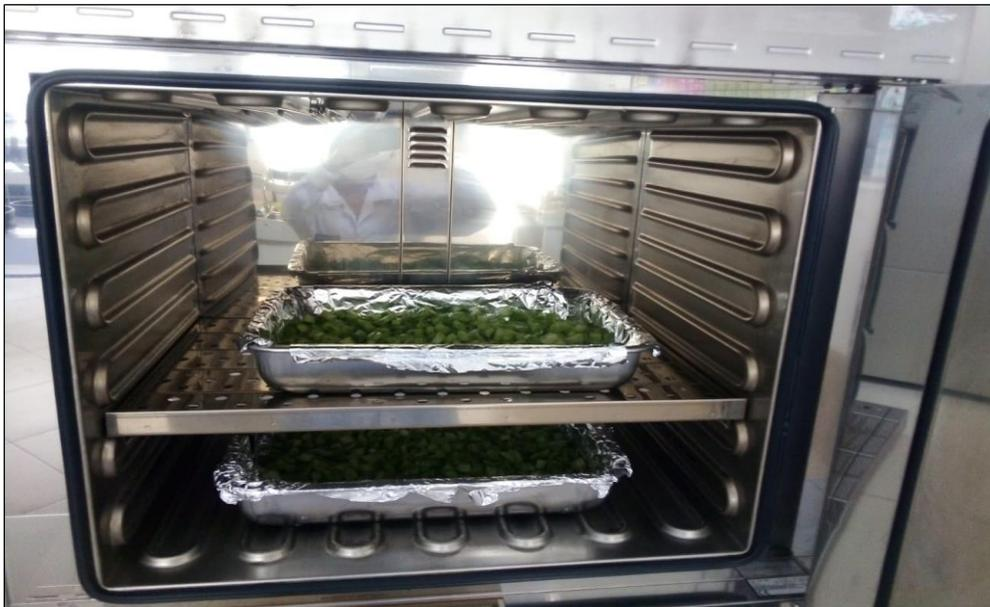
Trozado y secado de las pencas de tuna en la estufa a 120 °C por 48 horas
