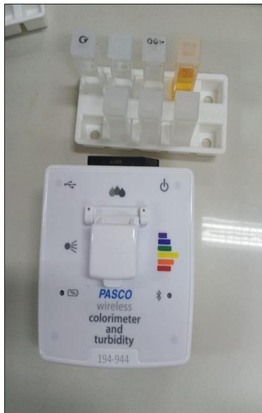
Turbidímetro, marca Pasco, para determinar la dosis optima en función a la reducción de turbidez del agua residual municipal sometido a tratamiento
