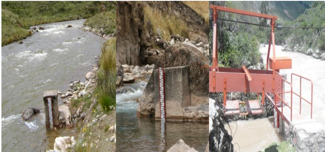
Figura 20. Estación de aforo de la regla linnimétrica: Canipaco, Yulapuquio y Quillón, en la Unidad Hidrográfica Canipaco – operadas por Electro Perú S.A.
