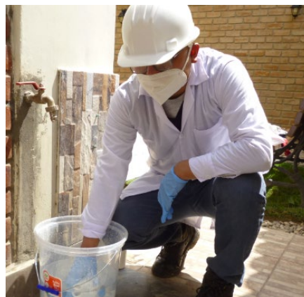
Ilustración 31: Recolección de muestra para parámetros físicos y químicos
