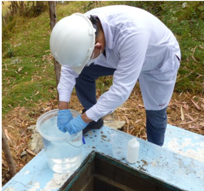
Ilustración 21: Recolección de muestra para parámetros físicos y químicos
