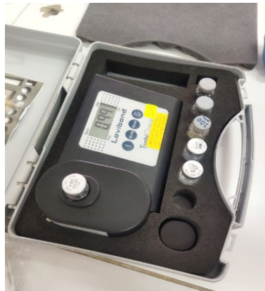
Ilustración 37: Calibración del turbidímetro
