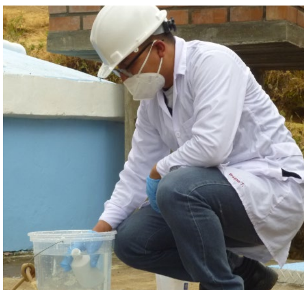
Ilustración 15: Recolección de la muestra para parámetros físicos y químicos
