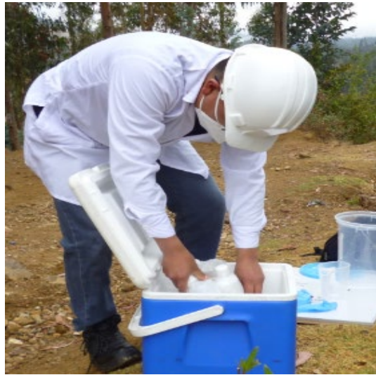
Ilustración 17: Preservación de las muestras en el cooler acondicionado
