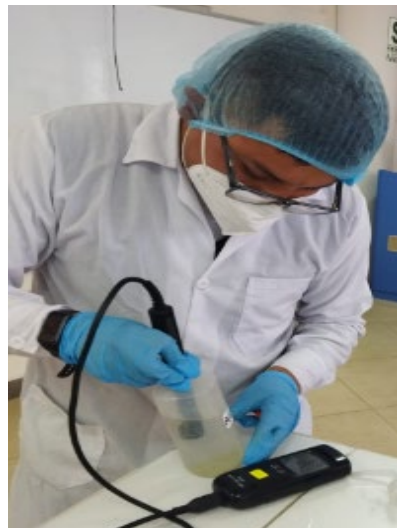
Ilustración 33: Calibración del Multiparámetro
