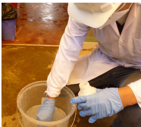
Ilustración 27: Recolección de muestra para parámetros biológicos
