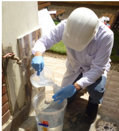
Ilustración 30: Recolección de muestra para parámetros biológicos
