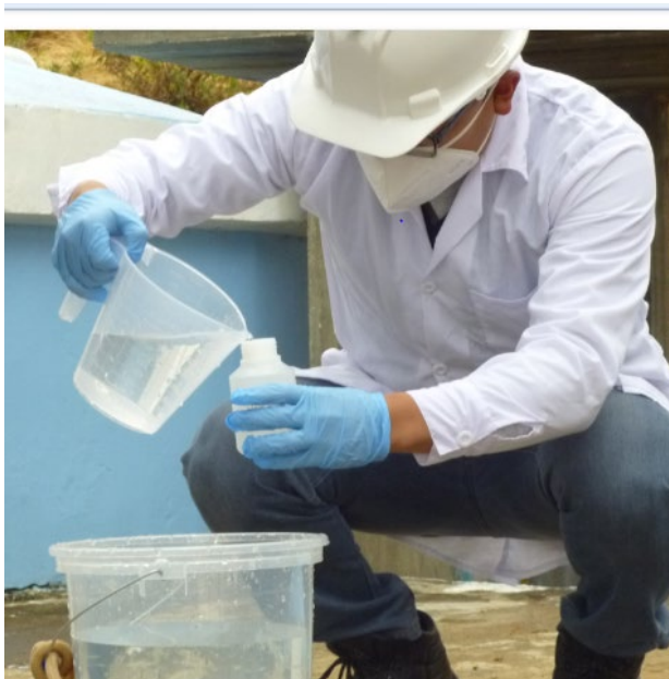
Ilustración 14: Recolección de la muestra para parámetros biológicos
