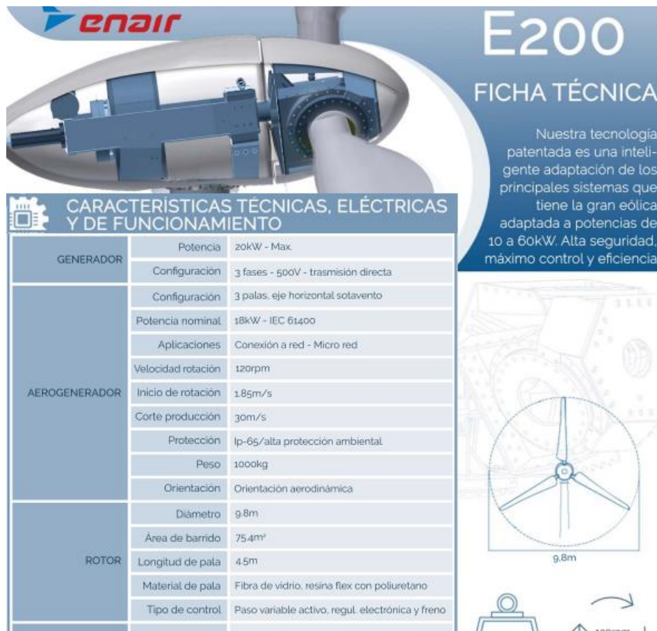
Figura 52: Características del aerogenerador E200
