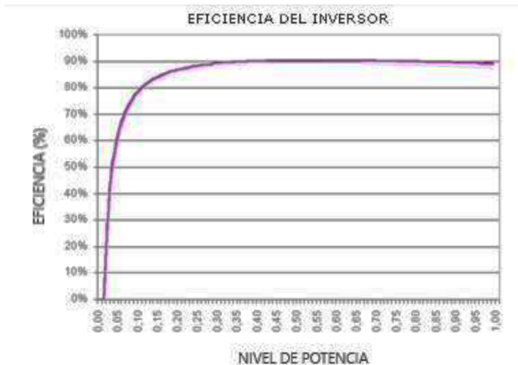
Figura 20. Curva típica de eficiencia de Inversor
