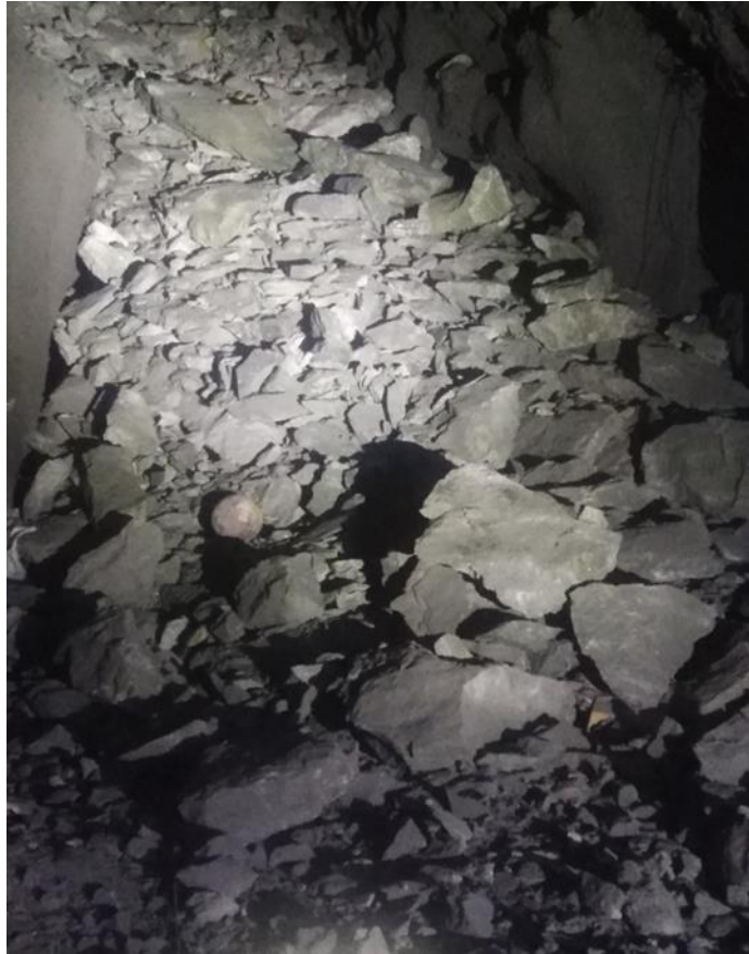
Figura 31. Granulometría post voladura, Tj 9653 – escenario base
