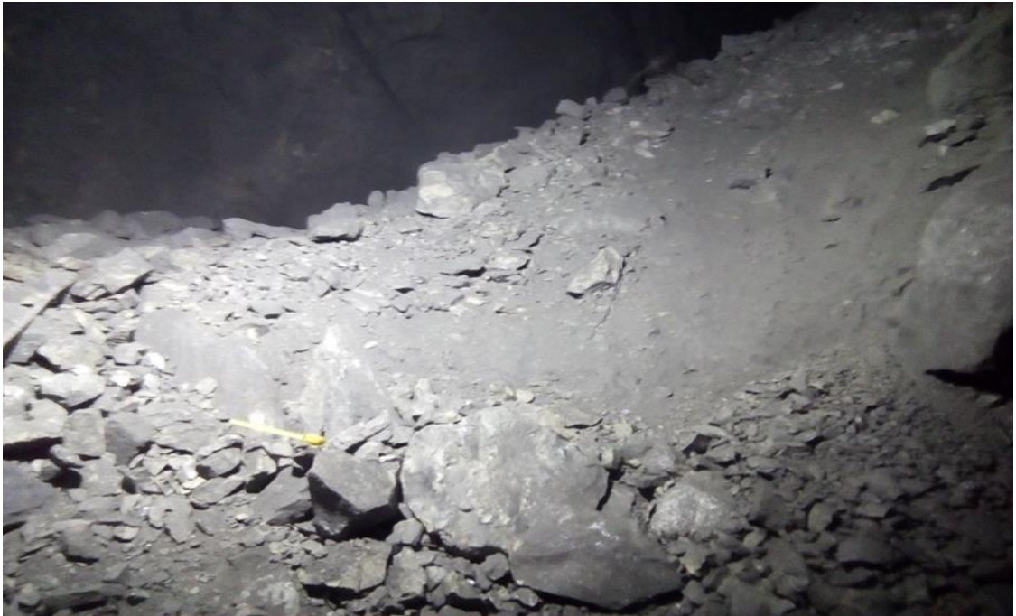
Figura 37. Granulometría post voladura, Tj 9790 – escenario base
