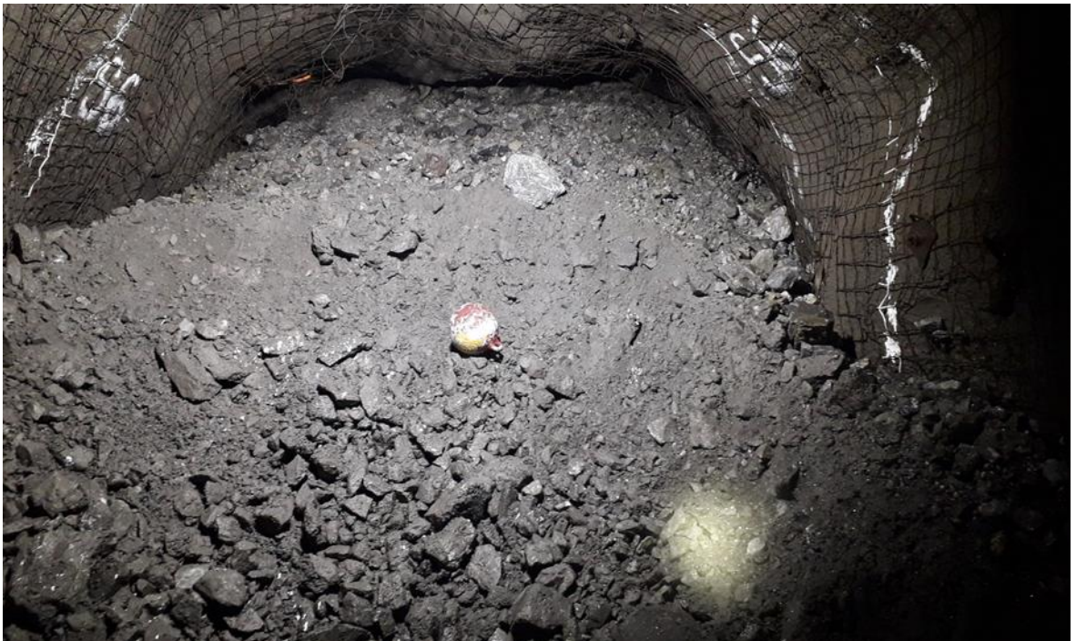
Figura 34. Granulometría post voladura, Tj 9653 – escenario optimizado.
