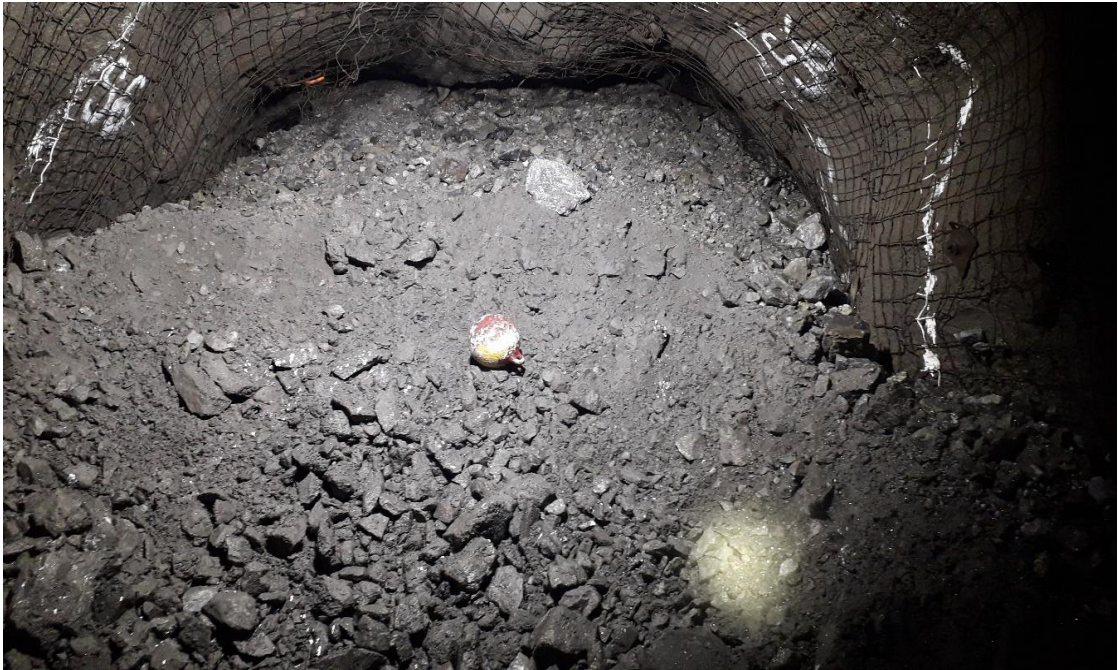
Figura 34. Granulometría post voladura, Tj 9653 – escenario optimizado
