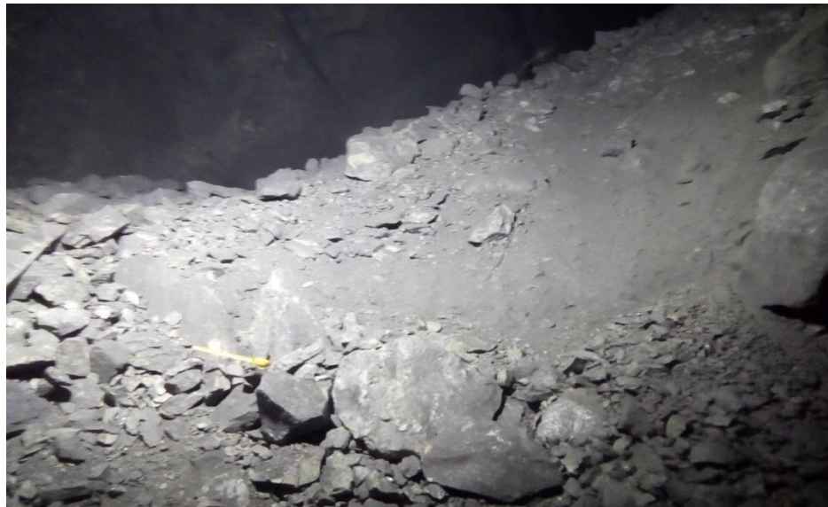
Figura 37. Granulometría post voladura, Tj 9790 – escenario base
