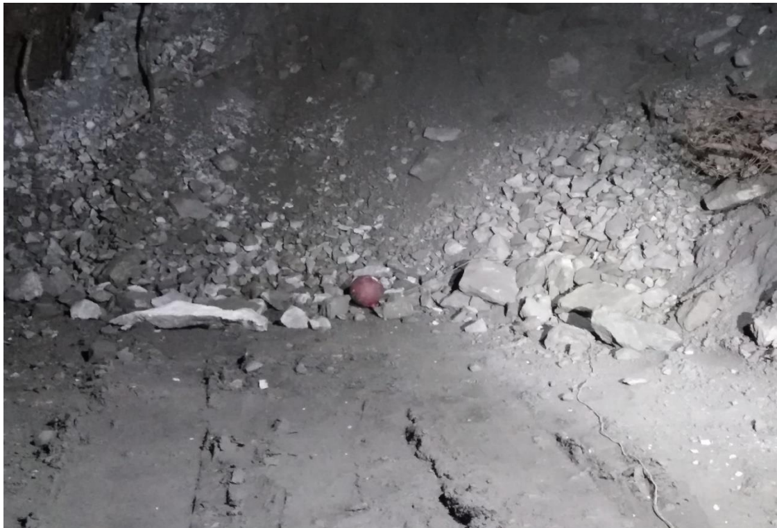
Figura 40. Granulometría post voladura, Tj 9790 – escenario optimizado
