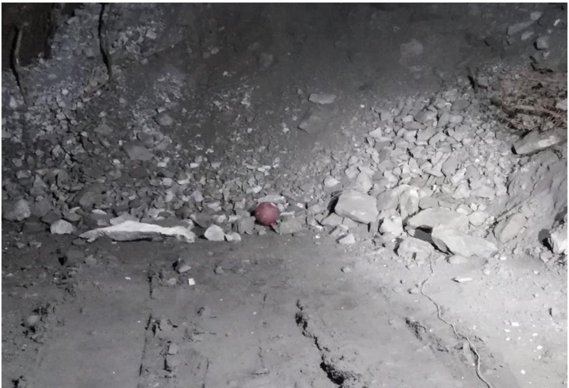
Figura 40. Granulometría post voladura, Tj 9790 – escenario optimizado
