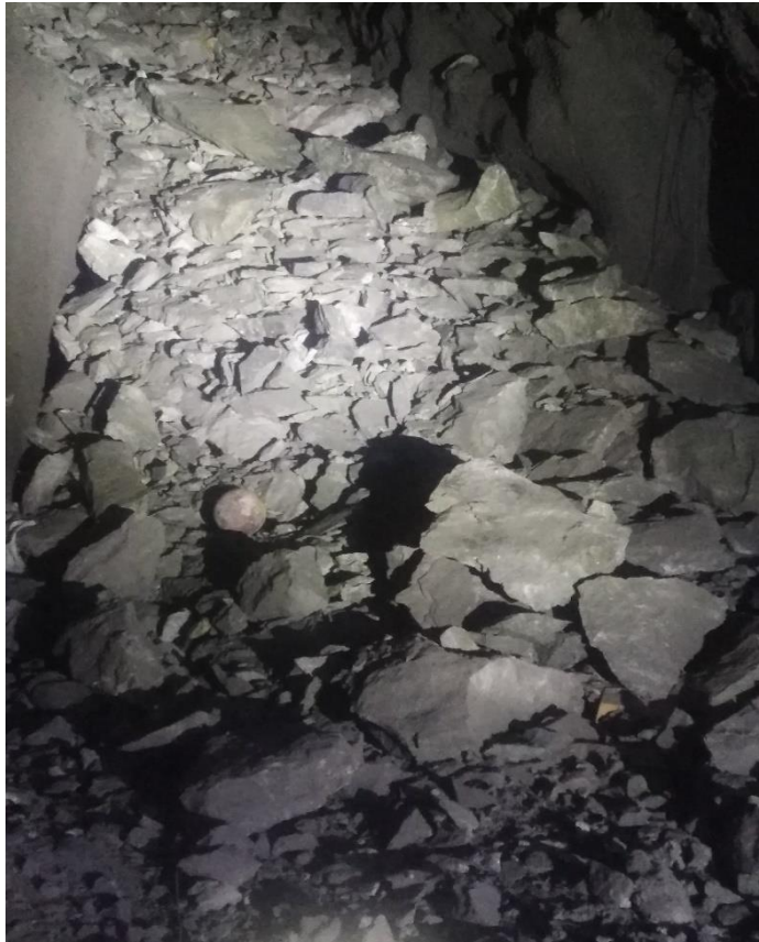
Figura 13. Incremento del tamaño de la granulometría, Tj 9653
