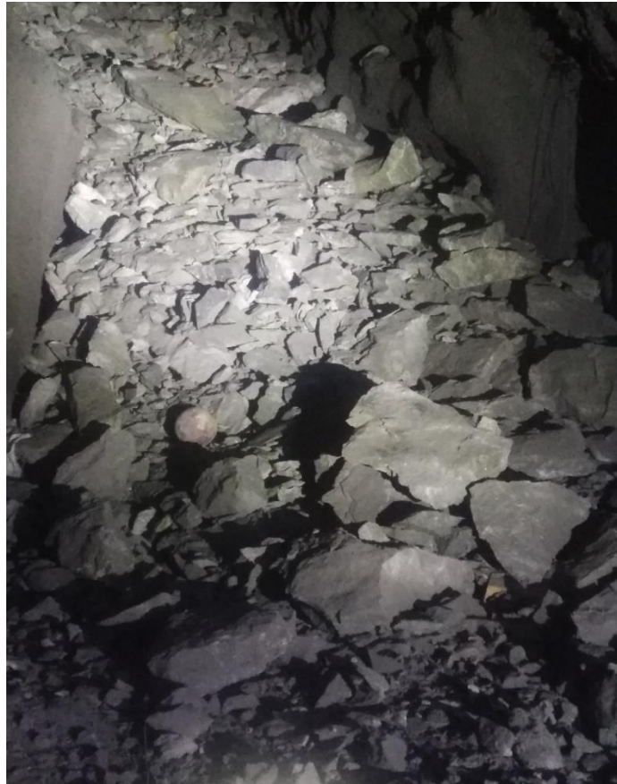
Figura 31. Granulometría post voladura, Tj 9653 – escenario base
