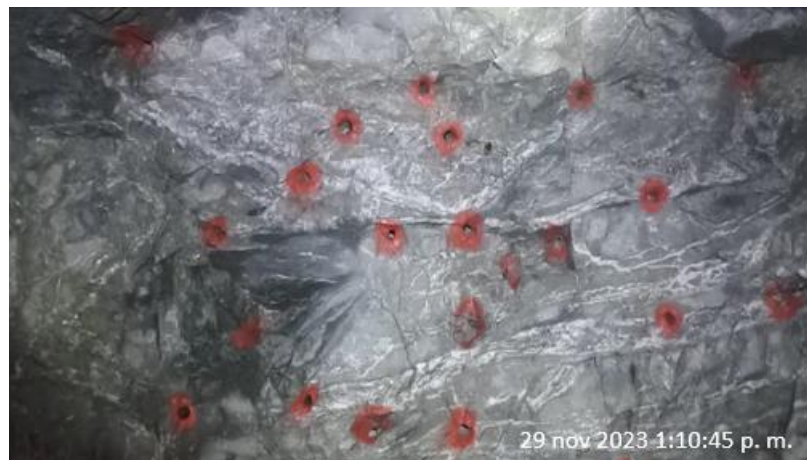
Figura N. 8: Escenario actual-tiro fallado tras el disparo de la Galería 10316
