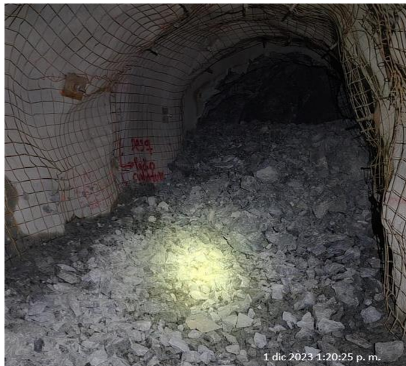
Figura N. 15: Escenario de mejora de la fragmentación de la Galería 10316.
