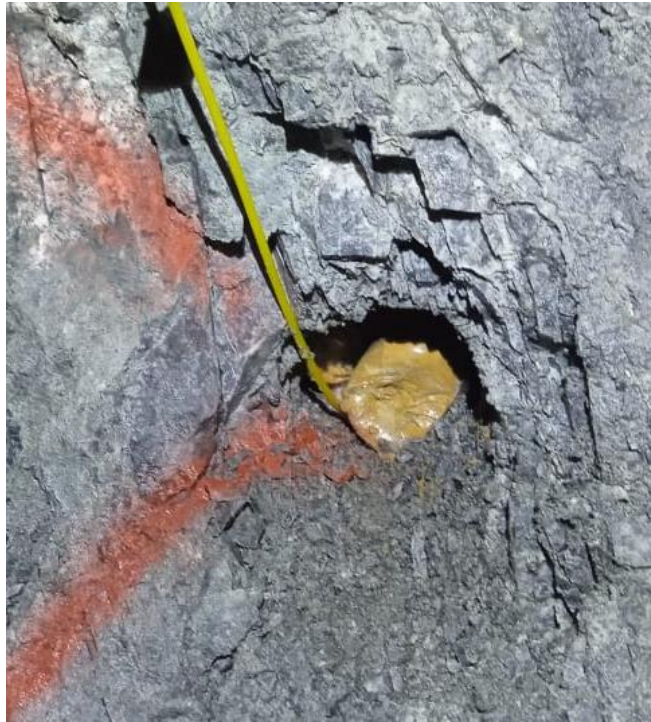
Figura N. 11: Uso de tocos de arcilla en la voladura del frente de la Galería 10316.
