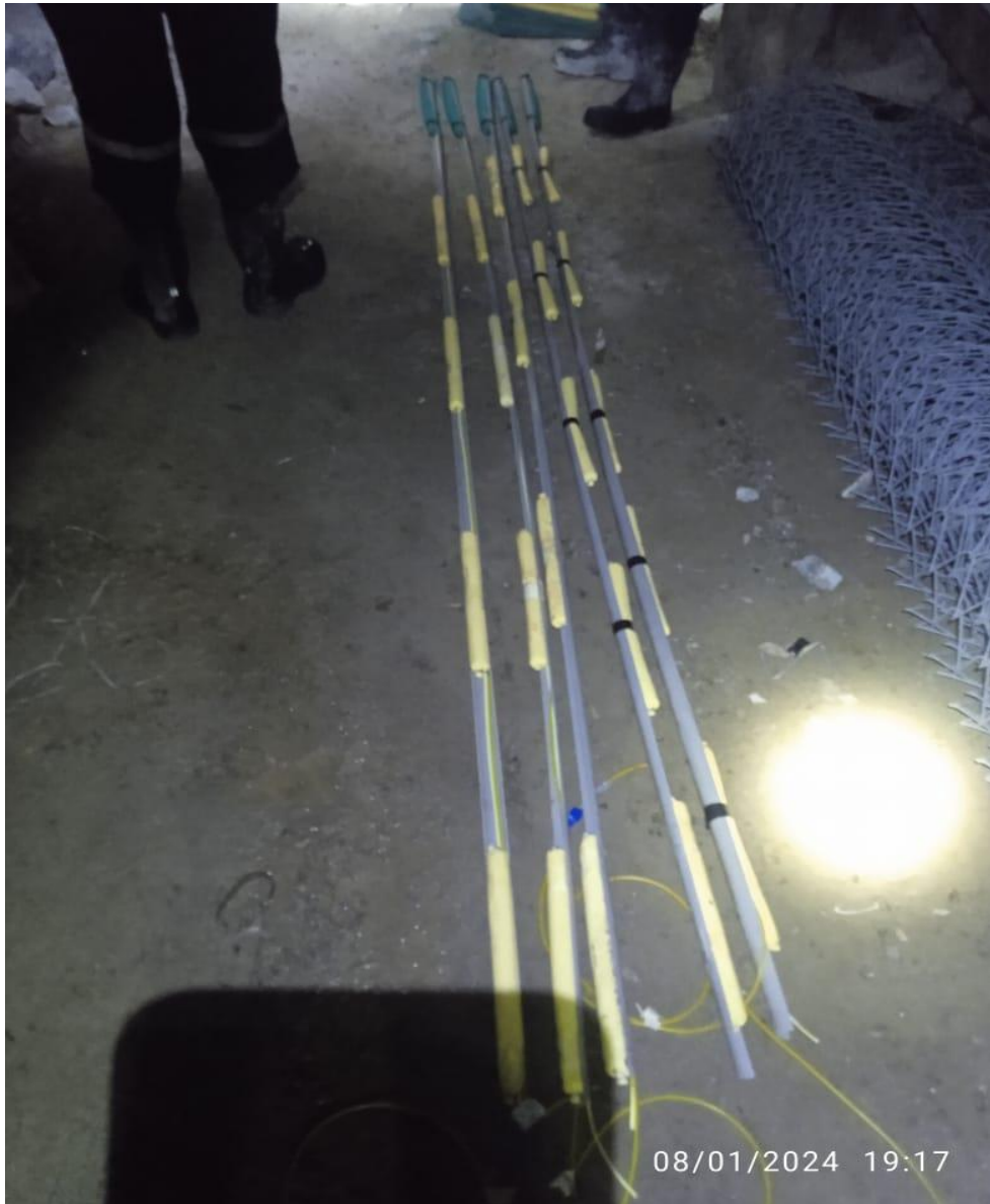
Figura N. 10: Carga desacoplada de la columna explosiva en los taladros de la corona en la Galería 10316.
