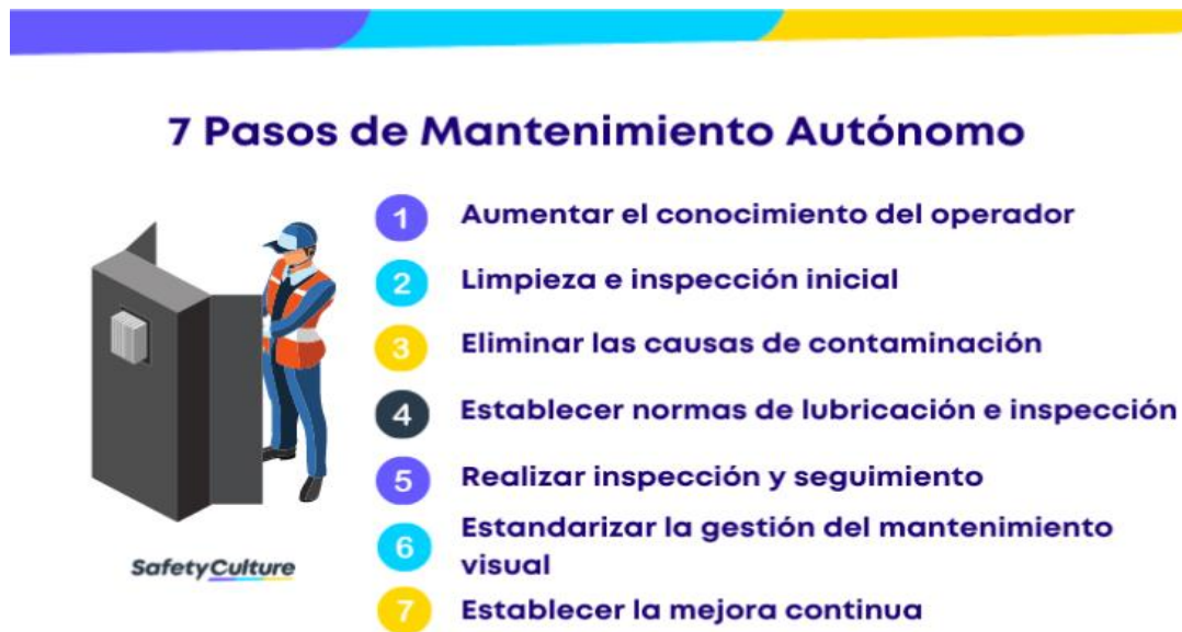
Figura 21. Pasos del mantenimiento autónomo. Tomada de “Mantenimiento autónomo: Beneficios, pasos y herramientas. Safety culture”, de Cultura Seguridad. 2022, https://safetyculture.com/es/temas/mantenimiento-autonomo/ .
