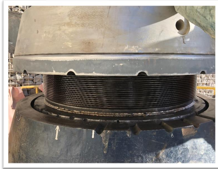
Figura 1. Anillo roscado descendiendo para ajustar el manto. Imagen tomada de campo.
