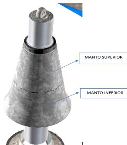
Figura 6. Mantos de una chancadora (2000)
