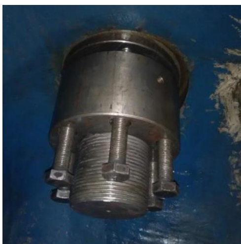
Figura 56. Sistema Superbolt aplicado en la chancadora (Sisa, 2019).
