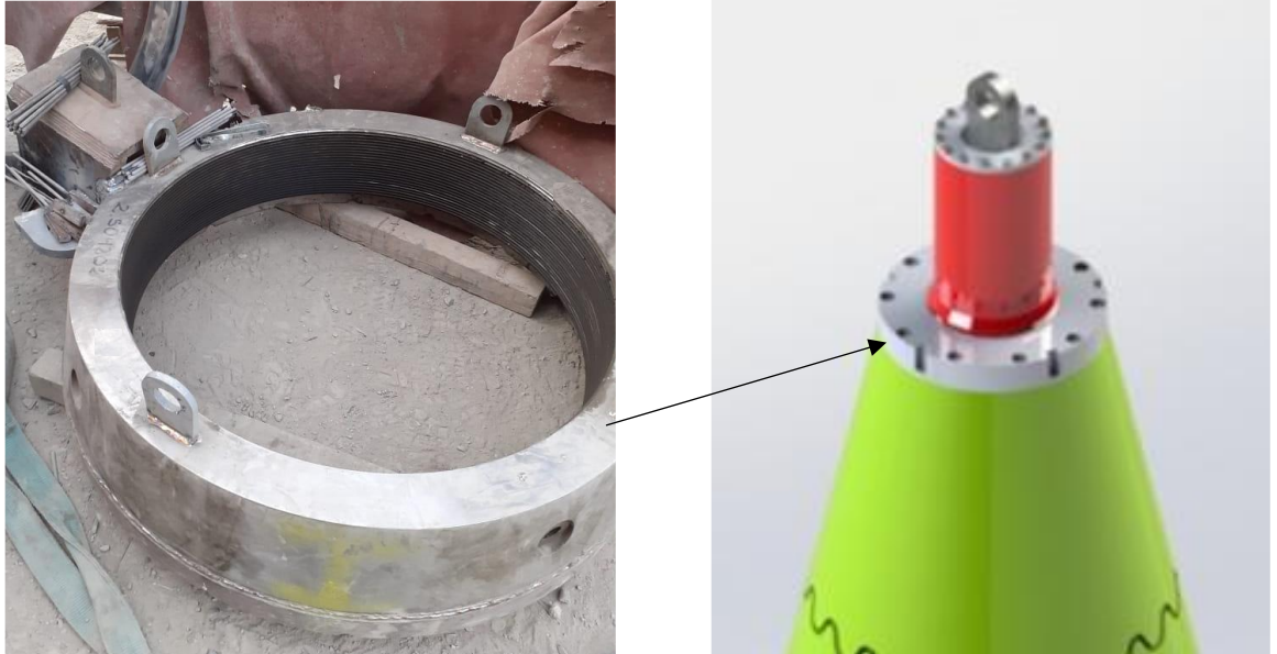
Figura 29. Diagrama en 3D e imagen del sistema de fijación.
