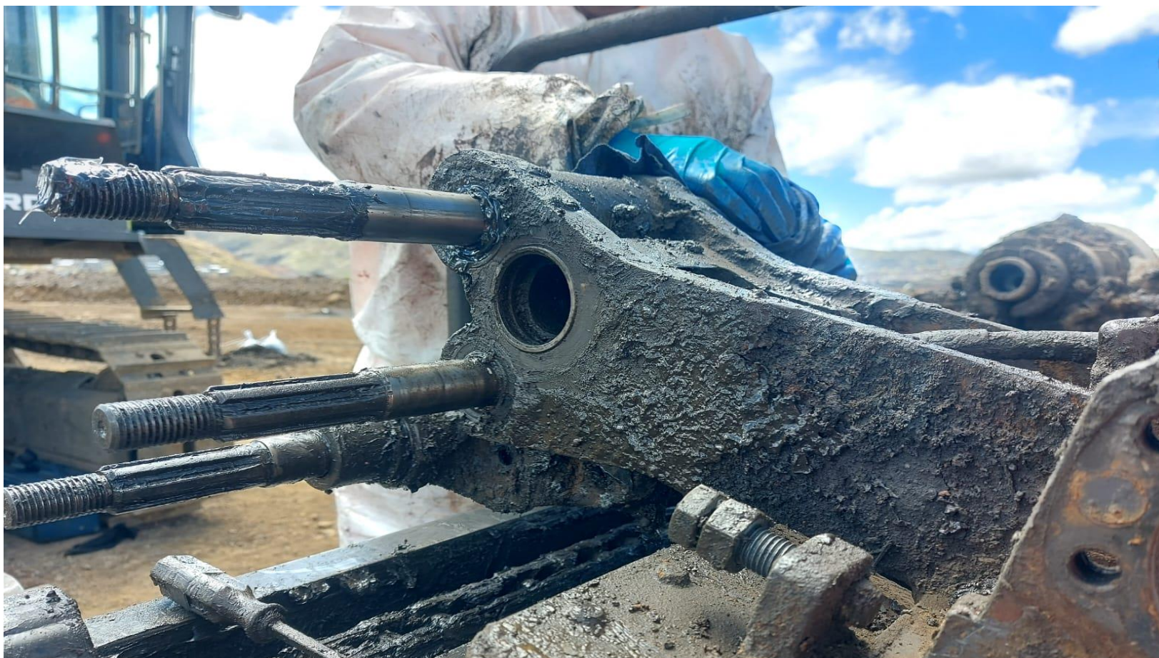
Foto tomada de remplazo de rodillos y rodajes de Tong Ass'y perforadora UG-07 mina Paragsha
