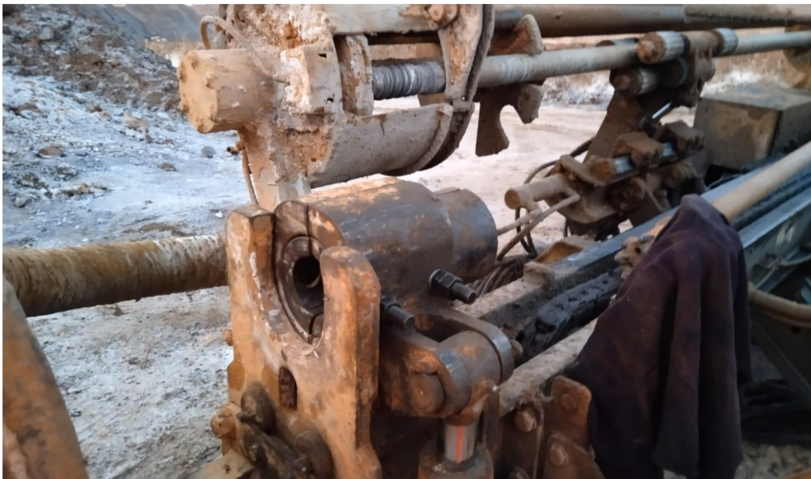
Foto tomada cambio de mordaza y pernos perforadora UG-07 mina Paragsha 10-09-2022
