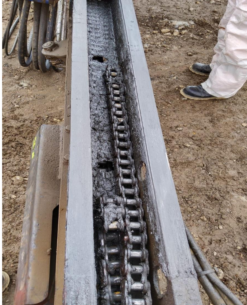
Foto tomada de rotura de cadena de avance del Drifter
