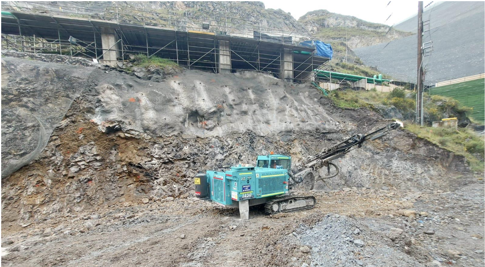
Foto tomada perforadora Everdigm T-450 en operaciones mina Atacocha Cerro de Pasco-Perú 26-05-2021
