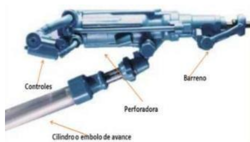
Figura 7. Componentes de las perforadoras Fuente: Extraída de la investigación de Aparco y Solano (28)
