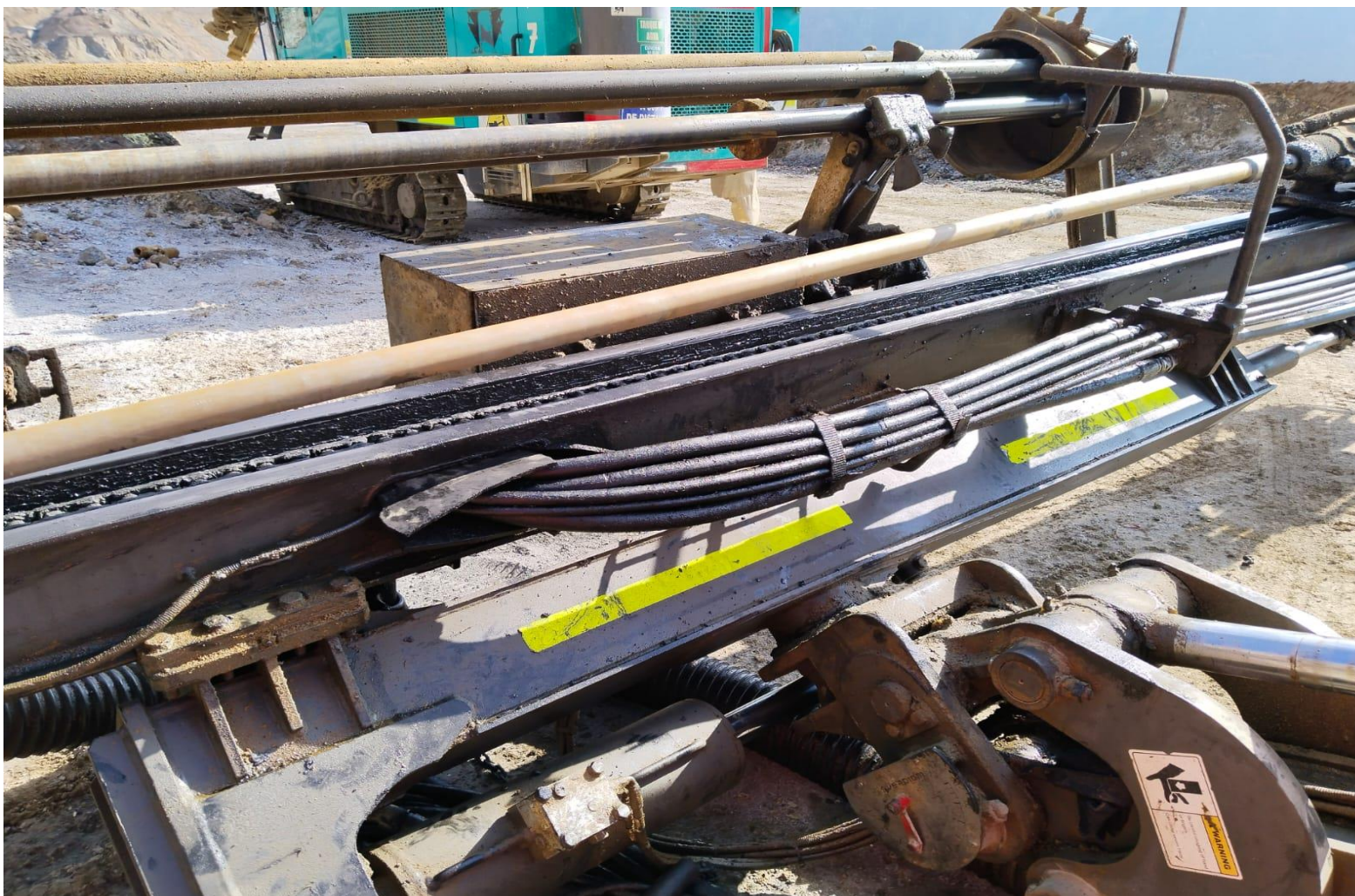
Foto tomada de cambio de mangueras del tercer y segundo tramo perforadora UG – 04 mina Paragsha 10-10-2022
