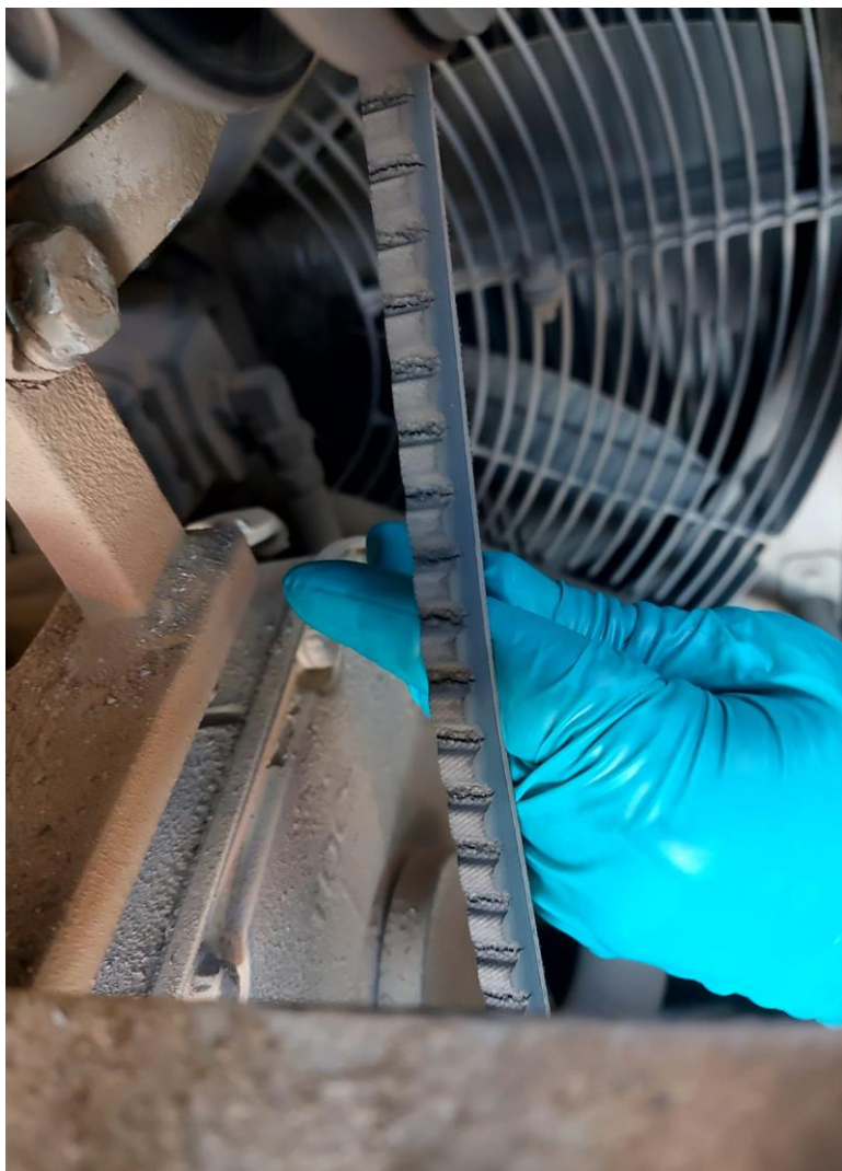
Foto tomada faja cuarteada UG-01 mina Alampara 25-08-2022
