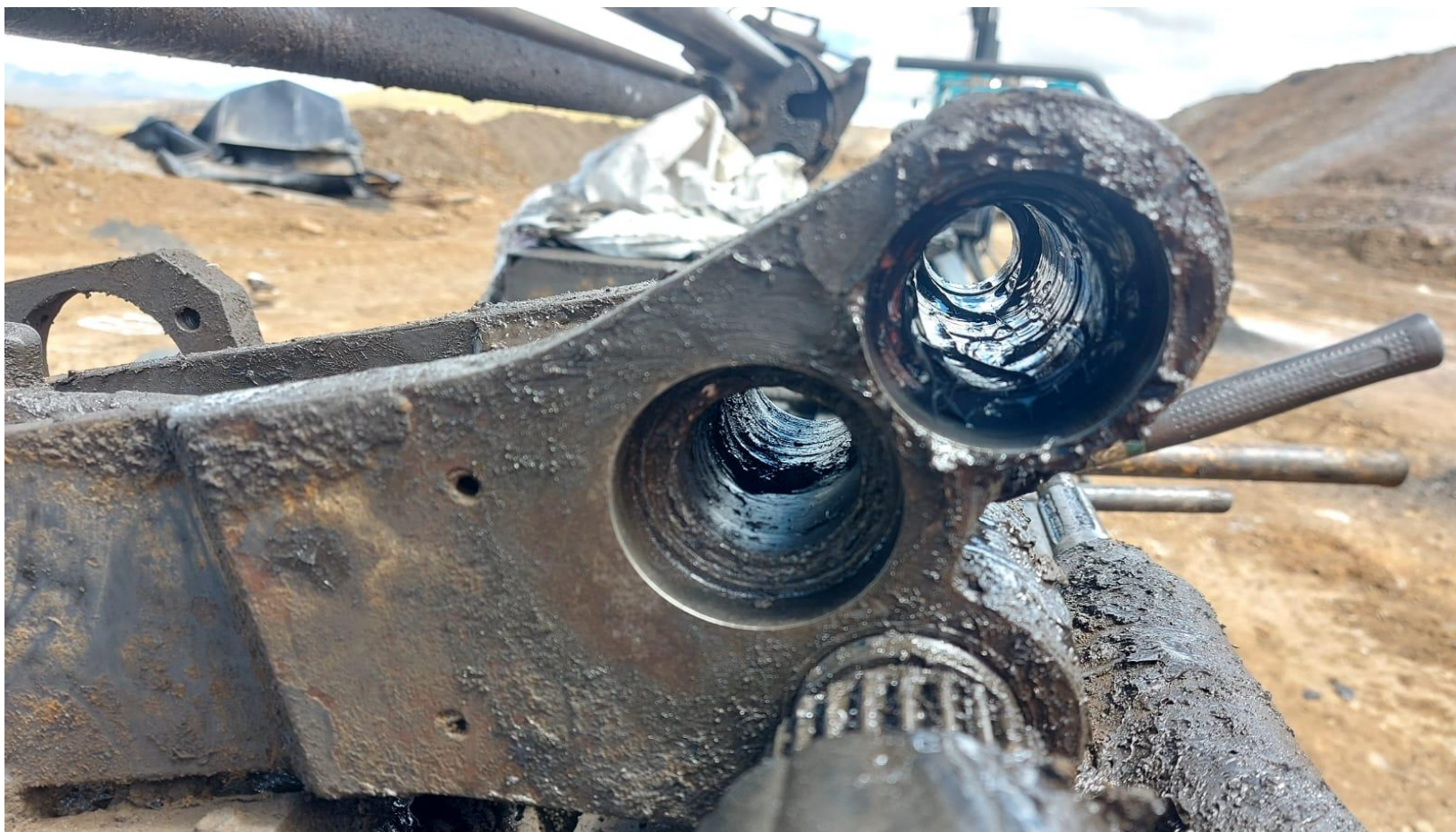
Foto tomada falla en el sistema de perforación, rodamientos de Tong Ass'y y destrozadas perforadora UG-07
