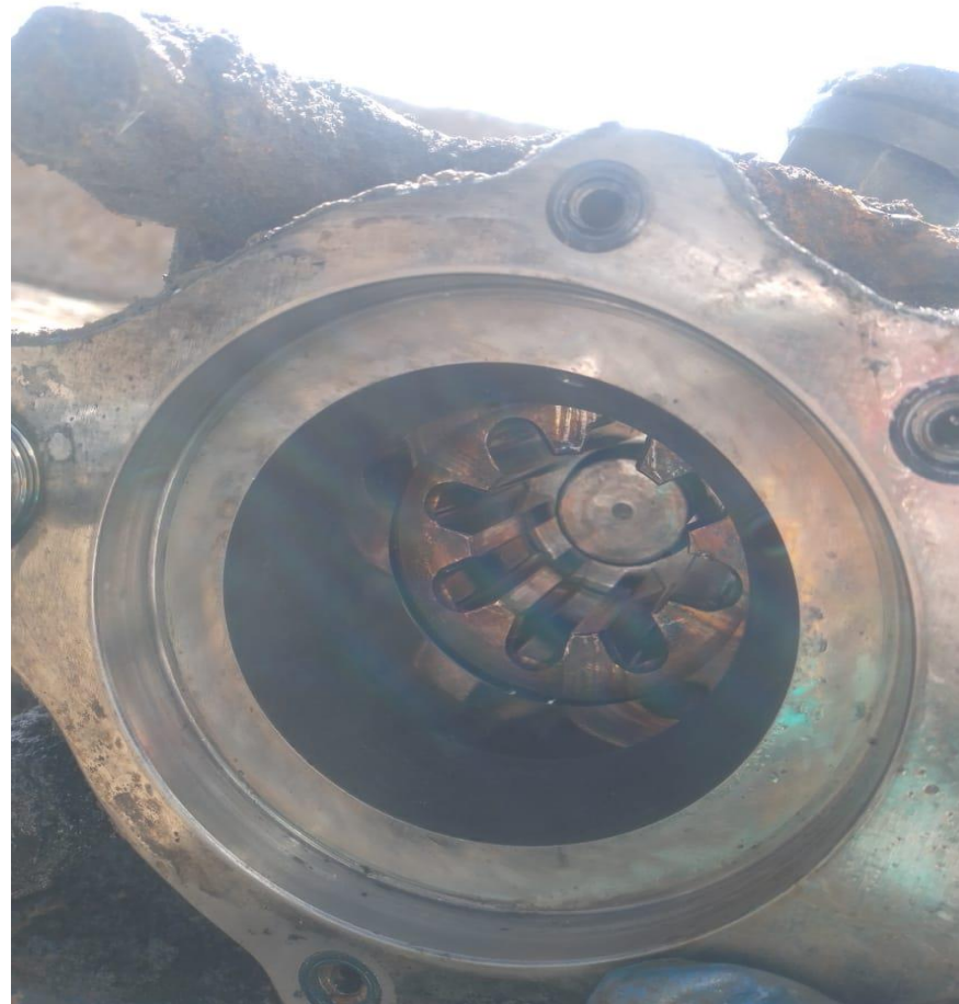
Foto tomada de daños en Driver de rotación del Drifter 28-08-2022
