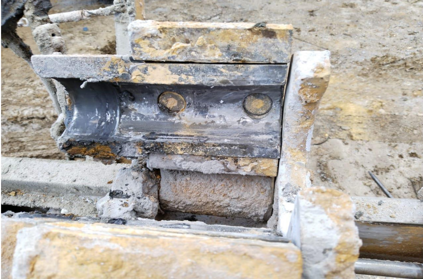
Foto tomada mordaza dañada exceso de desgaste perforadora UG-01 mina Alampara
