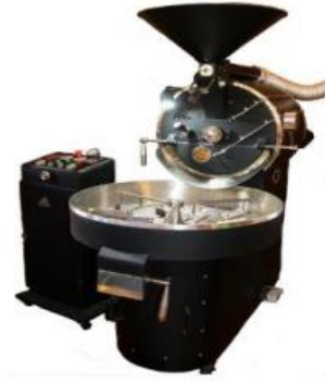
Figura 18. Se muestra una tostadora de cacao semiautomática Tomada de FIMAC (21)
