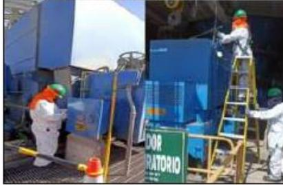
Imagen 6. Inspección, limpieza externa de motor
