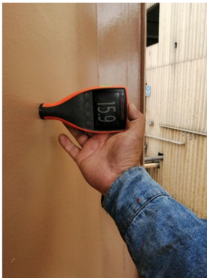
FIGURA 33: Medición de espesor de tanque.
