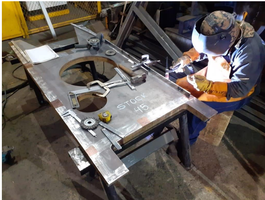
Figura 24. Uso correcto de EPP (armado y soldeo de caja de rotación (equipo: perforadora Bucyrus 49RIII, 49HR) – Budge S. A. C.
