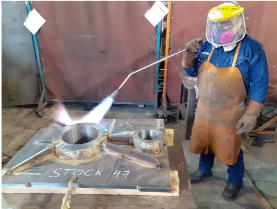
Figura 25. Pre calentamiento de material – componente carro de perforación – Budge S. A. C.
