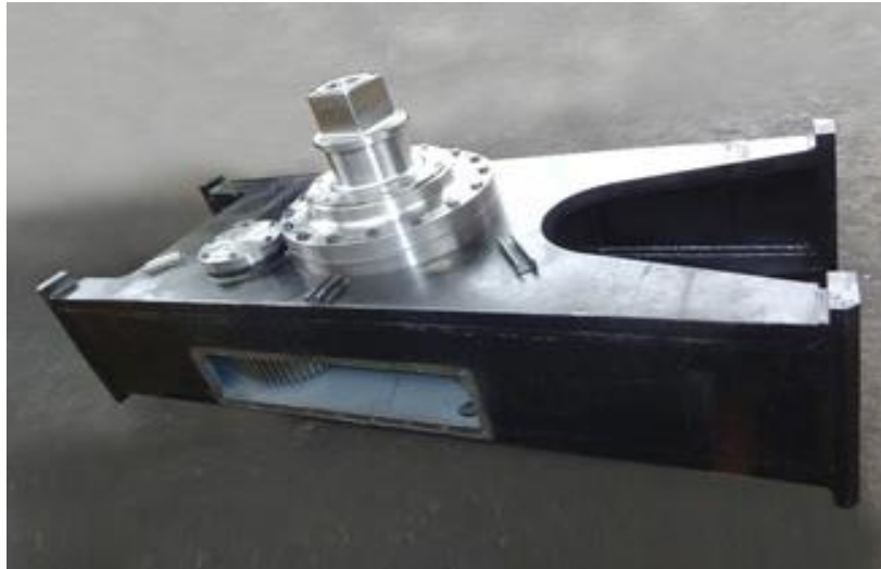
Figura 3. Caja de rotación (equipo: perforadora Bucyrus 49RIII, 49HR) Tomada de Budge S. A. C. (1)
