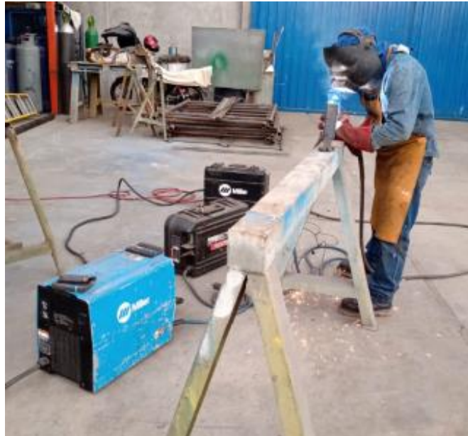
Figura 19. Proceso de soldadura (FCAW)-Budge S. A. C.
