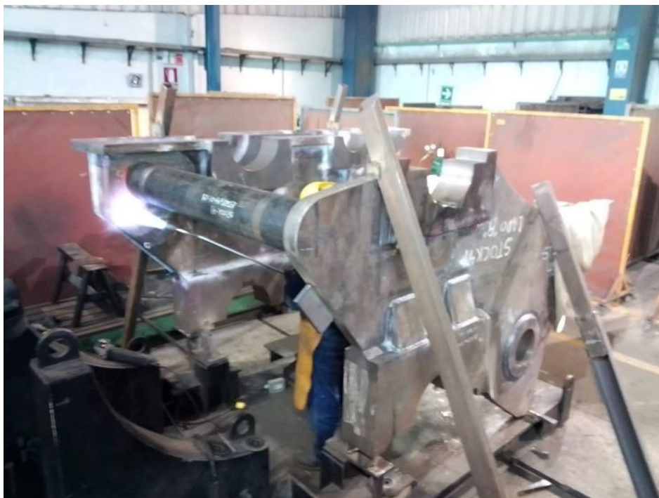
Figura 22. Armado y soldeo de transmisión crowd - equipo: pala Bucyrus 495BI, 495BII, 495HR, 7495HR
