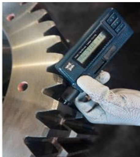
Figura 7. Control de calidad - medición y calibración de componentes (engranajes) Tomada de Budge S. A. C. (1)
