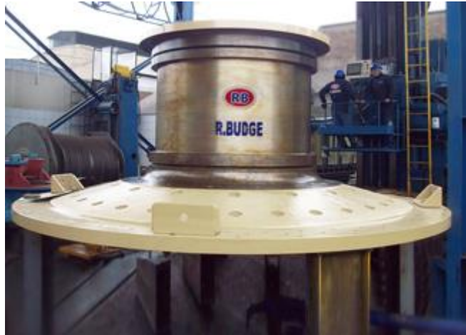
Figura 5. Reparación de tapa de molino - equipo: tapa de molino Tomada de Budge S. A. C. (1)
