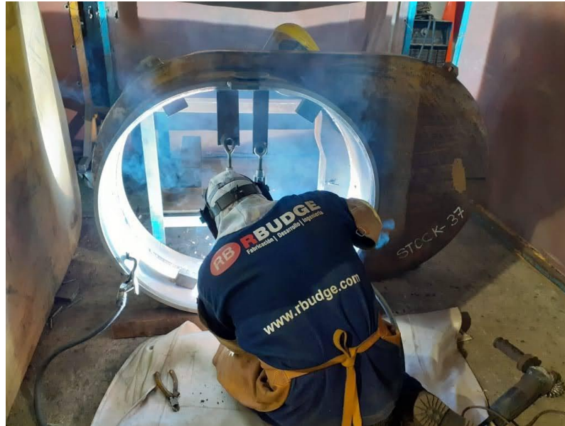
Figura 28. Exposición a humos metálicos – proceso de soldeo transmisión swing Equipo: pala Bucyrus 495BI, 495BII, 495HR, 7495HR
