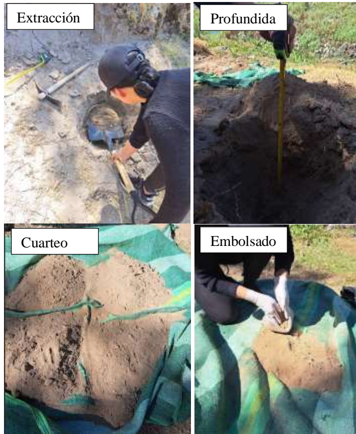
Figura 5. Extracción de la muestra del suelo
