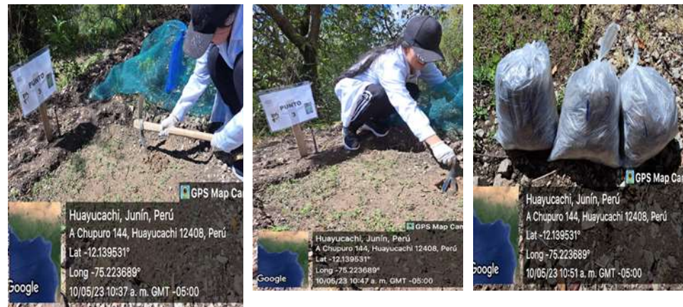
Figura 11. Obtención de la prueba del suelo en la ubicación 2, mes 1
