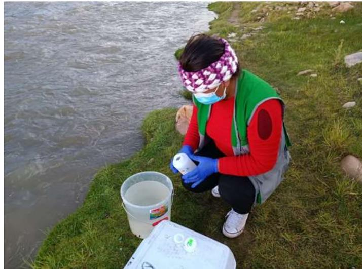
*Nota:* La imagen muestra la toma de muestra 2 del río Challhuahuacho/Molino Pampa/Apurímac con coordenadas 797596.168E; 8438192.882N 18L. observando agua de tipo superficial natural.
