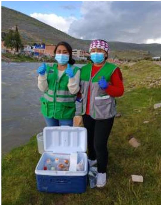
*Nota:* La imagen muestra la toma de muestra 2 para análisis DBO del río Challhuahuacho/Molino Pampa/Apurímac con coordenadas 797596.168E; 8438192.882N 18L. observando agua de tipo superficial natural.
