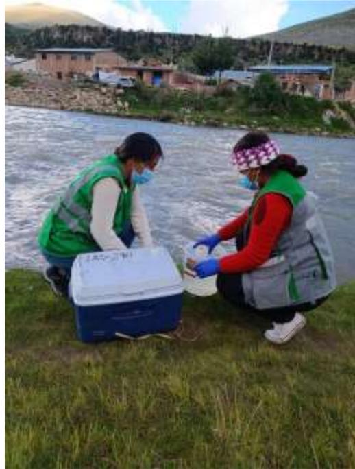
*Nota:* La imagen muestra la toma de muestra 2 para análisis DBO del río Challhuahuacho/Molino Pampa/Apurímac con coordenadas 797596.168E; 8438192.882N 18L. observando agua de tipo superficial natural.
