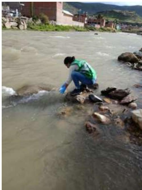
*Nota:* La imagen muestra la toma de muestra 1 del río Challhuahuacho/Molino Pampa/Apurímac con coordenadas 797206.49E; 8435715.467N 18L. observando agua de tipo residual industrial.
