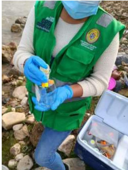
*Nota:* La imagen muestra la toma de muestra 1 para análisis DBO del río Challhuahuacho/Molino Pampa/Apurímac con coordenadas 797206.49E; 8435715.467N 18L. observando agua de tipo residual industrial.
