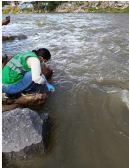
*Nota:* La imagen muestra la toma de muestra 1 para análisis DBO del río Challhuahuacho/Molino Pampa/Apurímac con coordenadas 797206.49E; 8435715.467N 18L. observando agua de tipo residual industrial.
