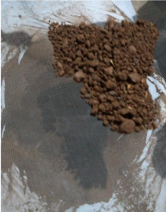
Fotografía 4.3 Se tamizo con la malla N° 2 mm, la muestra de suelo contaminado.
