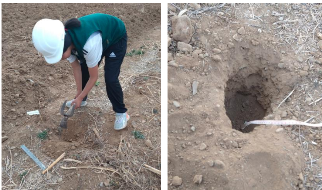
Fotografía 4.2 Calicata para muestra de suelo a analizar - Inicial
