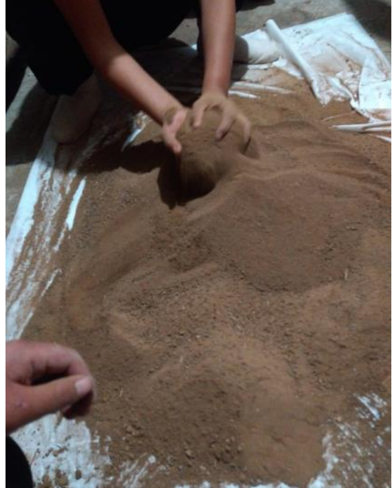
Fotografía 4.4 Una vez tamizado los 64 kg, se procedió a realizar el método del cuarteo.
