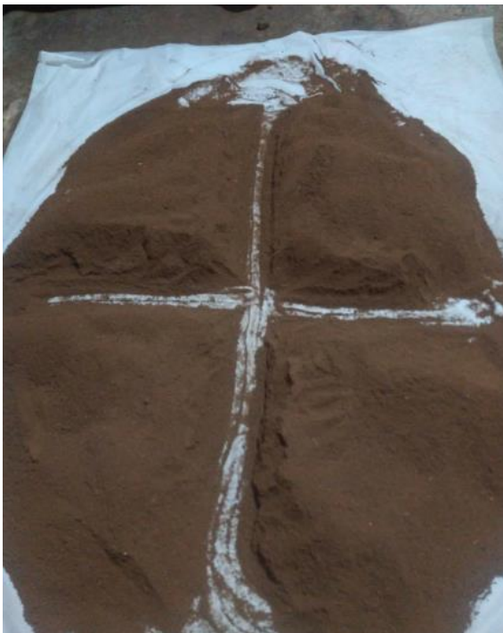
Fotografía 4.5 Se procede a realizar el método del cuarteo.
