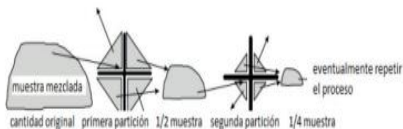
Figura 2. Método del cuarteo. Tomada de la Guía para el muestreo de suelos
