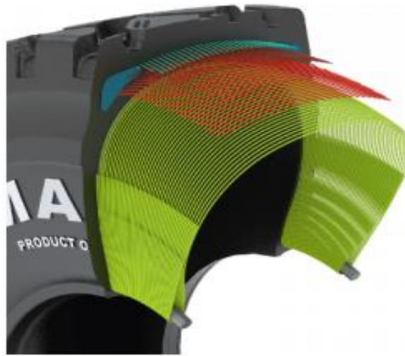
Figura 3. Neumático radial. Tomado de “Diseño y desarrollo de nuevo sistema de llantas de materiales compuestos para vehículo de bajo consumo” por S. Mollá, 2020.
