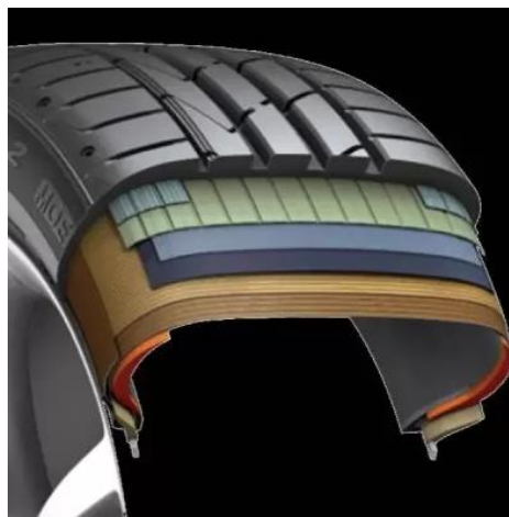
Figura 4. Neumático autoportante o runflat . Tomado de “Diseño y desarrollo de nuevo sistema de llantas de materiales compuestos para vehículo de bajo consumo” por S. Mollá, 2020.
