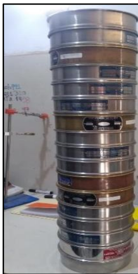
Figura 31. Tamizado de mallas de 3" hasta el N° 200 para realizar la granulometría de la muestra.
