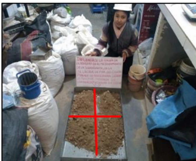
Figura 30. División de la muestra natural en cuatro partes para realizar los ensayos.
