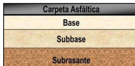
Figura 17. Diseño de la estructura del pavimento.
