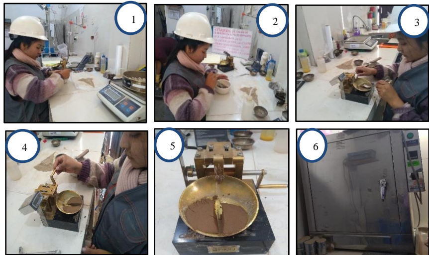
Figura 33. Procedimiento del límite líquido de la muestra.
