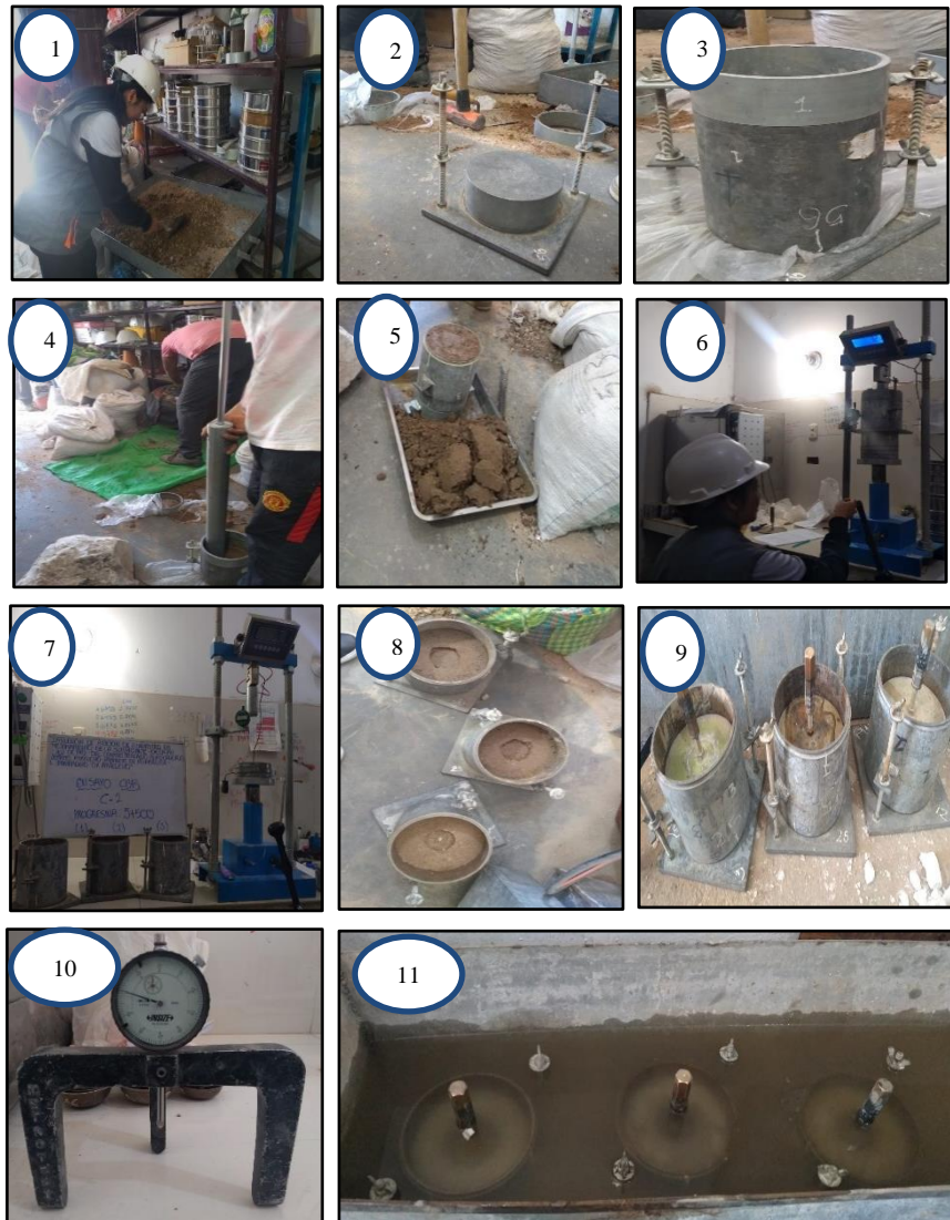
Figura 36. Procedimiento del ensayo C.B.R. de la calicata C-1, C-2 y C-3.
