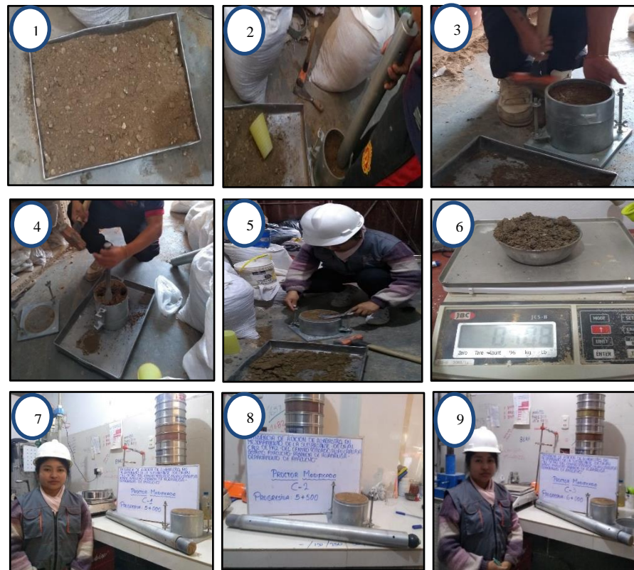
Figura 35. Procedimiento del ensayo Proctor modificado de la calicata C-1, C-2 y C-3.
