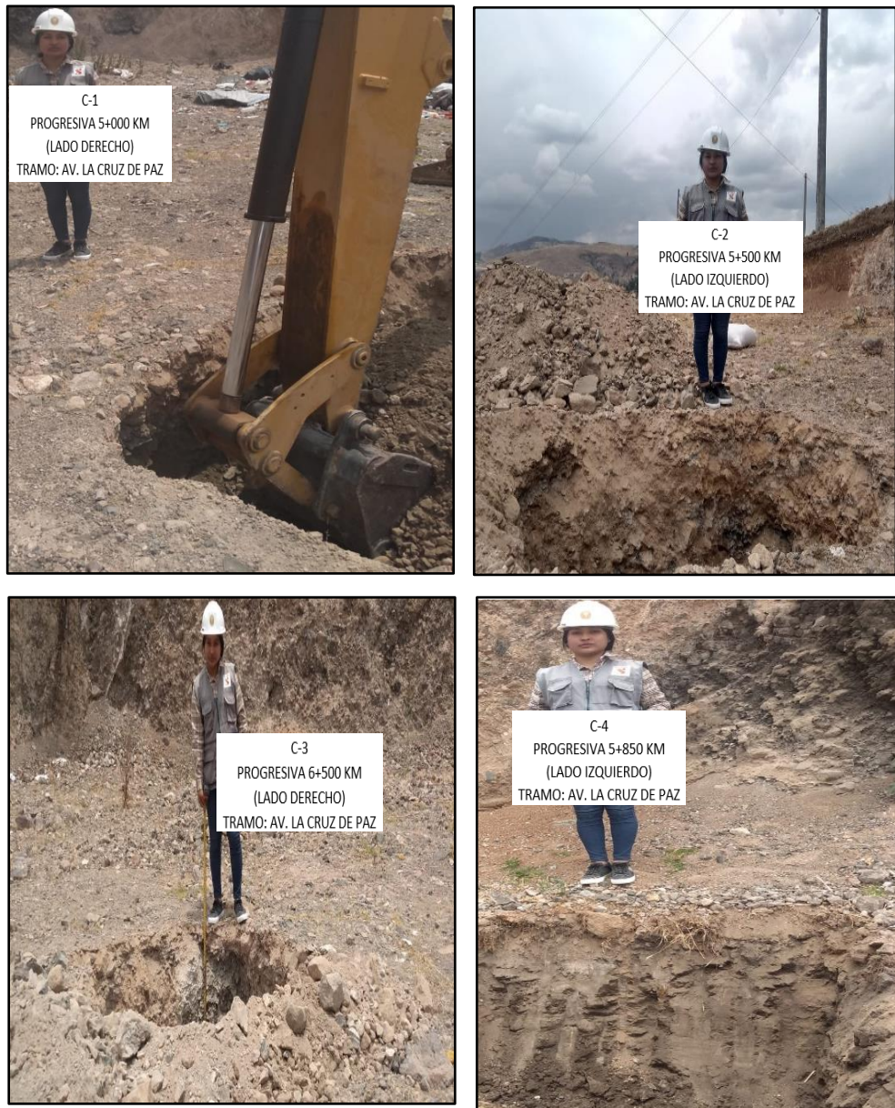
Figura 29. Extracción de muestras de las calicatas C-1, C-2, C3 y C-4 (muestra piloto).
