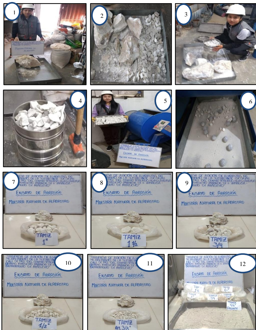
Figura 37. Procedimiento del ensayo de abrasión para el alabastro (piedra de Huamanga).
