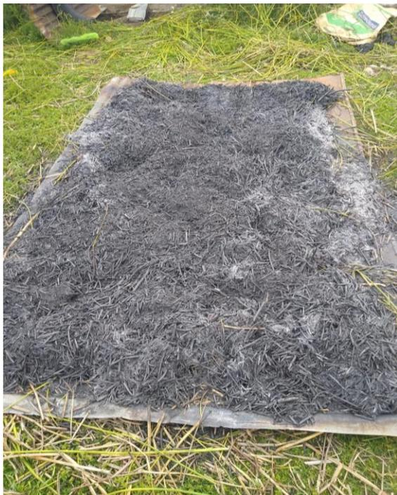
*Fotografía 3. Cenizas de las totoras recicladas pre calcinada*
