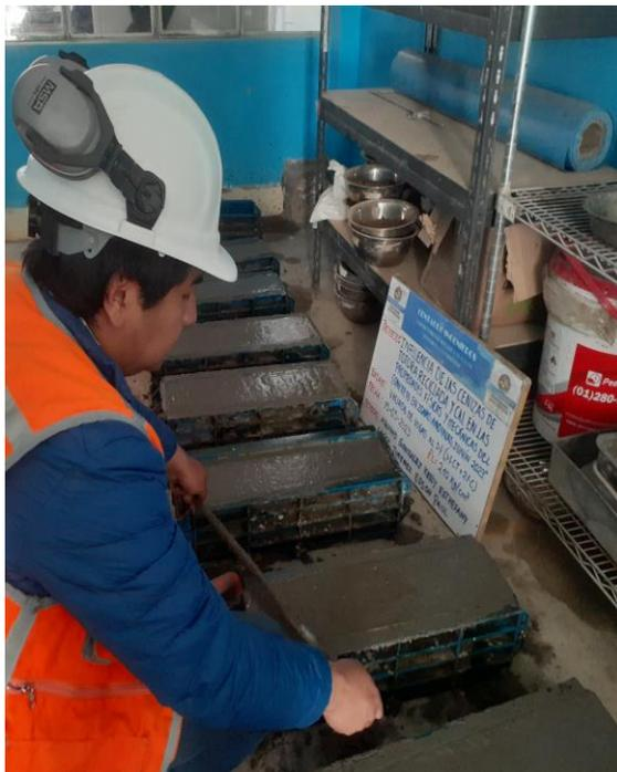
Fotografía 11. Vaciado y enrasado de vigas.
