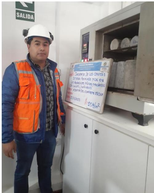
Fotografía 19. Secado de los especímenes para el ensayo de absorción.
