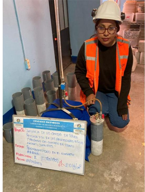
Fotografía 18. Ensayo de Permeabilidad de los especímenes.
