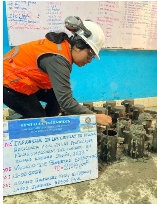
Fotografía 10. Vaciado de probetas cilíndricas.
