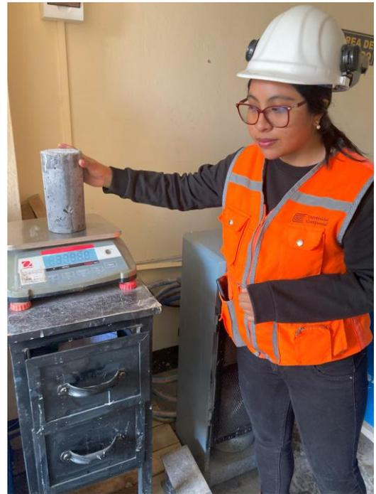
Fotografía 14. Obtención de las características en estado endurecido de los especímenes.
