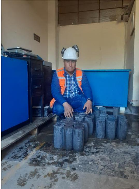
Fotografía 17. Especímenes para el ensayo de permeabilidad y absorción.
