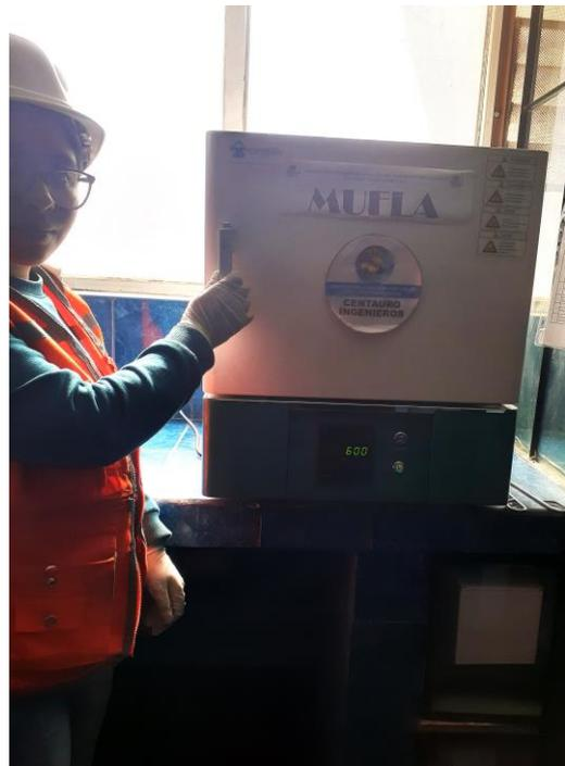
*Fotografía 4. Calcinación de las cenizas de totora reciclada en Mufla de laboratorio a 600 °C.*
