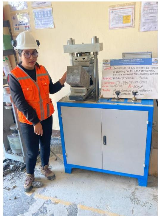
Fotografía 16. Resistencia a la flexión de las vigas.
