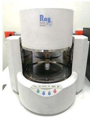
FIGURA N°2. Espectrómetro de fluorescencia de rayos x de energía dispersiva (SHIMADZU, EDX-800HS).
