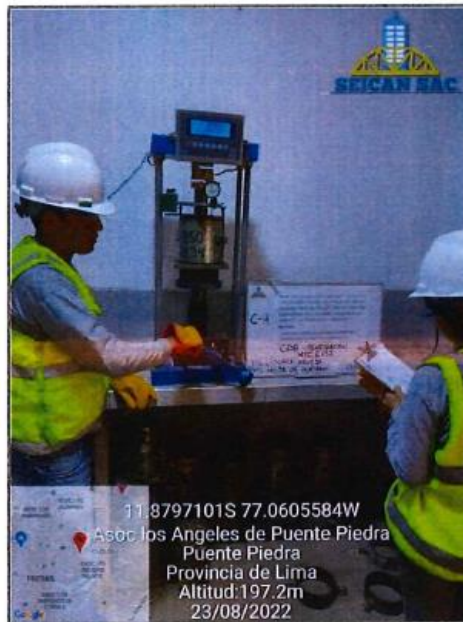
Fotografía N. 124: PENETRACION con 5% plátano y 7% arveja
