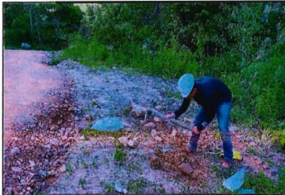
Fotografía N. 03: Extracción de calicata 01
