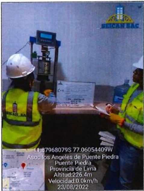
Fotografía N. 126: PENETRACION con 5% plátano y 12% arveja
