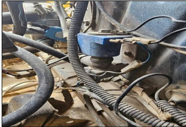
*Figura 11. Electroválvula de gasolina ubicada en el motor*
