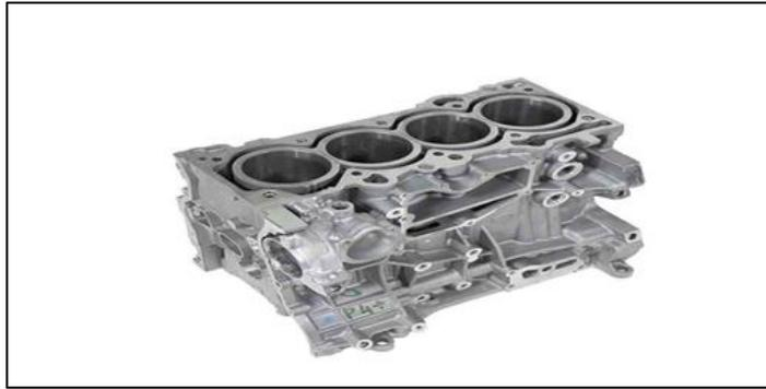
**Figura 1. Monoblock del motor de combustión interna**
