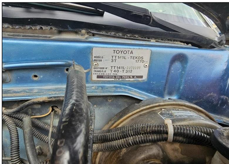
**Figura 21. Placa de identificación del vehículo Toyota 3T**
