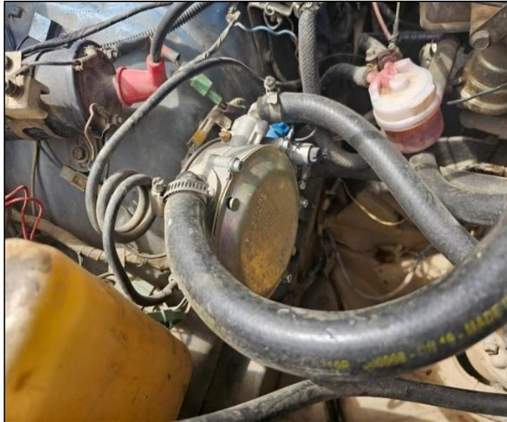
*Figura 9. Reductor de GLP, ubicado en el motor Toyota 3T*
