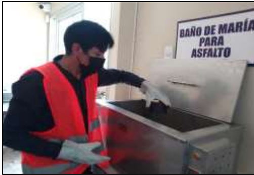
Acondicionamiento de las muestras en baño maría a 60°C por 30 min para el ensayo con la prensa Marshall
