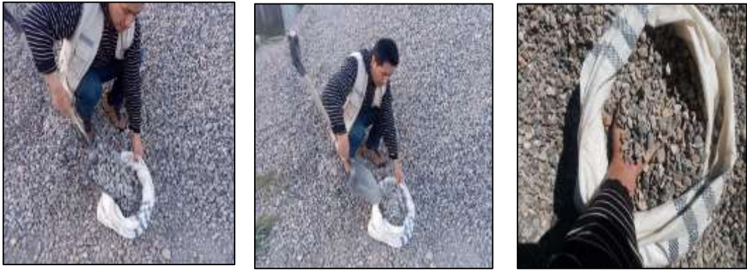
Figura 25. Extracción de piedra 3/4
