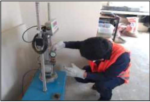
Toma de datos y resultado del ensayo con la prensa de Marshall
