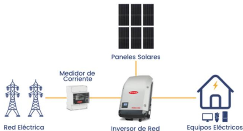
Figura 10: Dimensionado De Una Instalación Solar Fotovoltaica
